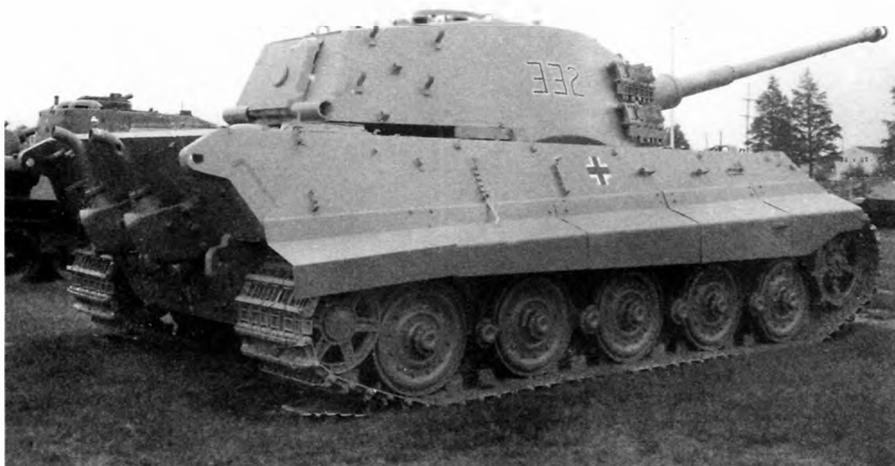
«Королевский тигр» в экспозиции военного музея на Абердинском полигоне. На фотографиях видно, что вместо срезанных листов брони приварены листы простой листовой стали. Снимки сделаны в конце 1980-х годов
