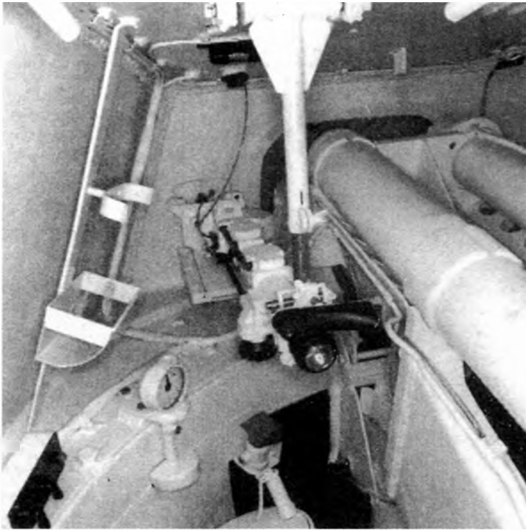
Интерьер башни. Вид на телескопический монокулярный прицел TZF 9d
