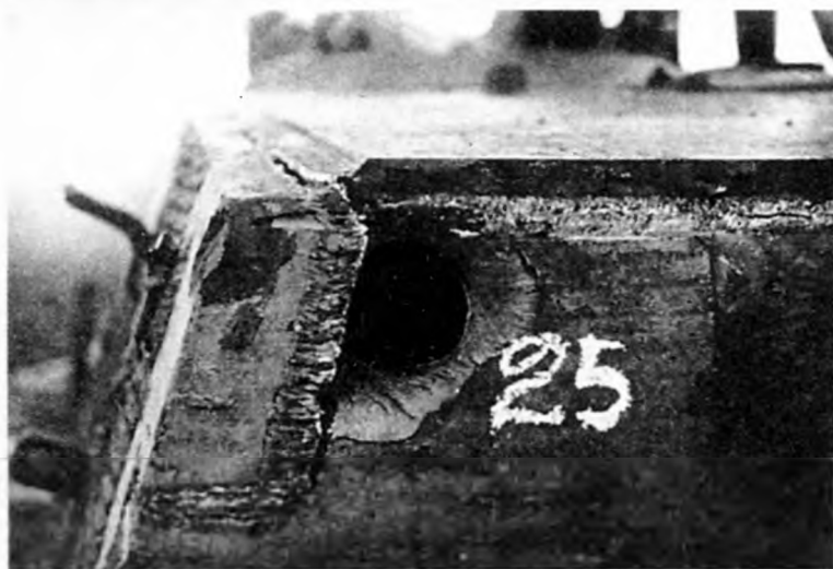
Лобовая и кормовая части башни танка № 102 после испытаний обстрелом. Пробойны 25 сделаны с дистанции 400 м 88-мм снарядом, прошедшим навывлет
