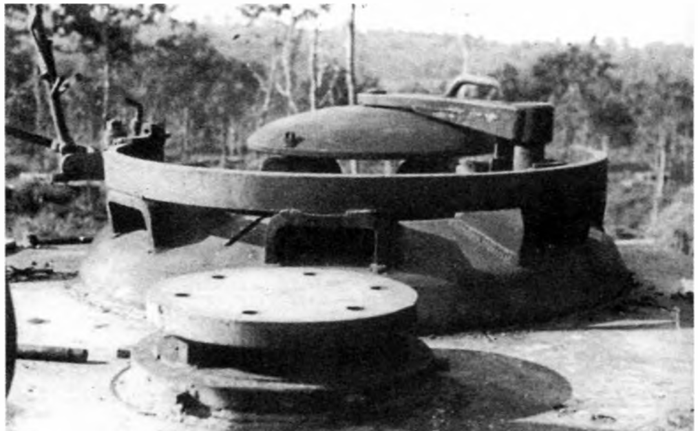
Броневой колпак вентилятора и командирская башенка танка «Королевский тигр»
