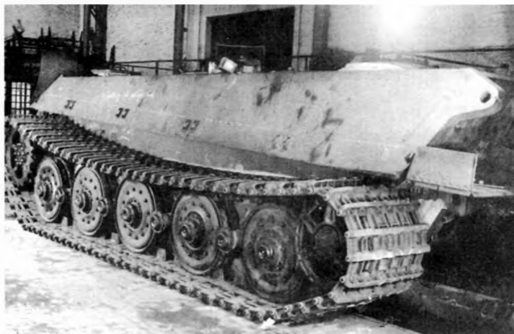
Корпус и ходовая часть танка «Королевский тигр»
