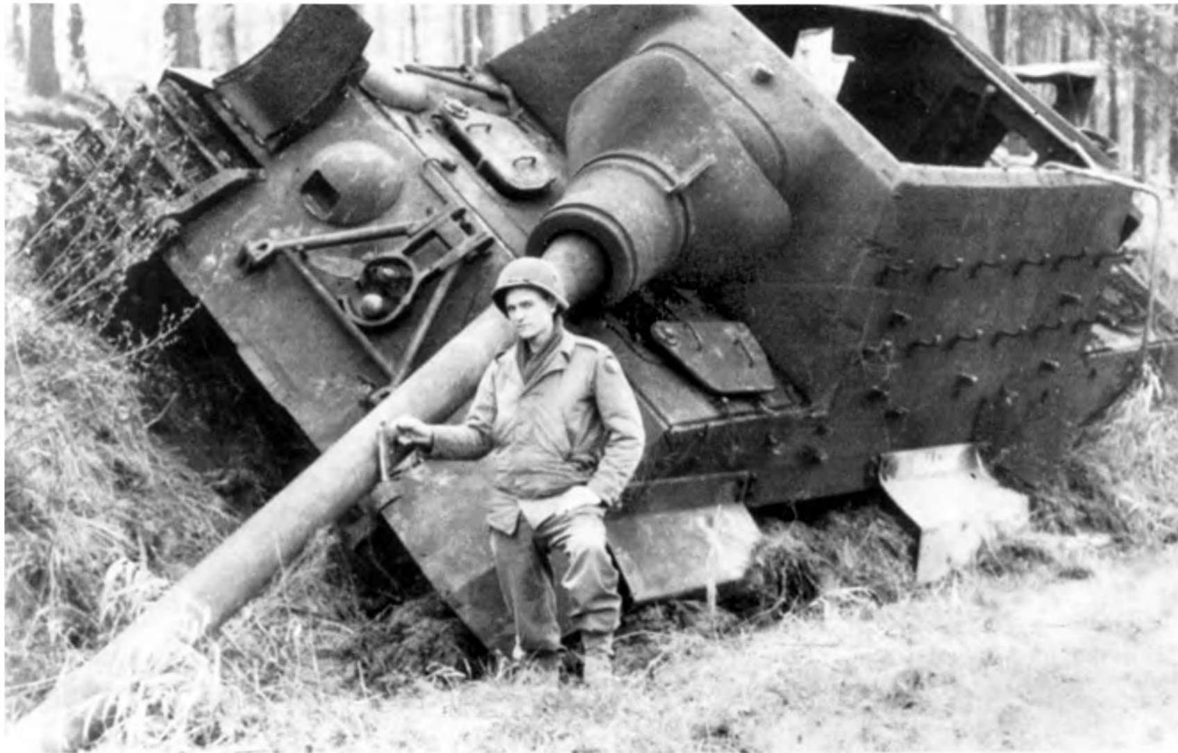
Американский солдат рядом с уничтоженным САУ «Ягдтигр». 1945 год. Судя по всему, боекомплект 128-мм выстрелов детонировал достаточно часто. В результате вышибало вверх крышу рубки, крепившуюся болтами
