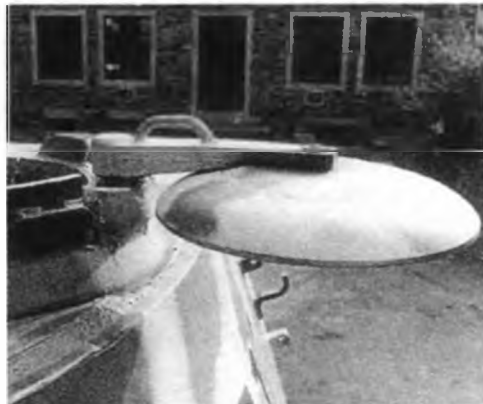
При открывании крышка командирского люка приподнималась и отодвигалась в сторону
