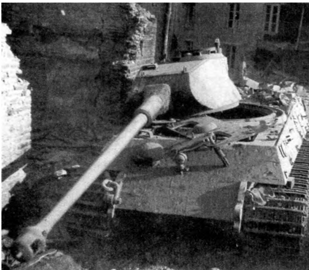
Еще один «Королевский тигр» из 503-го тяжелого танкового батальона. Эта машина уничтожена взрывом боекомплекта. Франция, 1944 год
