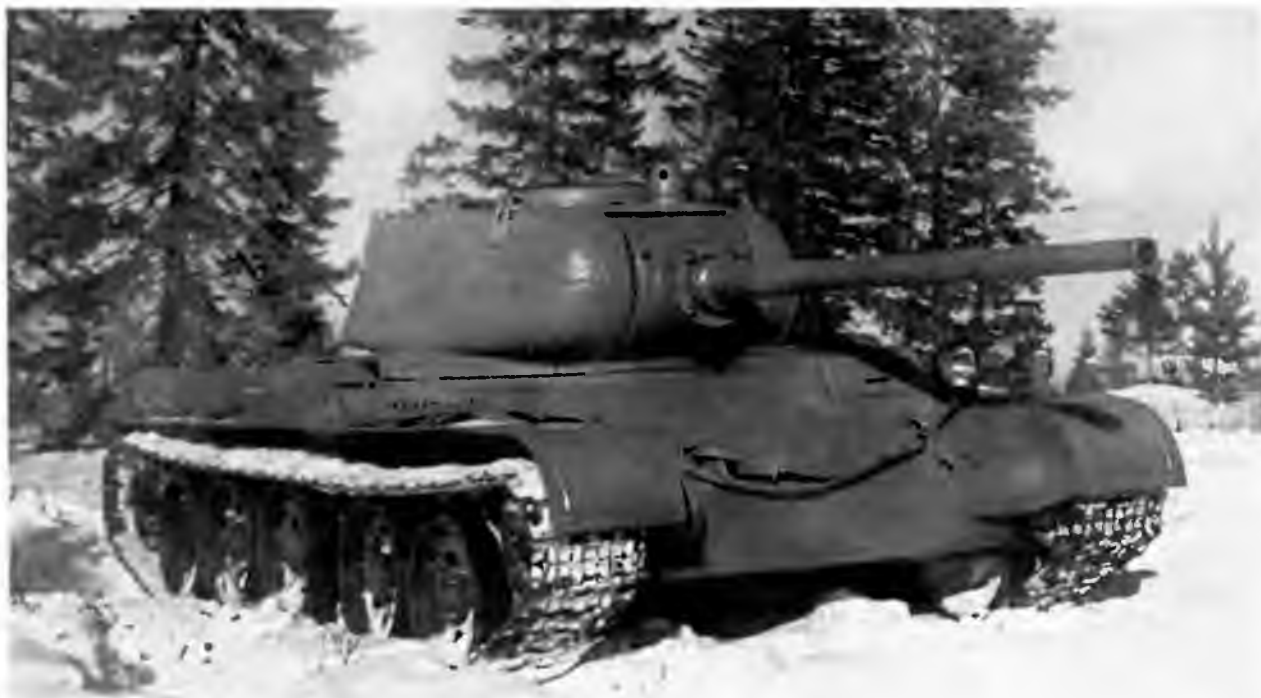
Опытный образец №1 танка Т-44 с 85-мм пушкой Д-5Т. Февраль 1944 года
