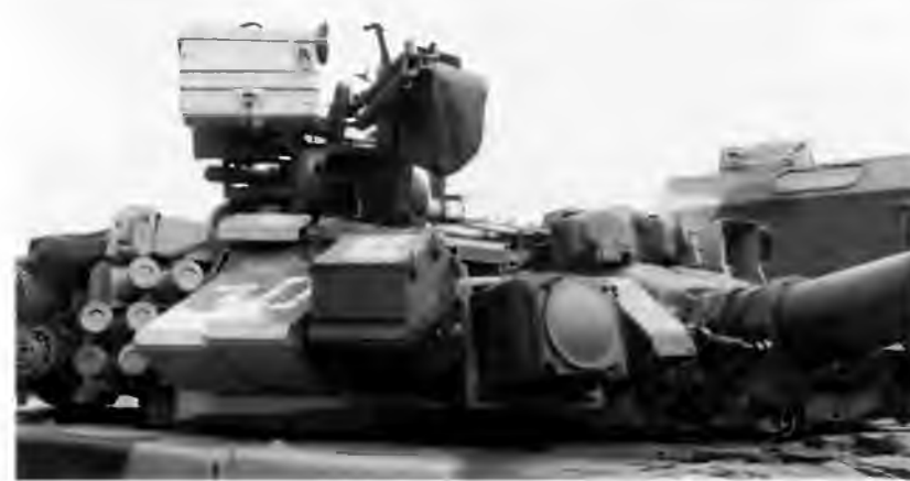
Башня Т-90 крупным планом. Над стволом пушки установлены приемные головки обнаружения лазерного излучения, а справа от пушки — правый осветитель системы оптико-электронного подавления «Штора-1»
