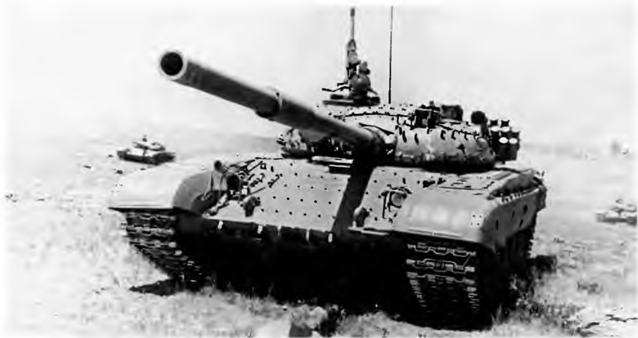
Танк Т-72Б-1 на тактических занятиях. На машине установлены бонки для крепления блоков динамической защиты, но сами блоки не установлены. 1988 год
