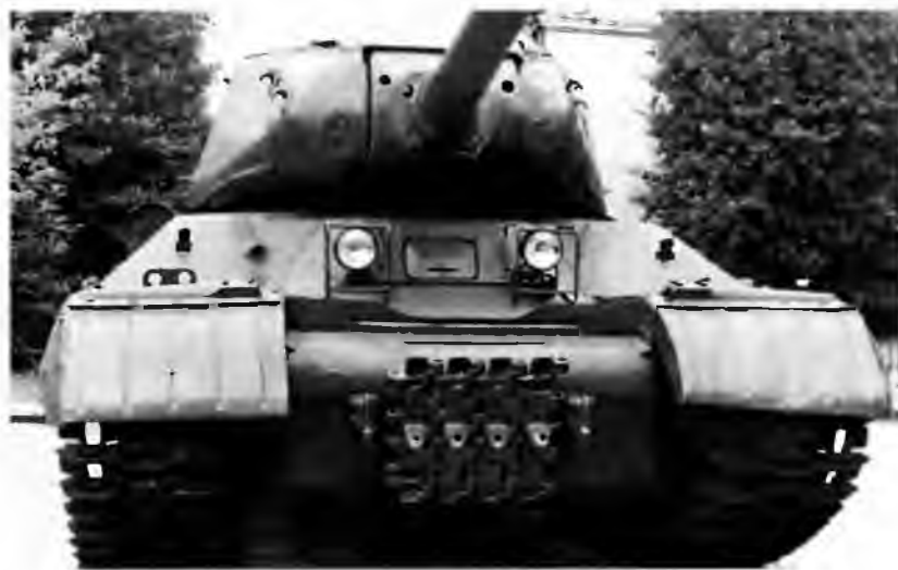
ИС-2 ранних выпусков 1944 года с «ломаным носом» и узкой амбразурой 122-мм пушки. Эта машина, модернизированная до уровня ИС-2М, находится в Музее Великой Отечественной войны в Минске
