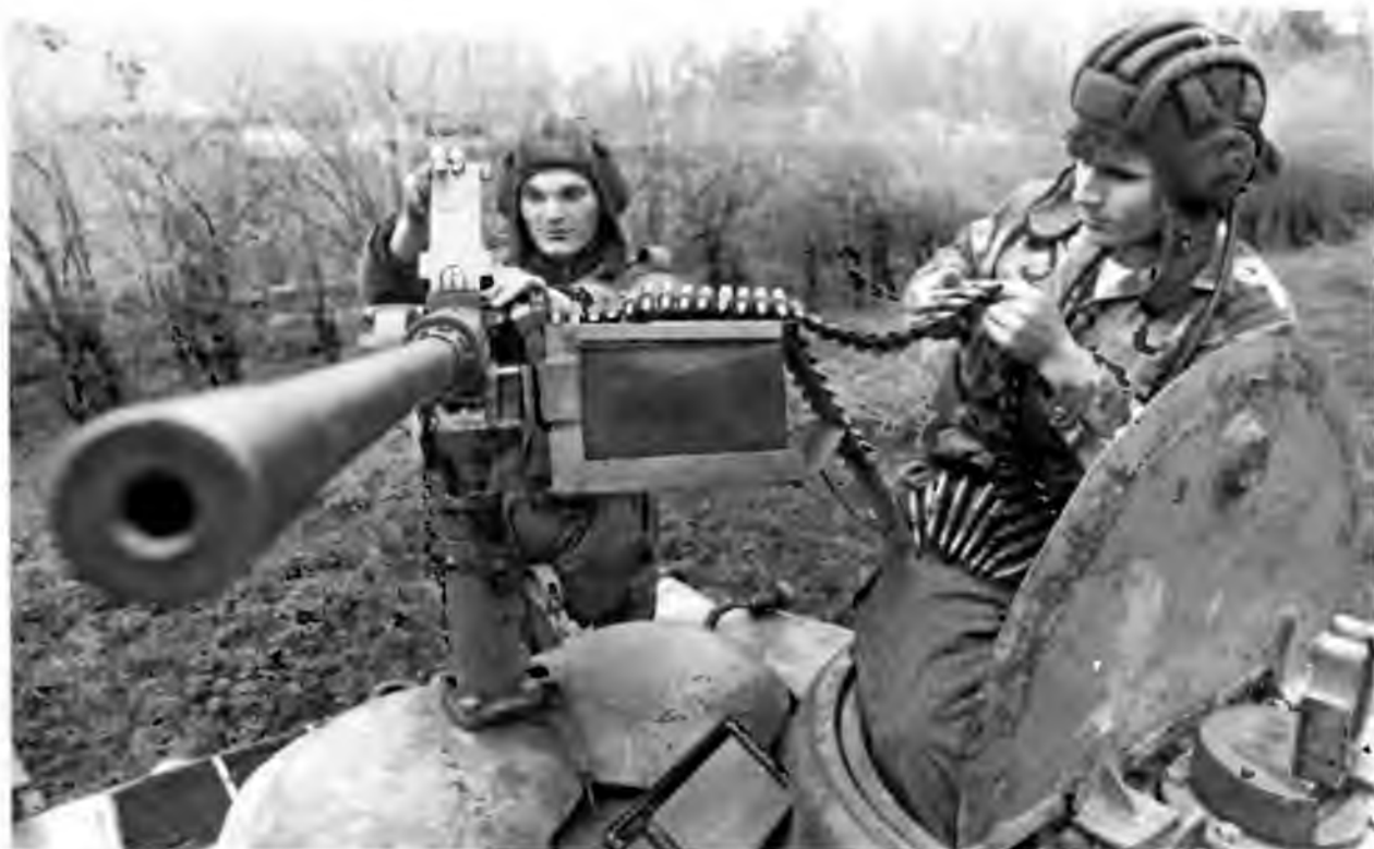
Характерной особенностью югославских «тридцатьчетверок» был крупнокалиберный зенитный пулемет «Браунинг» М2 американского производства, смонтированный прямо на бронекорпусах вентиляторов
