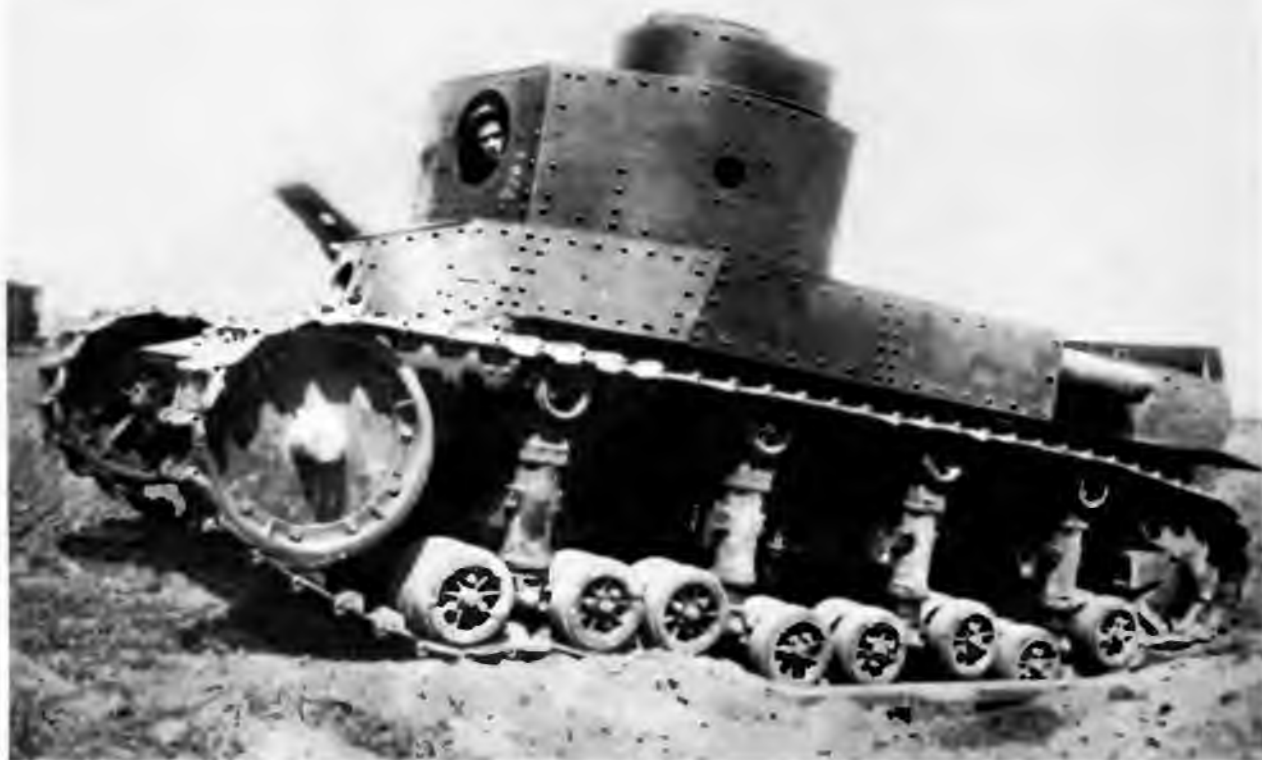
Танк Т-24 во время испытаний 18 июля 1931 года. Вооружение на танке не установлено
