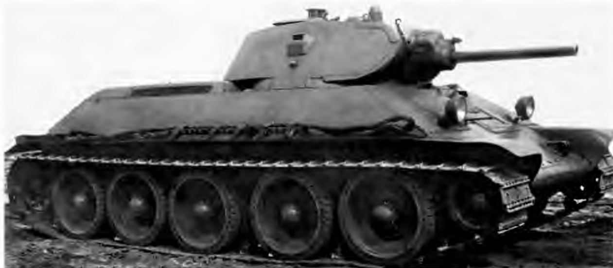
Серийный танк Т-34 выпуска 1940 года с 76-мм пушкой Л-11
