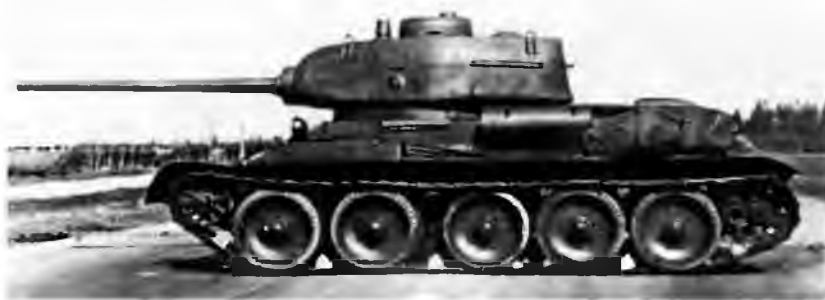
Танк Т-34 с 85-мм пушкой Д-5Т
