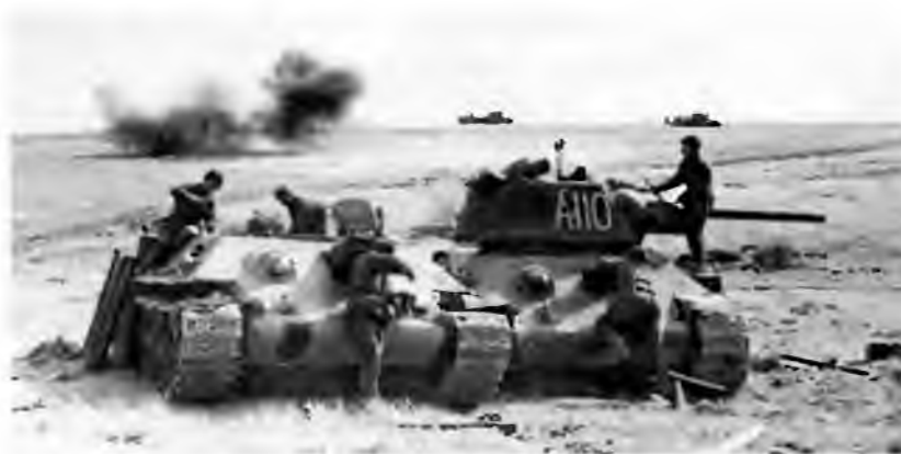
Ремонтники восстанавливают подбитый танк. Курская дуга, июль 1943 года. В качестве ремонтно-эвакуационных тягачей использовались танки Т-34 без башен
