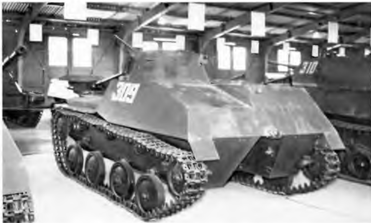
Танк Т-40 с ликвидированным приводом гребного винта (Т-40С) в Военно-историческом музее бронетанкового вооружения и техники в Кубинке
