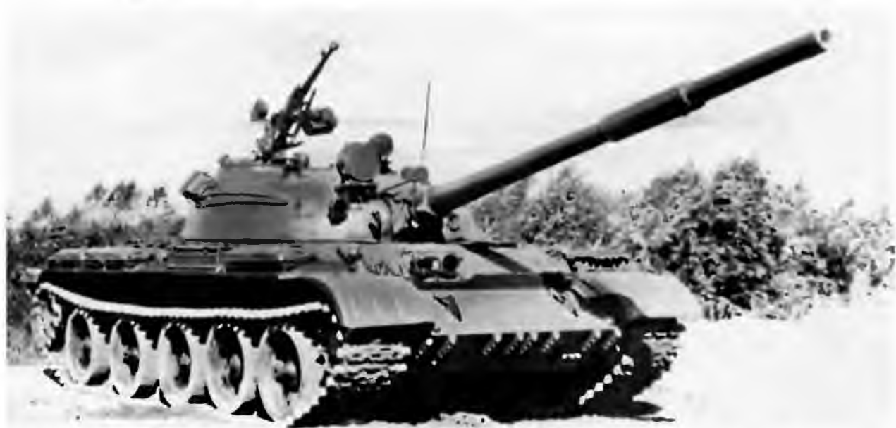
Танк Т-62 выпуска 1972 года. Главным отличием стала установка зенитного пулемета ДШКМ на люке заряжающего
