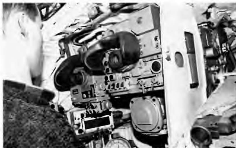
Рабочее место наводчика. Справа — лазерный прицел-дальномер 1Г42, слева — ночной прицел ТПНЗ-49
