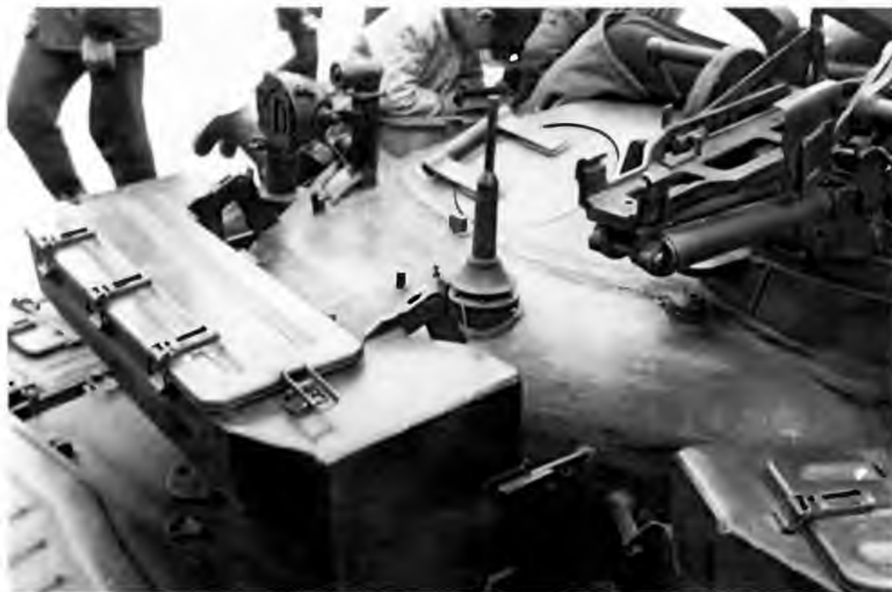
Кормовая часть башни. На переднем плане – ящик для ОПВТ и сухого пайка. Хорошо видны антенный ввод радиостанции Р-123, лючок для выброса поддонов и кронштейн с габаритным фонарем ГСТ-64 и фарой ФГ-126 с цифровой насадкой
