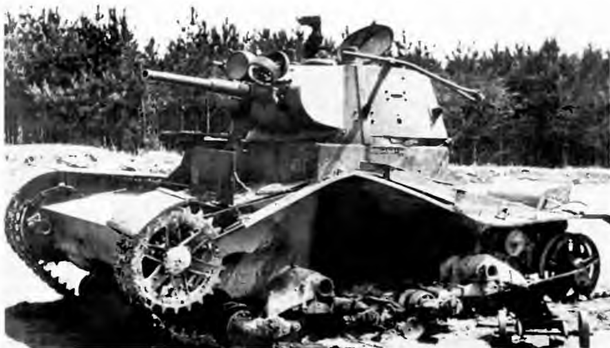
Разбитый взрывом боекомплекта танк Т-26 с конической башней, поручневой антенной и прожекторами «боевого света». Машина из состава 23-й танковой дивизии 12-го механизированного корпуса. Литва, июнь 1941 года
