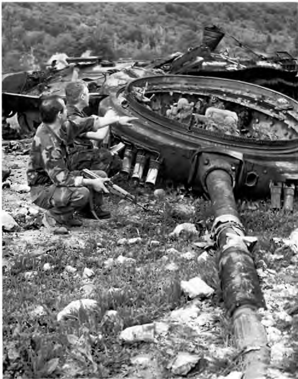
В ходе гражданской войны в Югославии было подбито немало танков МВ4, имевшихся главным образом в распоряжении частей ЮНА. Характерная деталь — башня, сорванная с погона взрывом боекомплекта
