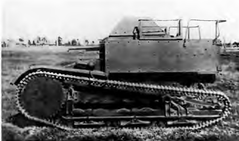
Танкетка Т-27, переоборудованная в артиллерийский тягач
