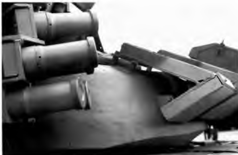
На этом снимке хорошо видна установка блоков динамической защиты на башне и угол наклона дымовых гранатометов
