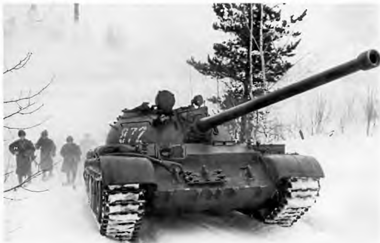
Танк Т-54Б, полученный в результате модернизации Т-54-З
