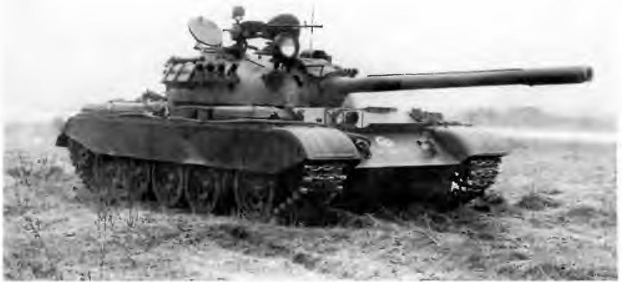
Средний танк Т-55, модернизированный в Финляндии. 1989 год. На машине установлены СУО FCS-FV/K, дымовые гранатометы, резинотканевые экраны, теплоизоляционный чехол пушки, пулемет НСВТ и гранатомет Bofors Lyran для стрельбы осветительными гранатами
