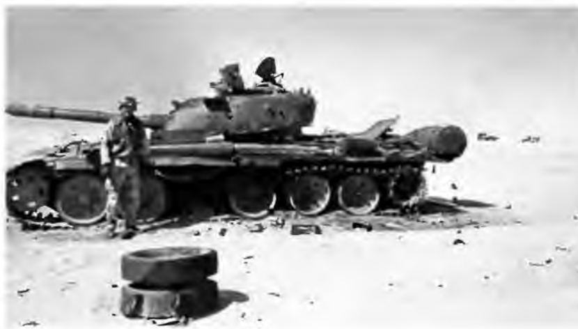
Подбитый иракский танк Т-72. Большинство потерь иракские танковые части понесли от ударов с воздуха различными видами кумулятивных боеприпасов. Результат попаданий, как правило, был одинаковым — взрыв боекомплекта и срыв башни с погона. Ирак, март 1991 года
