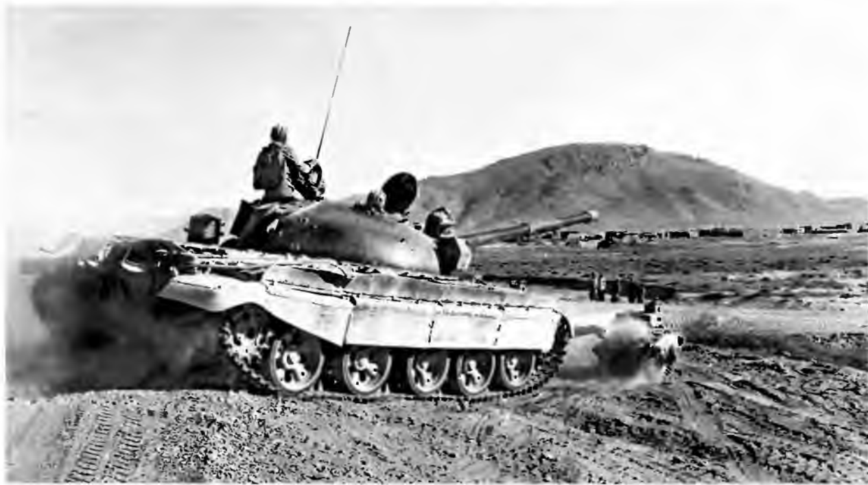
Использование танков Т-62 с Катковыми минными трапами при сопровождении транспортных колонн было в Афганистане обычным явлением. Район Кандагара, 1988 год
