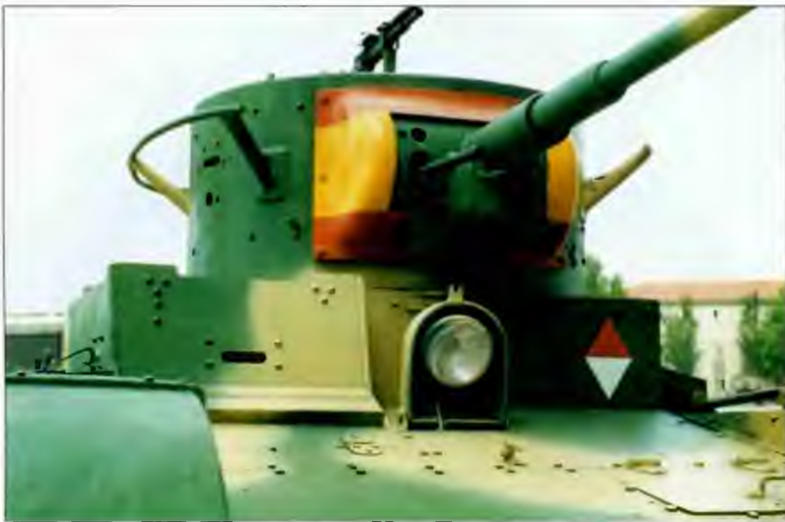
Танк Т-26 обр. 1933 г. в экспозиции музея El Goloso Baracks в Мадриде. Машина вооружена пулеметами «Гочкис». Установка зенитного пулемета и поручневая антенна – имитация.
