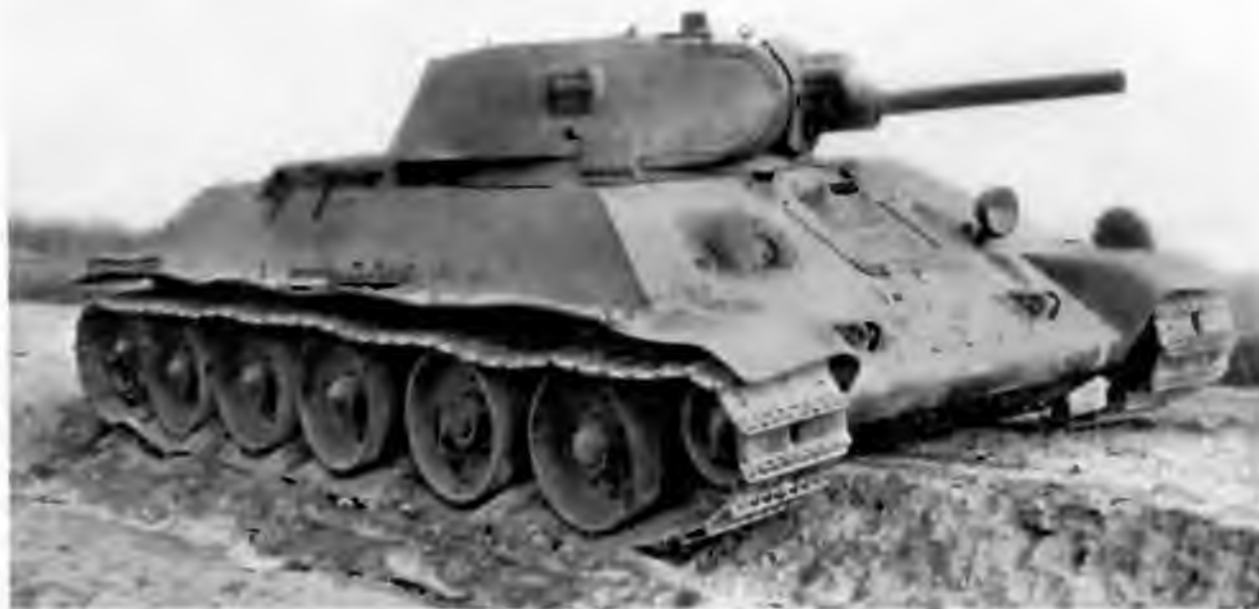
Сгоревший, судя по полному отсутствию резиновых бандажей на опорных катках, танк Т-34. На этой машине антенный ввод отсутствует, что и немудрено — из 832 танков Т-34, имевшихся в приграничных военных округах на 1 июня 1941 года, только 221 машина была оснащена радиостанциями
