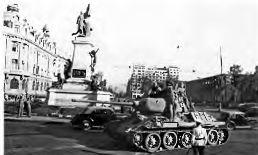
Т-34-85 18-го танкового корпуса в Бухаресте, 31 августа 1944 года. На этой машине установлены литые опорные катки раннего типа. На третьем катке отсутствует резиновый бандаж
