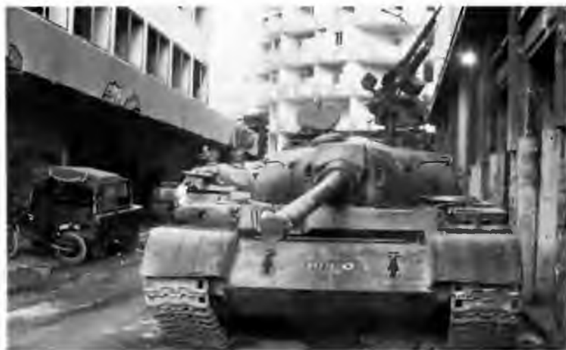
Танки Т-54 ливанской армии на позиции у «зеленой линии» в Бейруте. Сентябрь 1989 года. Обращает на себя внимание нештатная установка пулемета ДШК
