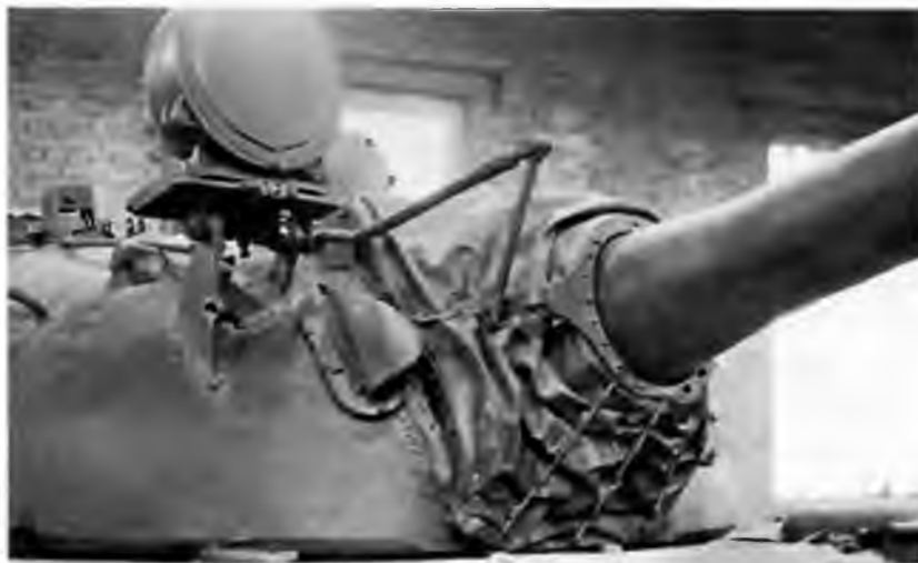
Вид на башню танка Т-55. Хорошо видны ИК-прожектор Л-2 и система тяг, связывающая его со стволом пушки
