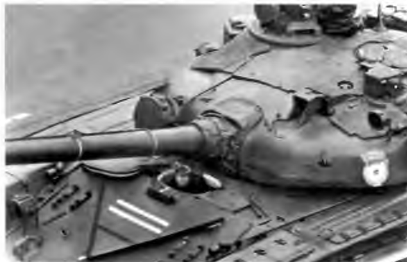
Вид сверху на Т-72Б-1. Хорошо видны дополнительный броневой лист, наваренный на лобовую броню корпуса, и противорадиационный надбой на башне
