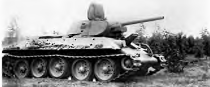
Т-34 выпуска 1941 года. Хорошо видны антенна, уложенная по-походному, и бонки для крепления наружных топливных баков на борту корпуса
