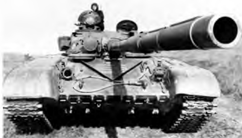
Танк Т-72 выпуска после 1975 года. На пушке — тепловыделительный кожух
