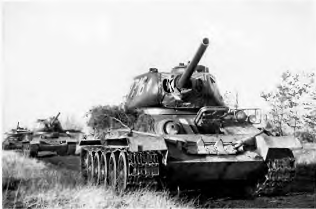
Танки Т-34-85М2 польского производства, оснащенные ОПВТ. Маск-установки пушек герметизированы водонепроницаемыми чехлами, вокруг бронемасок курсовых пулеметов приварены специальные отбортовки для крепления герметизирующих чехлов
