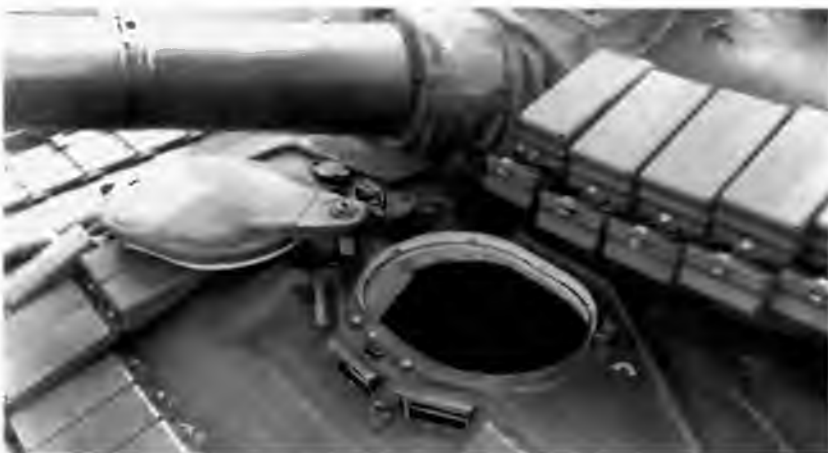
Люк механика-водителя танка Т-80БВ открыт, перед люком — три прибора наблюдения ТНПО-160. Хорошо видно крепление элементов КДЗ на башне и 30-мм броневой лист, наваренный на лобовую броню корпуса
