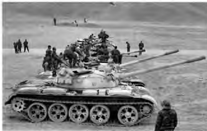
Средние танки Т-55 перуанской армии. На танках в качестве дополнительного вооружения установлены ПТУР 9М14М «Малютка»
