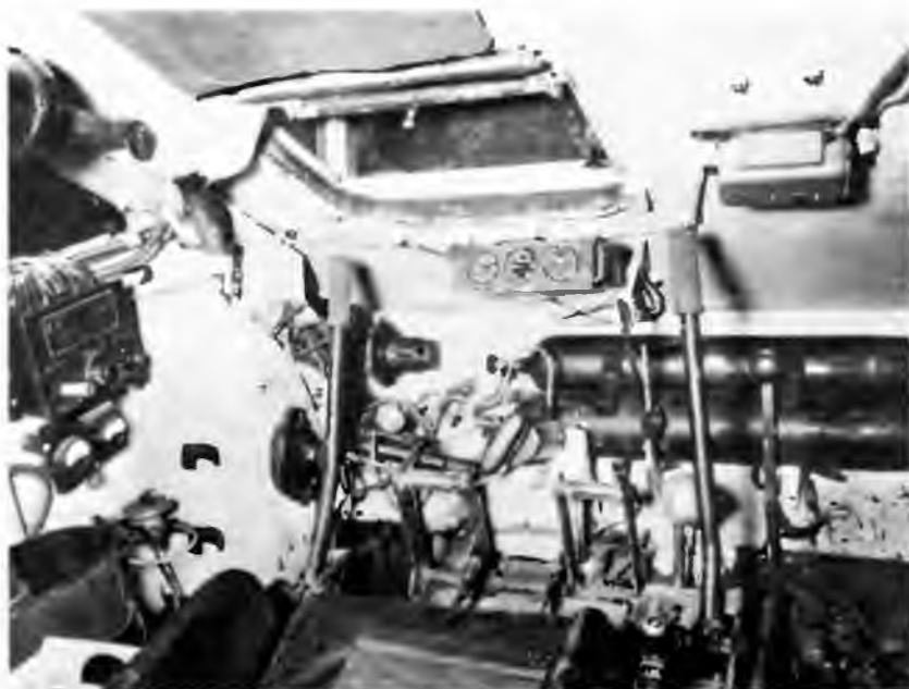
Отделение управления танка Т-34. Место механика-водителя. Черный цилиндр слева вверху — уравнивающий механизм крышки люка. Справа от люка, над баллонами со сжатым воздухом — аппарат ТПУ
