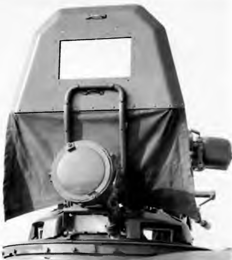
Защитный щиток, установленный на люке командира и защищавший его на марше от грязи и пыли
