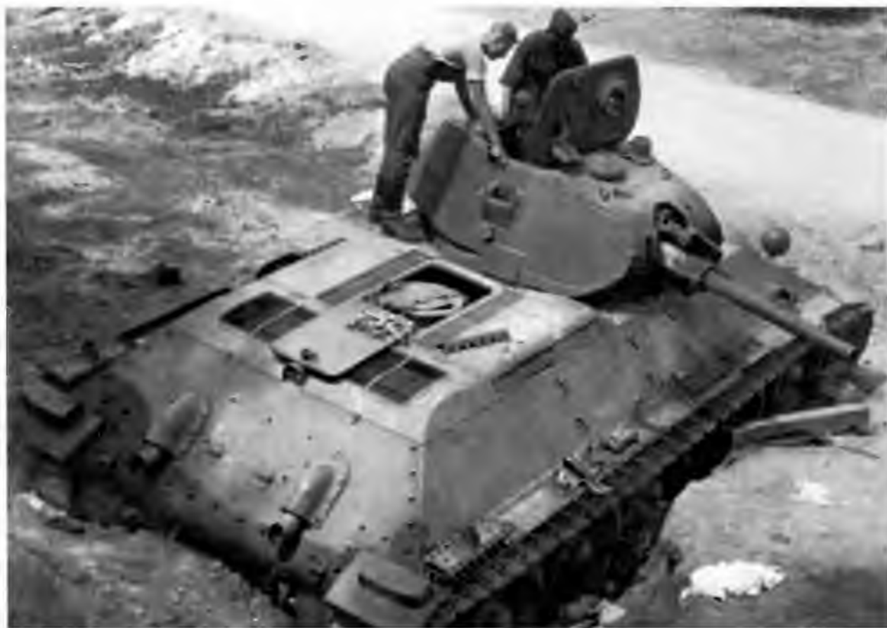
Немецкие солдаты осматривают трофейный танк Т-34. Маска пушки Л-11 сорвана, крышка люка над двигателем откинута и хорошо виден «блин» воздухоочистителя «Помон». Возможно, танк был оставлен экипажем по причине выхода из строя именно воздухоочистителя, что было массовым явлением в 1941 году. Антенный ввод размещен на правом борту корпуса, впрочем, наличие антенного ввода вовсе не свидетельствует о наличии на танке радиостанции
