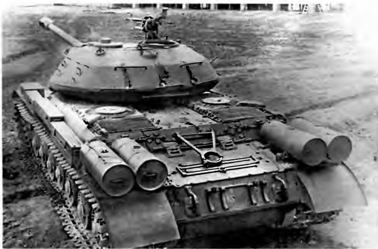
Вид сзади на ИС-4. Обращает на себя внимание характерное и необычное для советских танков расположение дополнительных топливных баков
