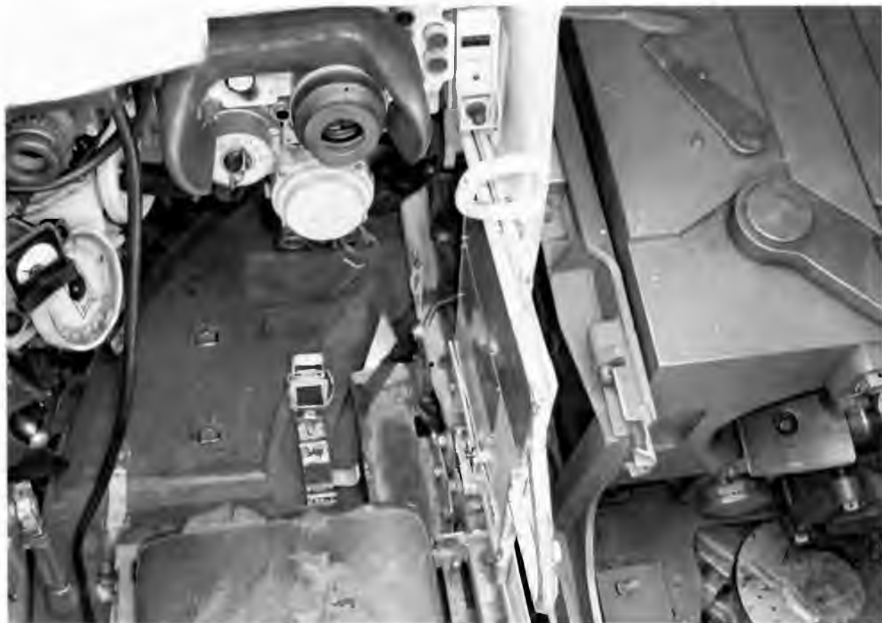
Вид на рабочее место наводчика через его люк. Хорошо видны налобник и окуляр прицел-дальномера ТПД-К1
