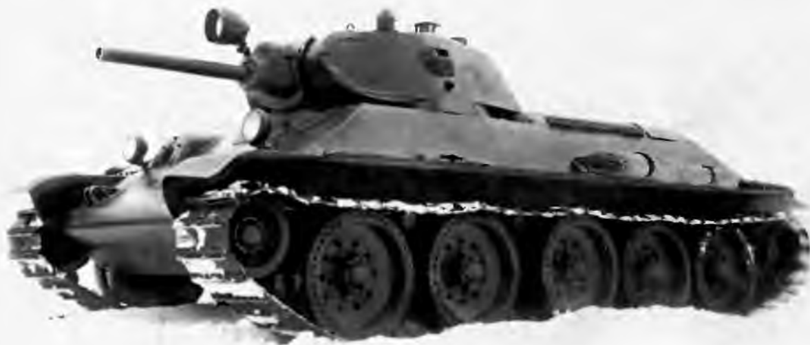
Опытный образец среднего танка А-34 во время испытаний на НИБТПолигоне в Кубинке. Март 1940 года
