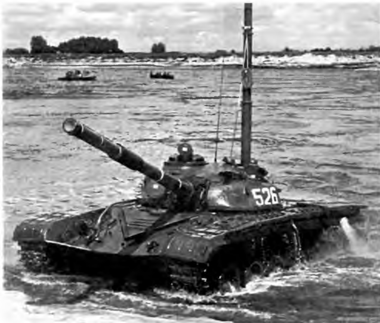
Танк Т-72 с установленной воздухопитающей трубой выходит из воды после преодоления водной преграды
