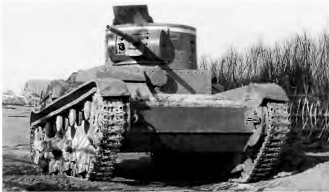
Танк Т-26 выпуска 1935 года с клепаным корпусом и сварной башней. Броневой колпак фары еще отсутствует. Киевский военный округ, 1936 год
