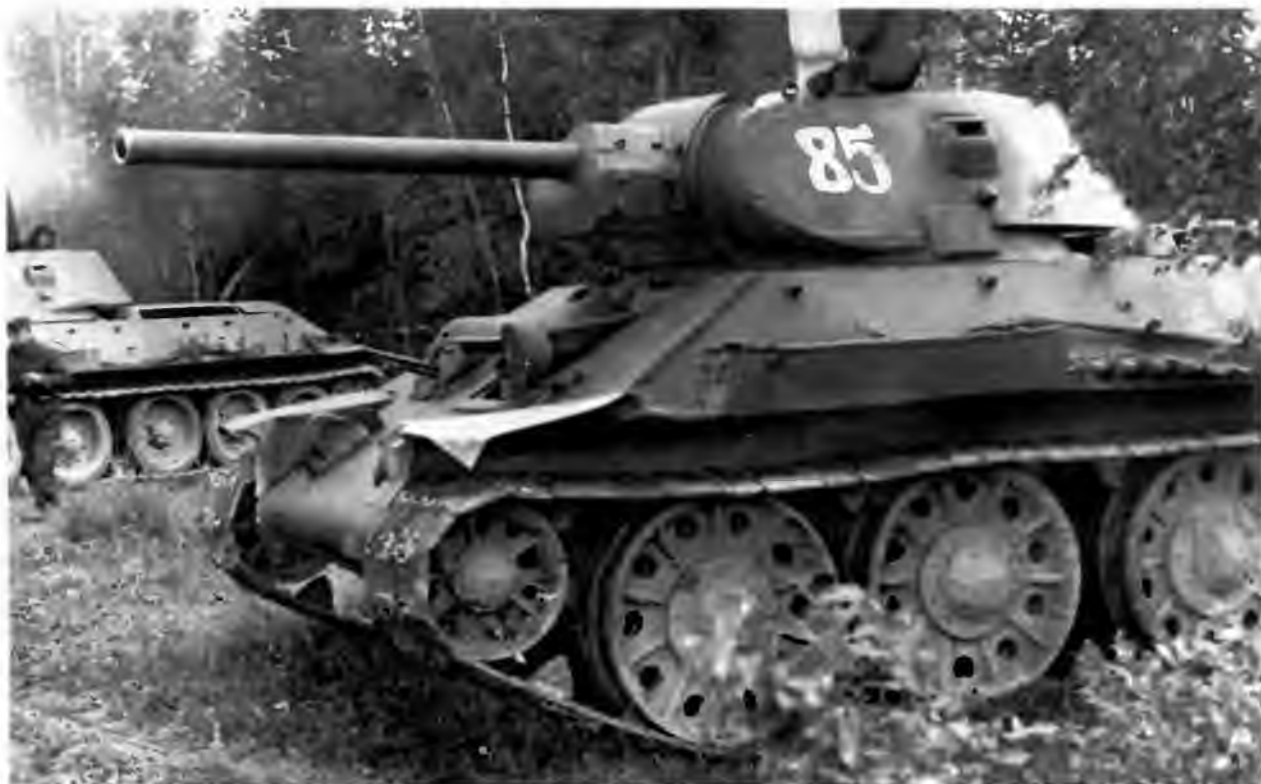
Танк Т-34 производства СТЗ выпуска конца 1941 года с цельносварными опорными катками и необрезиненным направляющим колесом
