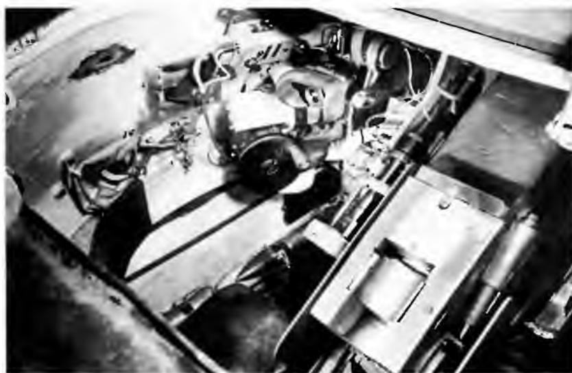
Вид внутрь башни танка Т-34 через башенный люк. Слева от казенника пушки Ф-34 хорошо различима трубка телескопического прицела ТМФД-7, выше ее — налобник и окуляр перископического прицела ПТ-4-7 и маховик поворотного механизма башни. Над последним размещен аппарат №1 ТПУ командира танка. Левее и ниже аппарата ТПУ видна рамка бортового смотрового прибора, пользоваться которым, судя по снимку, командиру танка было весьма затруднительно
