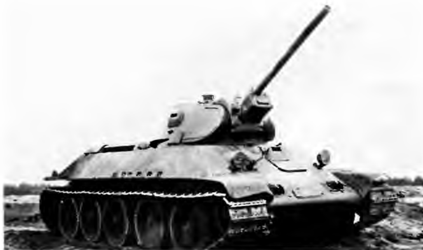
Танк Т-34 с 76-мм пушкой Ф-34 во время испытаний на Гороховецком полигоне. Ноябрь 1940 года
