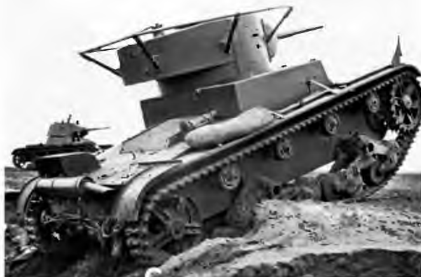
Легкий танк Т-26 выпуска 1936 года на маневрах. 1939 год. Танк имеет сварные корпус и башню, штампованную маску пушки и поручневую антенну
