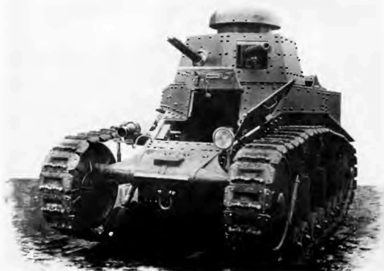
Легкий танк Т-18 (МС-1) первой серии. 1929 год. В башне хорошо видна спарка пулеметов Федорова—Иванова
