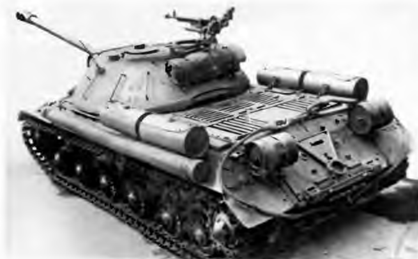
Серийный танк ИС-3, вид сзади сверху. Машина полностью укомплектована: на корме башни уложен укрышочный брезент, на левом борту — бревно самовытаскивания, на корме корпуса — дымовые шашки МДШ и буксирный трос
