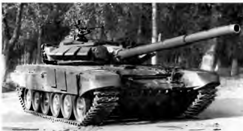
Танк Т-72Б образца 1989 года со встроенной динамической защитой
