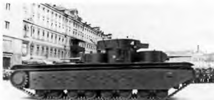
Модернизированный образец Т-35А с бортовыми экранами измененной конфигурации по пути на Красную площадь. 1 мая 1937 года
