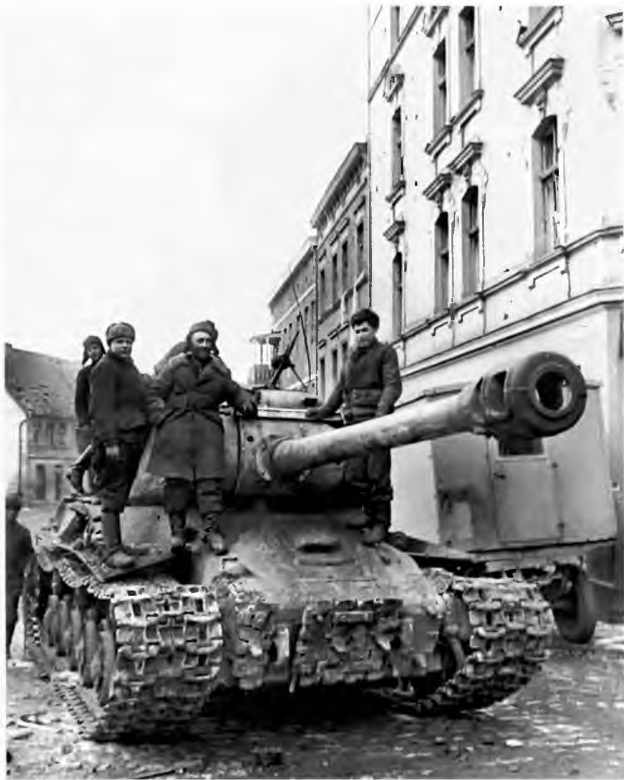
ИС-2 на улице г. Штарград, Восточная Пруссия, 2-й Белорусский фронт, 19 марта 1945 года. У этой машины отсутствовала зенитно-пулеметная установка и для борьбы с «фаустниками» использовался пулемет ДТ с пехотными сошками
