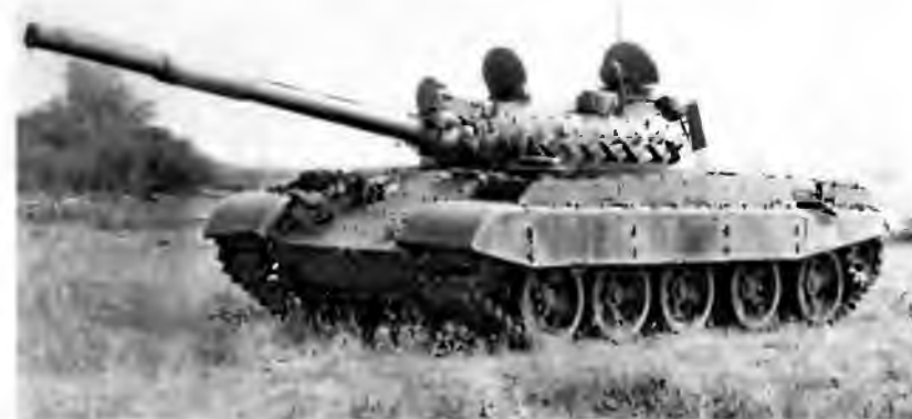
Средний танк Т-62МВ. На башне и корпусе хорошо видны бонки и кронштейны для крепления элементов комплекса динамической защиты
