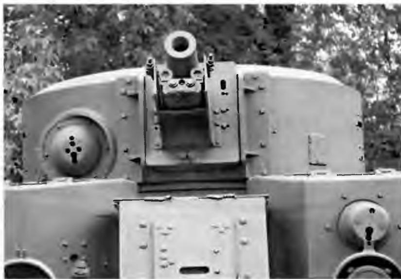
Вид спереди на главную башню. Видна маск-установка пушки КТ-28 и шаровая установка пулемета ДТ. На переднем плане — рубка механика-водителя
