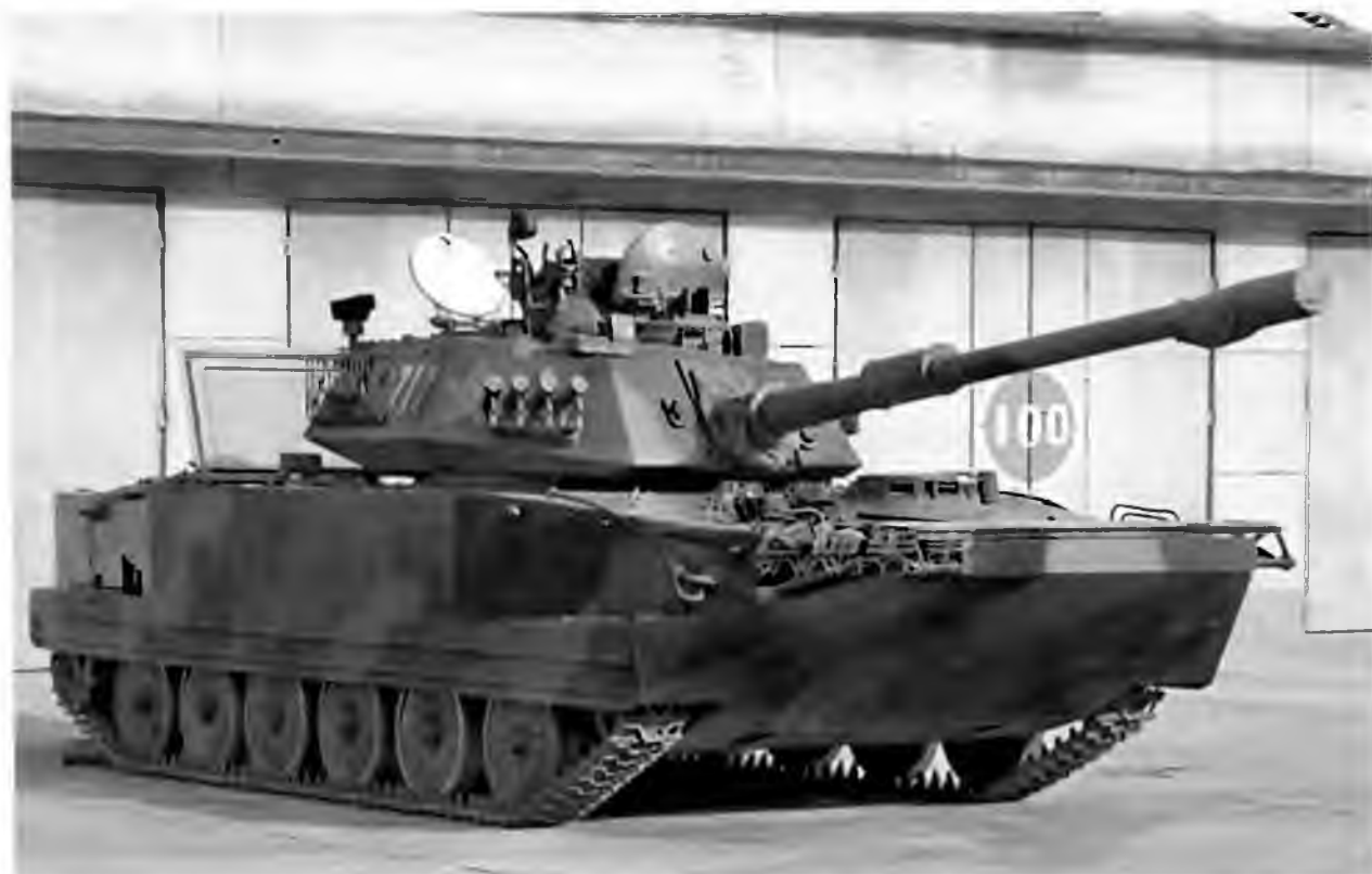
Легкий плавающий танк Type 63A. Несмотря на новую башню и вооружение, в корпусе танка легко узнается ПТ-76
