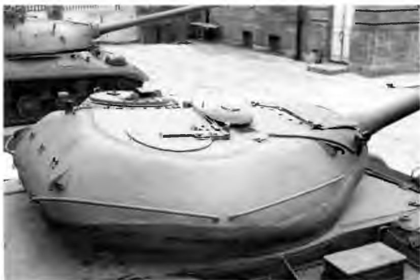
Башня танка Т-54-1. Характерная деталь всех «пятьдесятчетверок» — броневой «грибок» вентилятора в центре крыши
