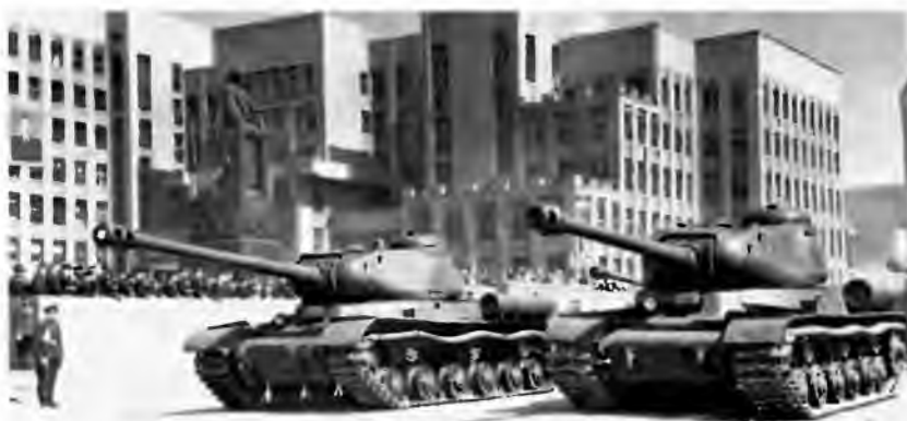
Парад в Минске 1 мая 1952 года. На переднем плане ИС-2 раннего выпуска. У машины справа — дульный тормоз пушки немецкого типа; кроме того, вместо перископического прицела ПТ4-17 у нее установлен прибор наблюдения МК-4
