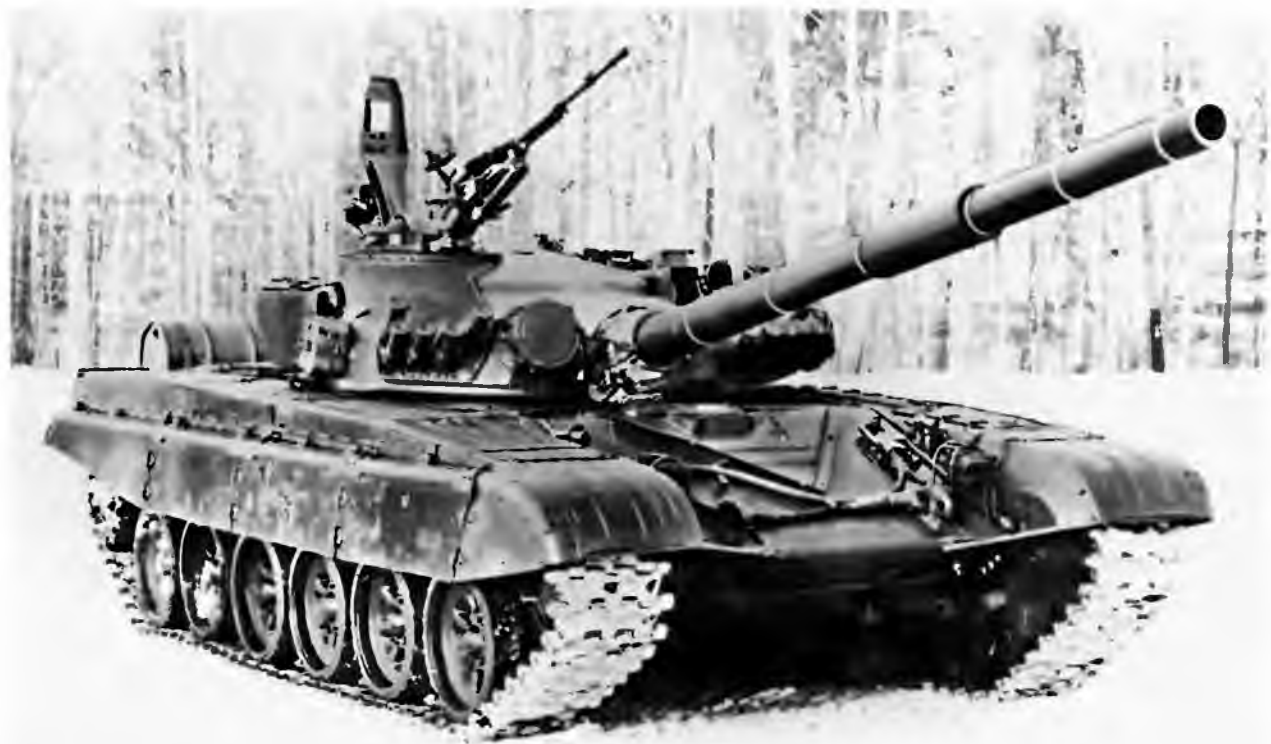
Танк Т-72А. Обращают на себя внимание сплошные резиноктаневые экраны и дымовые гранатометы системы «Туча»
