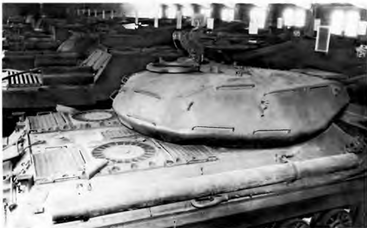
Вид сверху на башню и корму корпуса танка ИС-4. Хорошо видны выхлопные патрубки и надвентиляторные плиты
