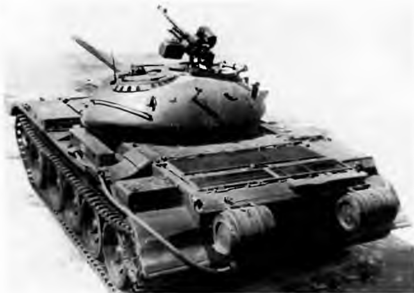
Вид сзади на танк Т-54-2. На надгусеничных полках отсутствуют ящики с пулеметами. Цилиндрические баки заменены на прямоугольные
