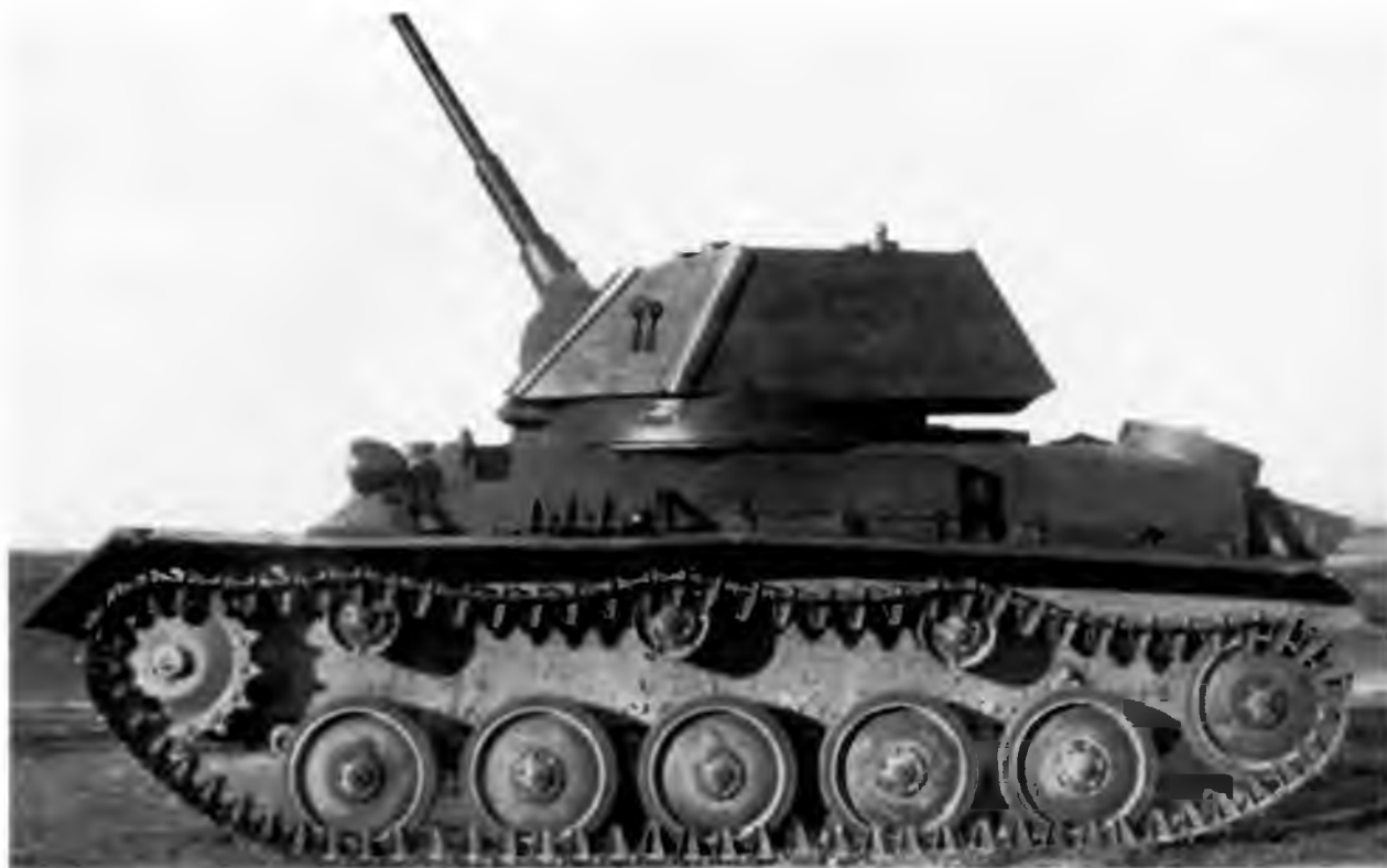
Легкий танк Т-80. Орудие поднято на максимальный угол возвышения
