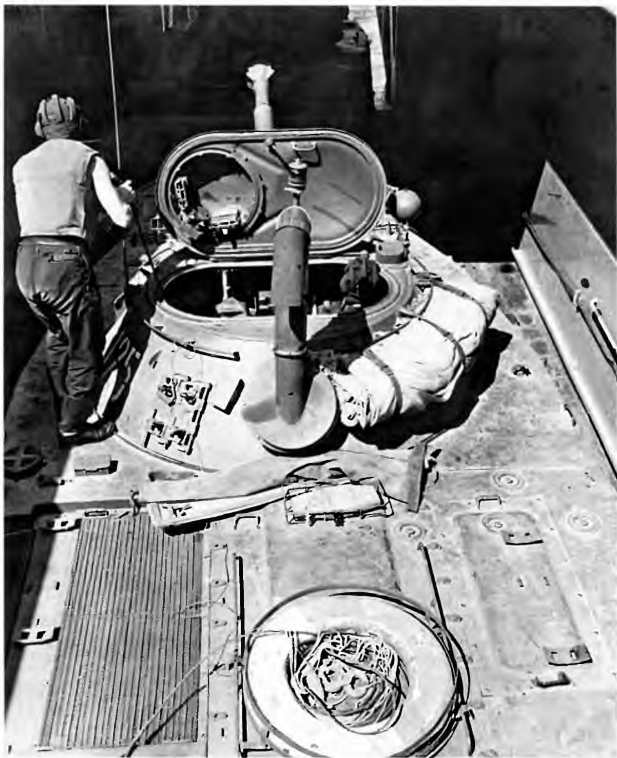
Танки готовятся покинуть десантный корабль. Краснознаменный Черноморский флот, 1966 год. Машины морской пехоты оснащались снаряжением, специфичным только для этого рода войск. Кроме аварийного бую (в сетке сразу за башней) на крыше МТО крепился спасательный круг. На вытяжной вентилятор башни ставилась воздухоотводящая труба, к которой крепился ходовой огонь
