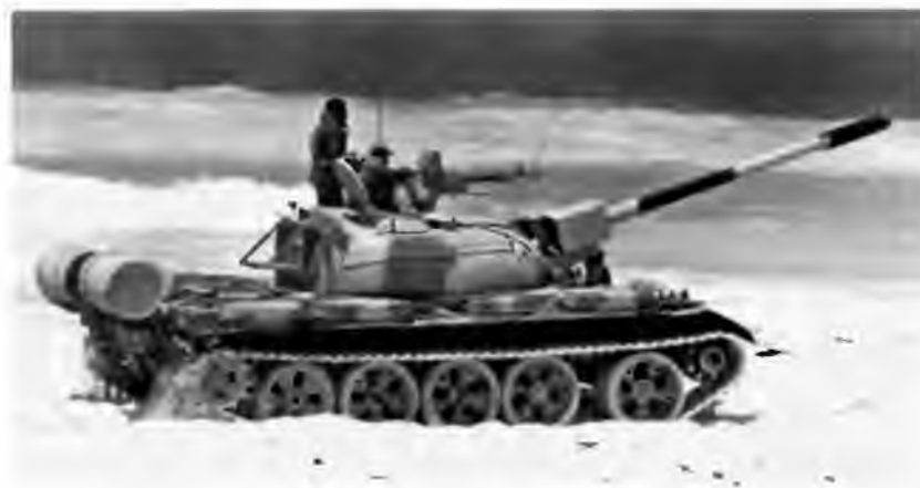
Накануне войны 1973 года египтяне оснастили часть танков Т-54А немецкими инфракрасными прожекторами фирмы «Телефункен»
