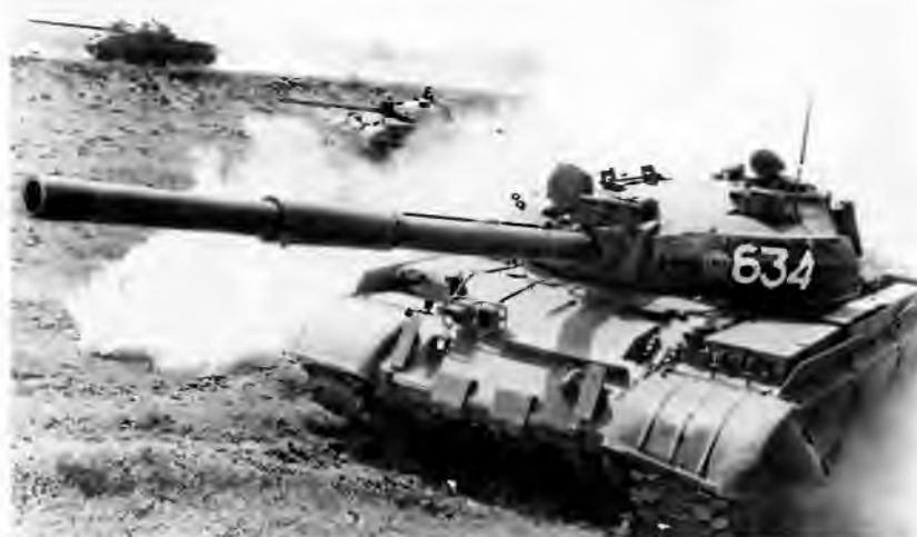
Модернизированный средний танк Т-62М. Налицо все внешние признаки этой машины: усиленное бронирование, лазерный дальномер, бортовые экраны и теплозащитный кожух пушки
