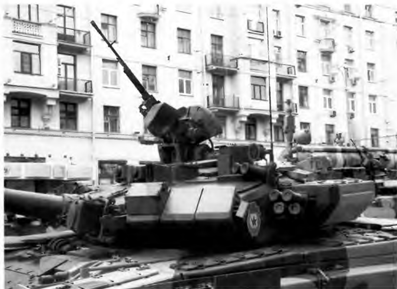
Башня танка Т-90А крупным планом
