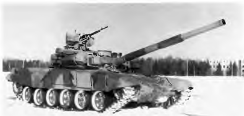
Танк Т-90 на полигоне в Кубинке. На бортах этого танка установлено по четыре блока динамической защиты
