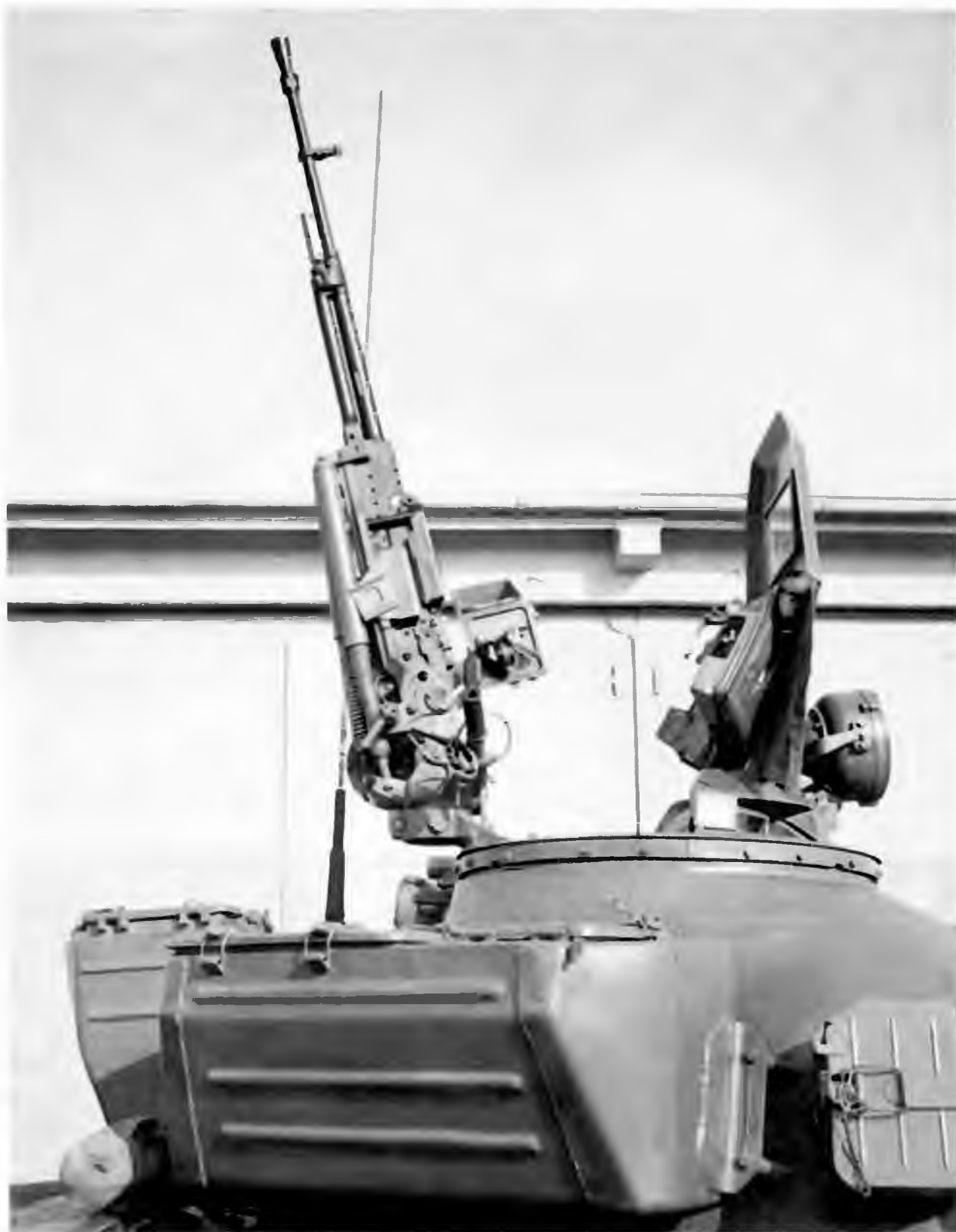
Зенитно-пулеметная установка на максимальном угле возвышения: +75°
