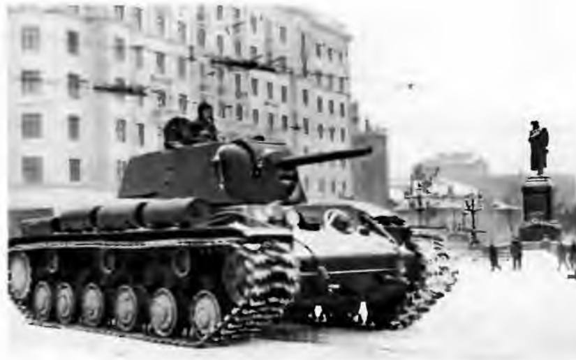
Танк KB-1 с литой башней производства УЗТМ. Пушкинская площадь в Москве, январь 1942 года
