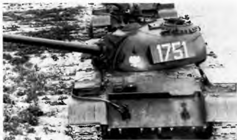
Танк Т-54А польского производства. Характерными внешними отличиями этих машин были L-образные топливные баки на надгусеничных полках и ящик ЗИП на борту башни
