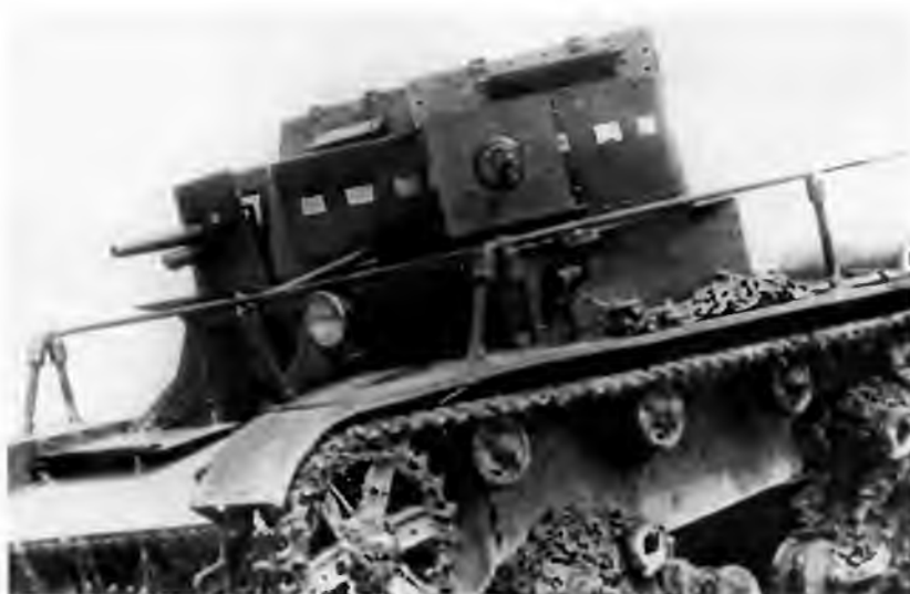
Легкий танк Т-26. Двухбашенная модификация с пушечно-пулеметным вооружением. По периметру корпуса установлена поручневая антенна
