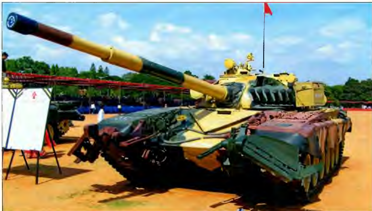
Танк Т-72М1 индийского производства. На машине установлен колеяный ножевой минный трал КМТ-6.
