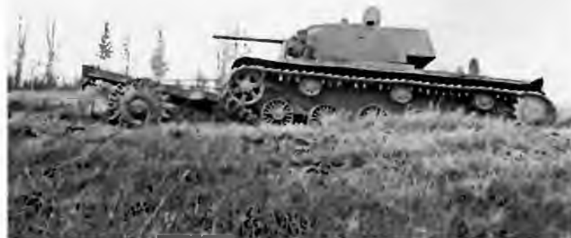
Танк КВ-1 с Катковым минным тралом из состава 26-го гвардейского танкового полка прорыва. Ленинградский фронт, Карельский перешеек, лето 1944 года
