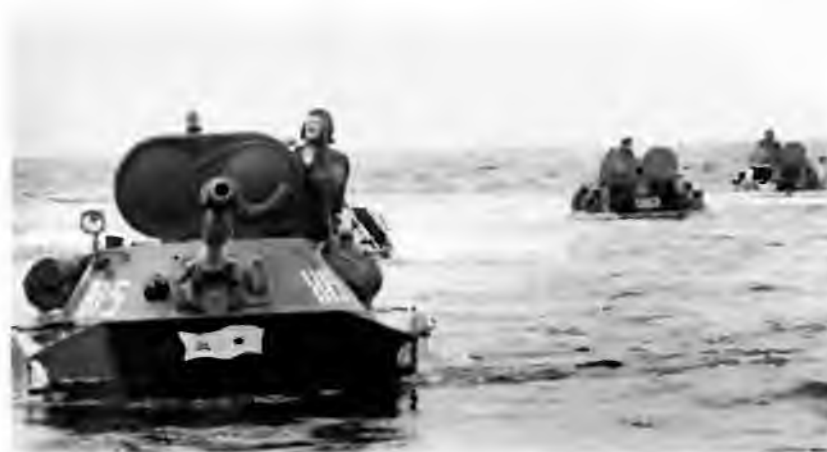
ПТ-76Б одного из подразделений морской пехоты Краснознаменного Черноморского флота. 1975 год. У танка поднят волноотражательный щиток и установлен прибор наблюдения механика-водителя ТНП-370
