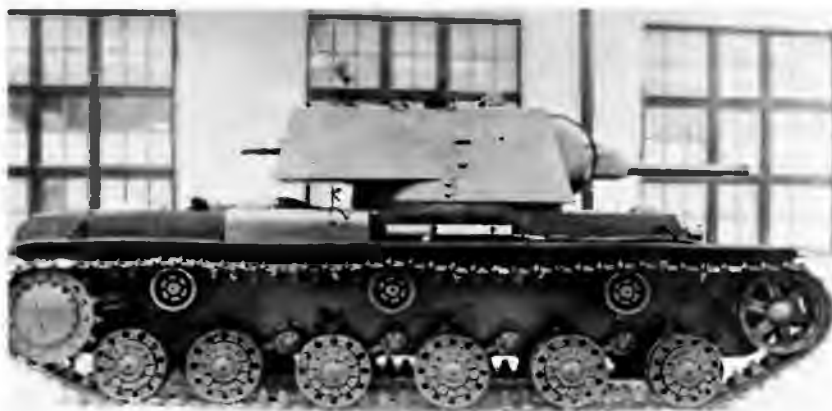
Тяжелый танк КВ выпуска 1940 года (с пушкой Л-11). На 22 июня 1941 года в эксплуатации находилось только 75 танков КВ
