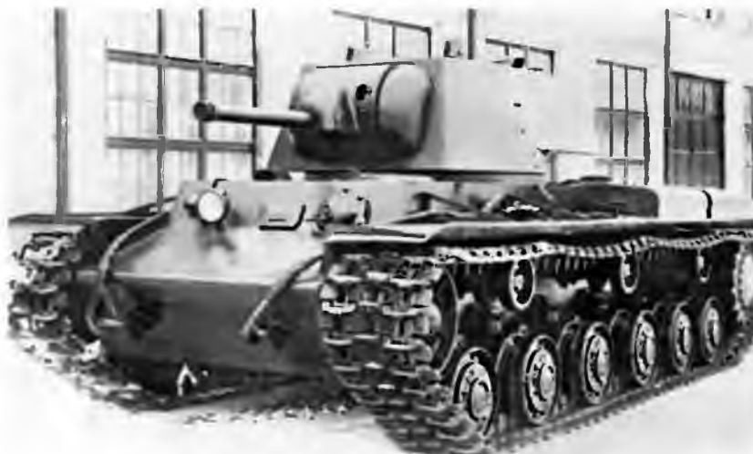
Серийный KV-1 со сварной башней и пушкой Л-11. 1940 год
