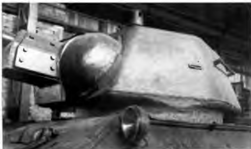
Литая «улучшенная» башня производства Уралмашзавода. 1942 год
