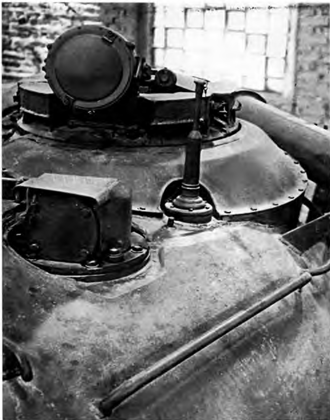
Вид на башню танка Т-55. На переднем плане — головка ночного прицела ТПН-1-22-11, за ней — антенный ввод. На командирской башенке установлен ИК-осветитель командирского прибора наблюдения ТПКУ-2Б
