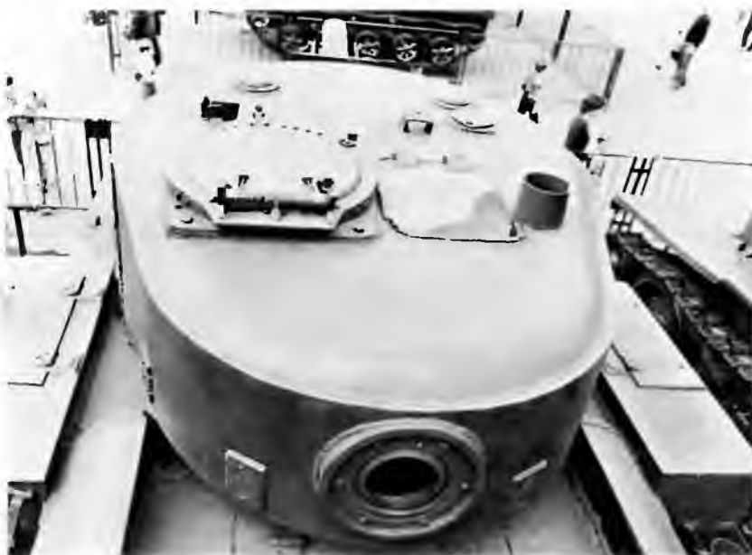
Вид сверху на главную башню. Хорошо видны люк с турелью для зенитного пулемета и гнездо шаровой установки в нише. Справа от люка командира — бронировка антенного ввода
