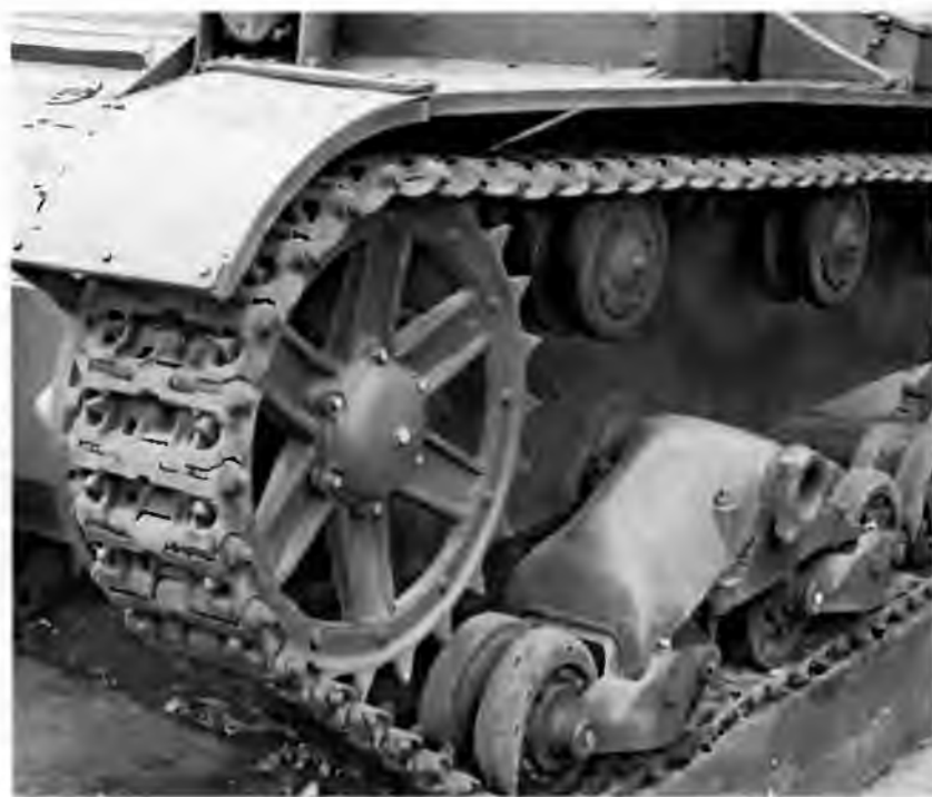
Хорошо видны все элементы ходовой части: ведущее колесо, передняя тележка подвески с опорными катками, поддерживающие катки и гусеница
