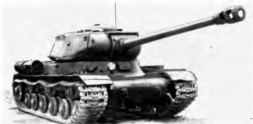
Тяжелый танк ИС-2 промежуточной модели, со старым корпусом с «ломаным носом» и новой башней
