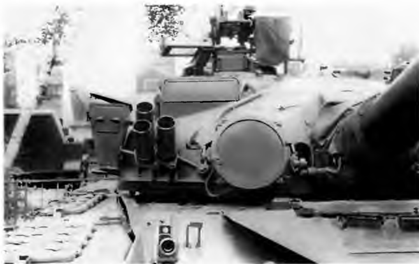
Башня танка Т-80Б спереди слева. Хорошо видны ИК-осветитель Л-4А, дымовые гранатометы, антенный блок ГТН-12 КУВ «Кобра» и амбразура спаренного пулемета ПКТ
