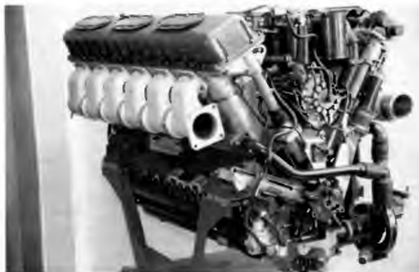
Двигатель В-84МС
