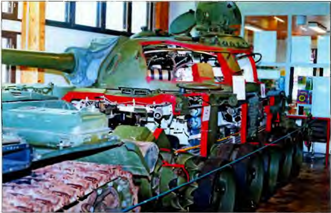
Учебный, так называемый «разрезной» танк Т-54 демонстрируется в финском танковом музее в Пароле. Подобные машины широко использовались для подготовки личного состава и в Советской Армии.
