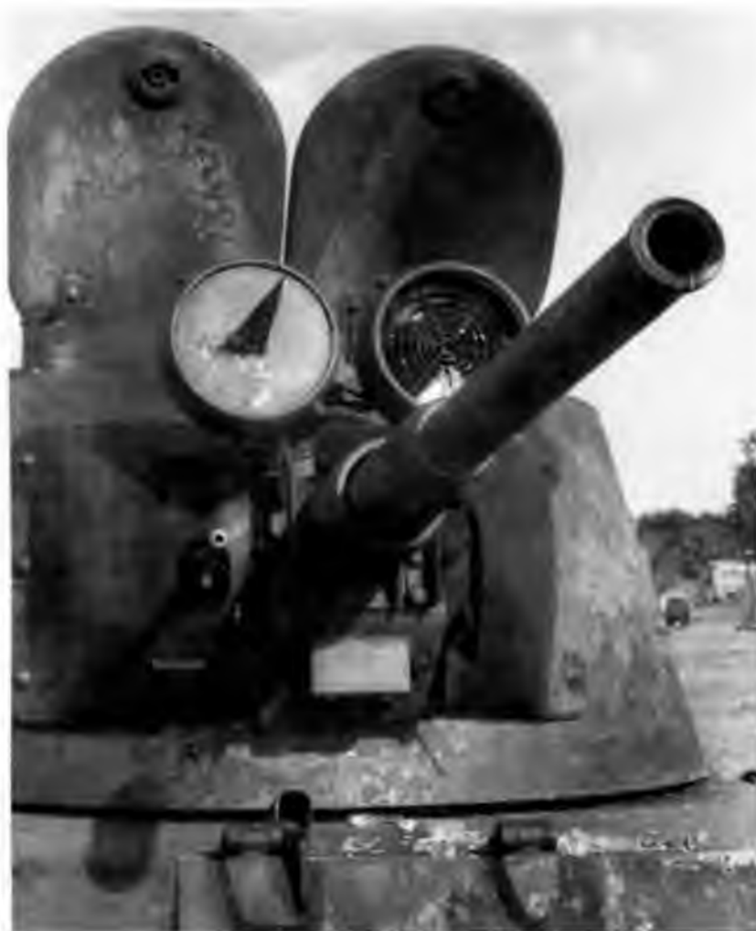
Подбитый танк БТ-7. На стволе орудия смонтированы фары «боевого света». За две овальные крышки башенных люков, которые в открытом положении придавали танку своеобразный облик, немецкие солдаты прозвали его «Микки Маус»
