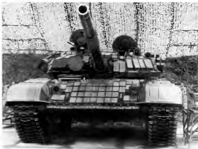
Танк Т-72Б, оснащенный комплексом динамической защиты «Контакт». Правее и выше амбразуры прицельного комплекса 1А40-1 хорошо видна открытая амбразура прицела-прибора наведения 1К13 комплекса управления вооружения
