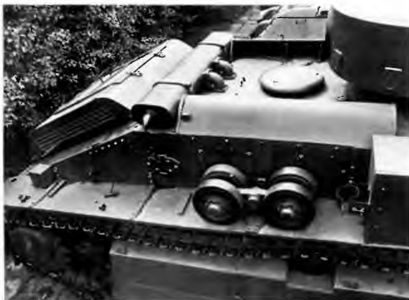
Корма танка Т-28. Хорошо просматриваются жалюзи на колпаке вентилятора и глушитель. В средней части крыши МТО — грибовидный колпак воздушного фильтра
