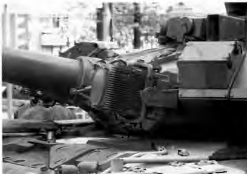
Передняя часть башни. Хорошо видны блоки динамической защиты «Контакт V» и осветитель системы оптико-электронного подавления «Штора-1»
