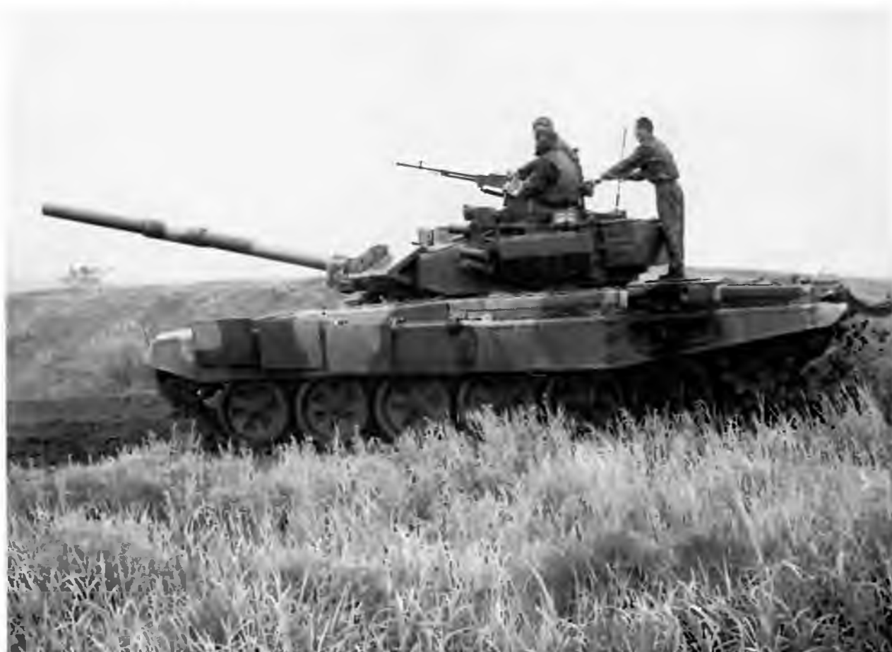
Танк Т-90С на выставке ВТТВ «Омск-99». На этой машине установлена сварная башня и двигатель В-92С2
