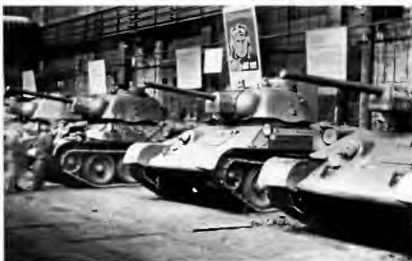
Танки Т-34 обр. 1942 года со штампованными башнями и командирскими башенками в цеху Челябинского Кировского завода. Октябрь 1943 года
