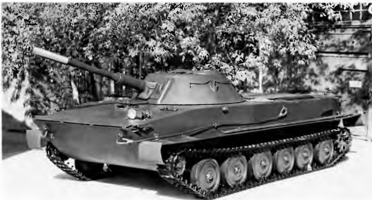
Танк ПТ-76 одной из первых производственных серий. Обращают на себя внимание гладкие штампованные опорные катки и фара ФГ-10 в паре с сигналом на верхнем носовом листе корпуса
