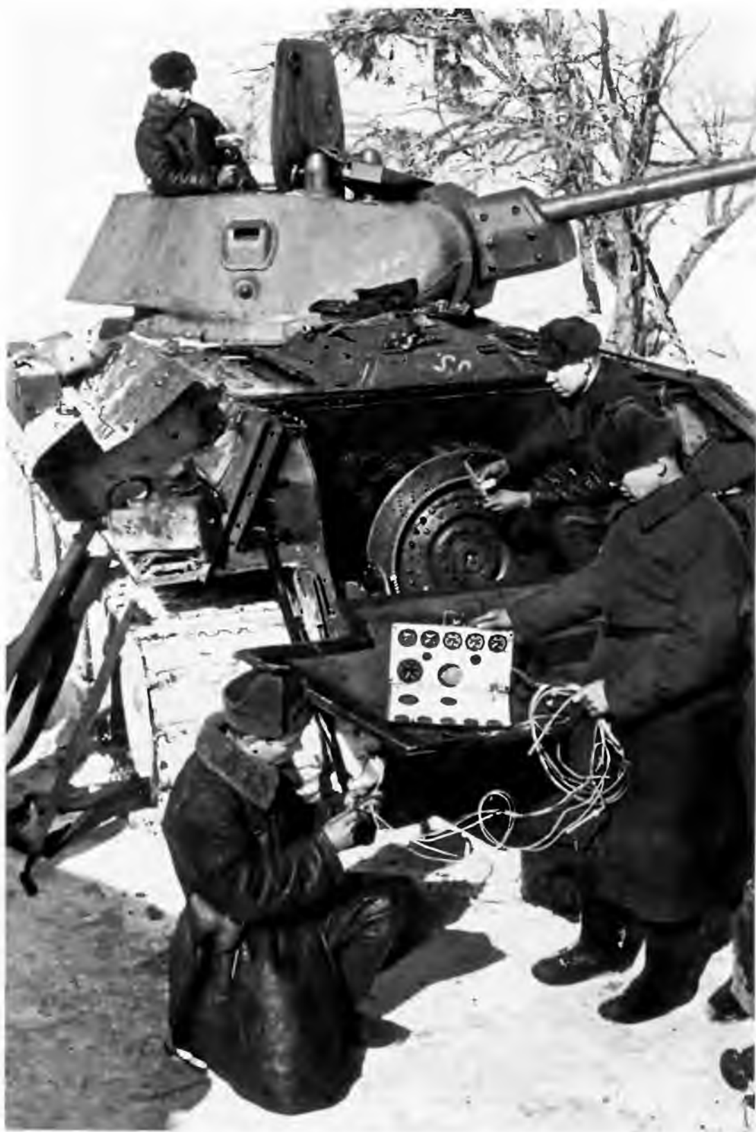
Ремонт танка Т-34 в полевых условиях. Западный фронт, ноябрь 1941 года
