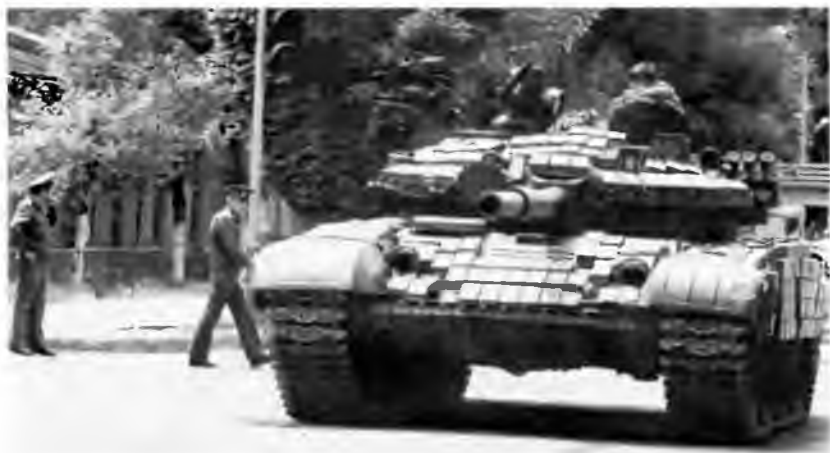
У КПП 201-й мотострелковой дивизии. Танк Т-72АВ, оборудованный навесной динамической защитой в ходе капитального ремонта. Душанбе, 9 мая 1992 года
