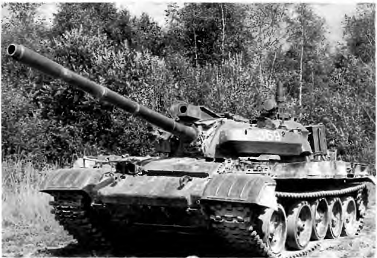
Модернизированный танк чехословацкого производства Т-55АМ2, оснащенный СУО «Кладиво»
