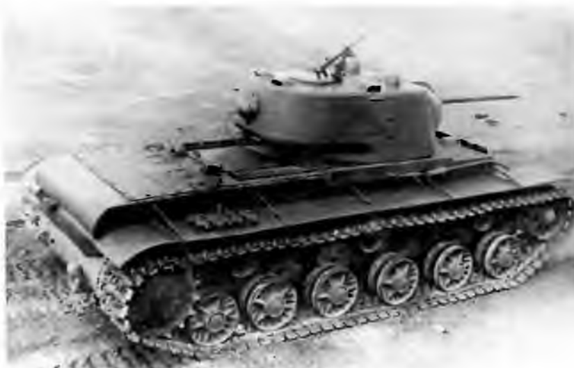
Танк КВ-1 с литой башней и корпусом, выпускавшимся заводом № 200. Весна 1942 года
