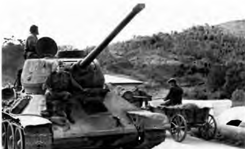
Советские танки в горах Трансильвании. 2-й Украинский фронт, Румыния, лето 1944 года. Это машина ранних выпусков, о чем можно судить по пушке С-53, отсутствию бонок для крепления запасных траков на лобовой броне корпуса и приборам наблюдения МК-4 без крышечек
