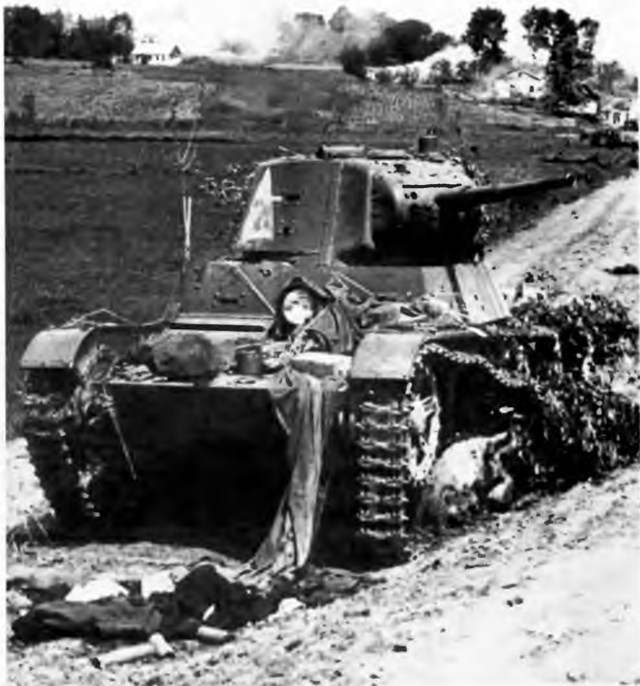
Танк Т-26 обр. 1939 года, брошенный экипажем из-за слетевшей левой гусеницы. Юго-Западный фронт, июнь 1941 года
