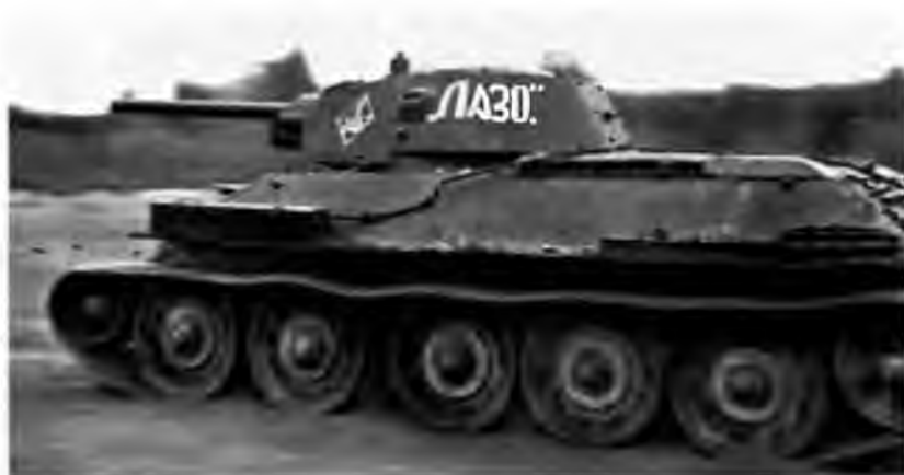
В атаке — Т-34 производства СТЗ с опорными катками с внутренней амортизацией. 1942 год
