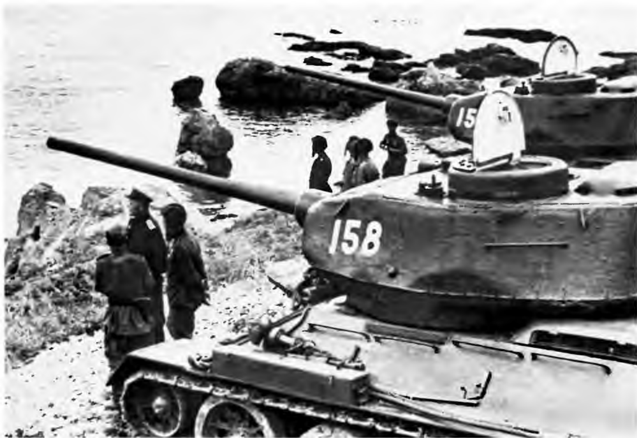
«И на Тихом океане свой закончили поход». Район Даляня, август 1945 года. На снимке танки Т-34-85 с низкой командирской башенкой позднего типа
