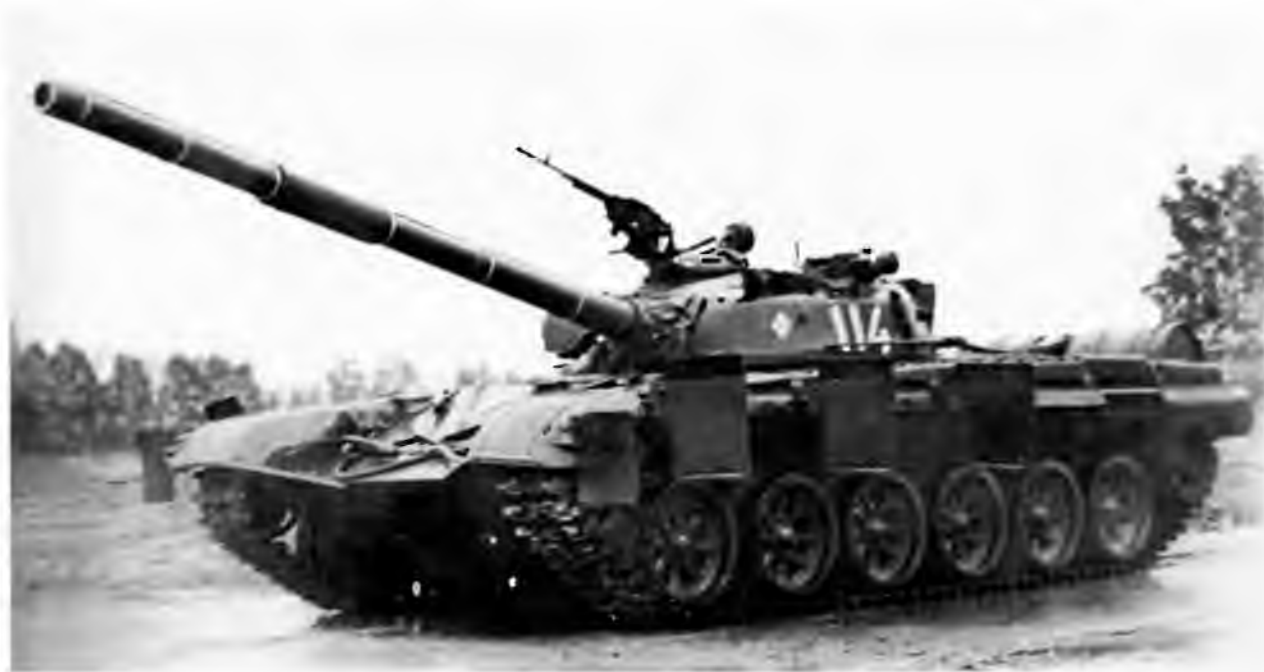
Танк Т-72 с бортовыми экранами, развернутыми в боевое положение
