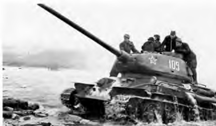
Т-34-85 позднего выпуска 1944 года. Нештатные грязевые щитки установлены, видимо, в ходе ремонта. Довольно редкий снимок, на котором хорошо видны полностью открытые «ресницы» — бронеовые крышки призм приборов наблюдения механика-водителя
