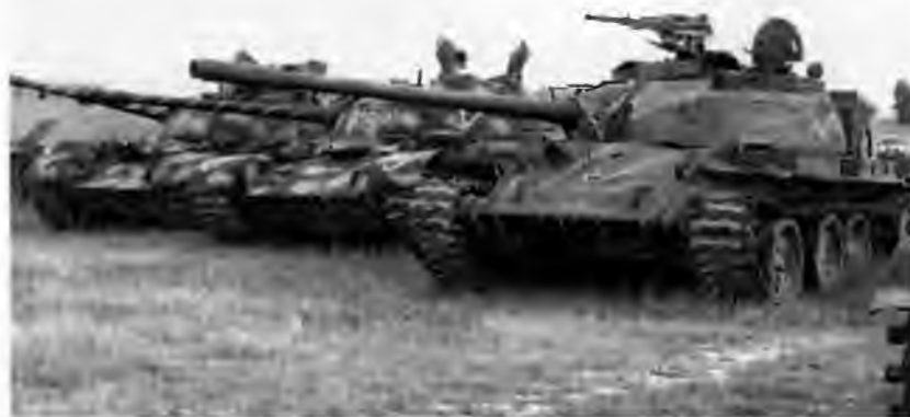
Кладбище танков Т-55 в Афганистане, каких много сейчас в этой стране. У машины справа обращает на себя внимание нештатная установка 14,5-мм пулемета КПВ у люка заряжающего
