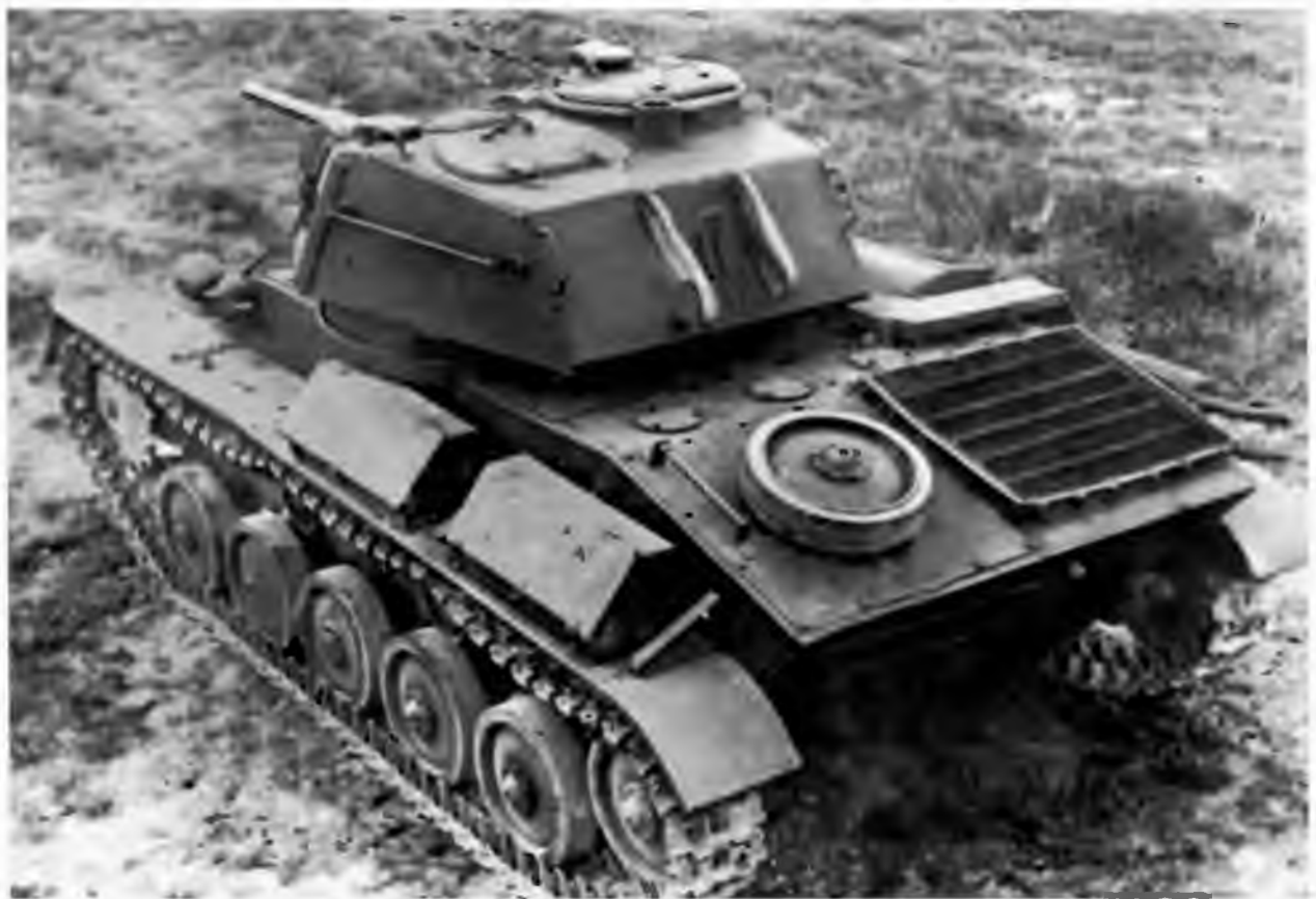
Легкий танк Т-80. Хорошо видно основное отличие от Т-70М — двухместная башня
