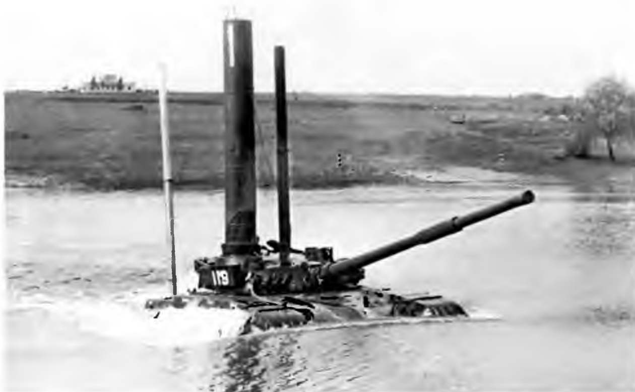
Танк Т-64Б-1 с установленным оборудованием для подводного вождения и трубой-лазом преодолевает водную преграду
