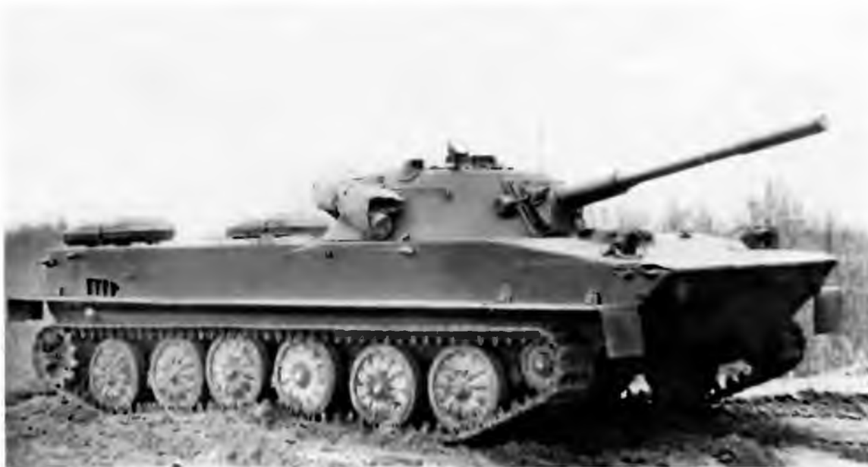
ПТ-76 поздних выпусков (до 1957 года). У этой машины опорные катки позднего типа (с выштамповками) и прямоугольные 95-литровые дополнительные топливные баки
