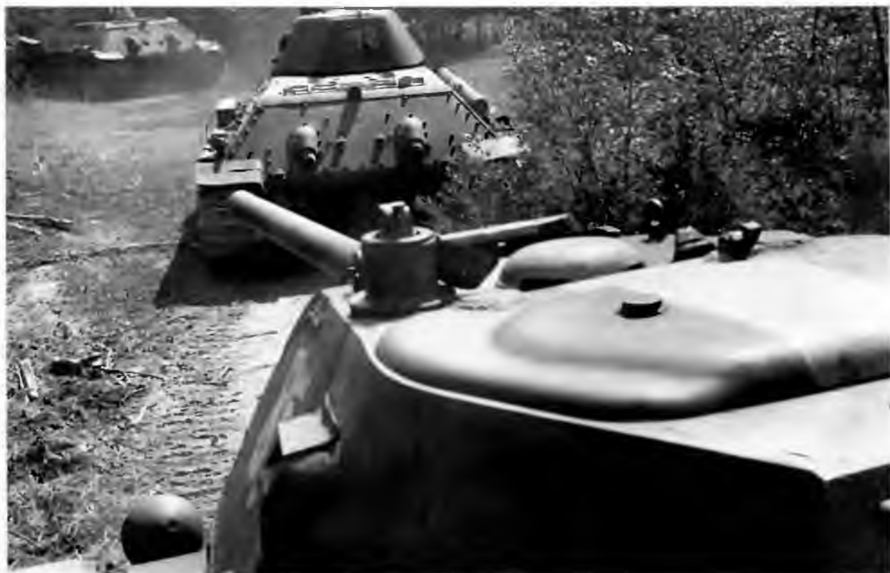
«Тридцатьчетверки» производства СТЗ. На переднем плане — машина со сварной башней и полностью съемным кормовым листом, крепившимся на восьми болтах. Перед ней в колонне — танки с литыми башнями
