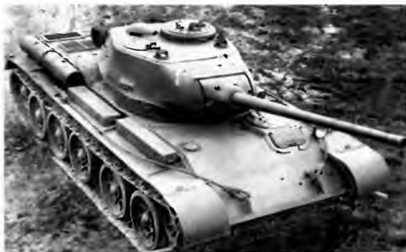
Танк Т-44А, вооруженный 85-мм пушкой С-53, на государственных испытаниях. Сентябрь 1944 года
