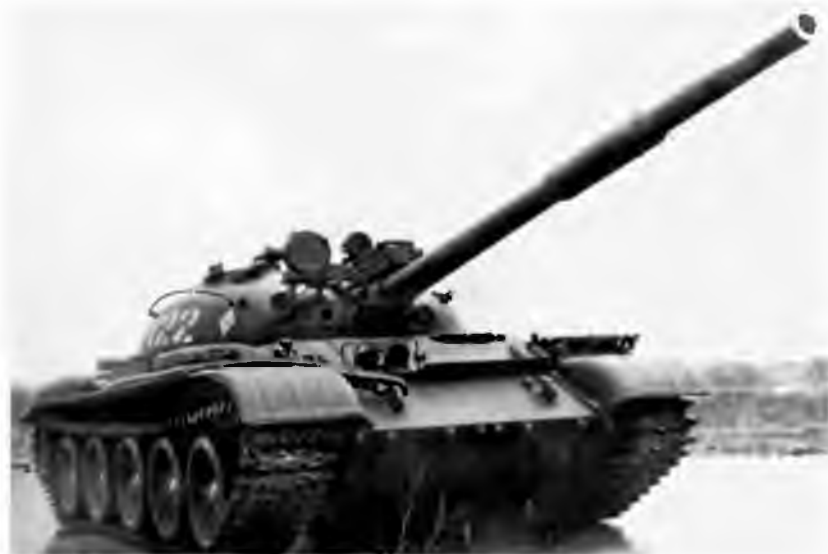
С 1975 года часть танков Т-62 была оснащена лазерным дальномером КДТ-1, устанавливавшимся над стволом пушки
