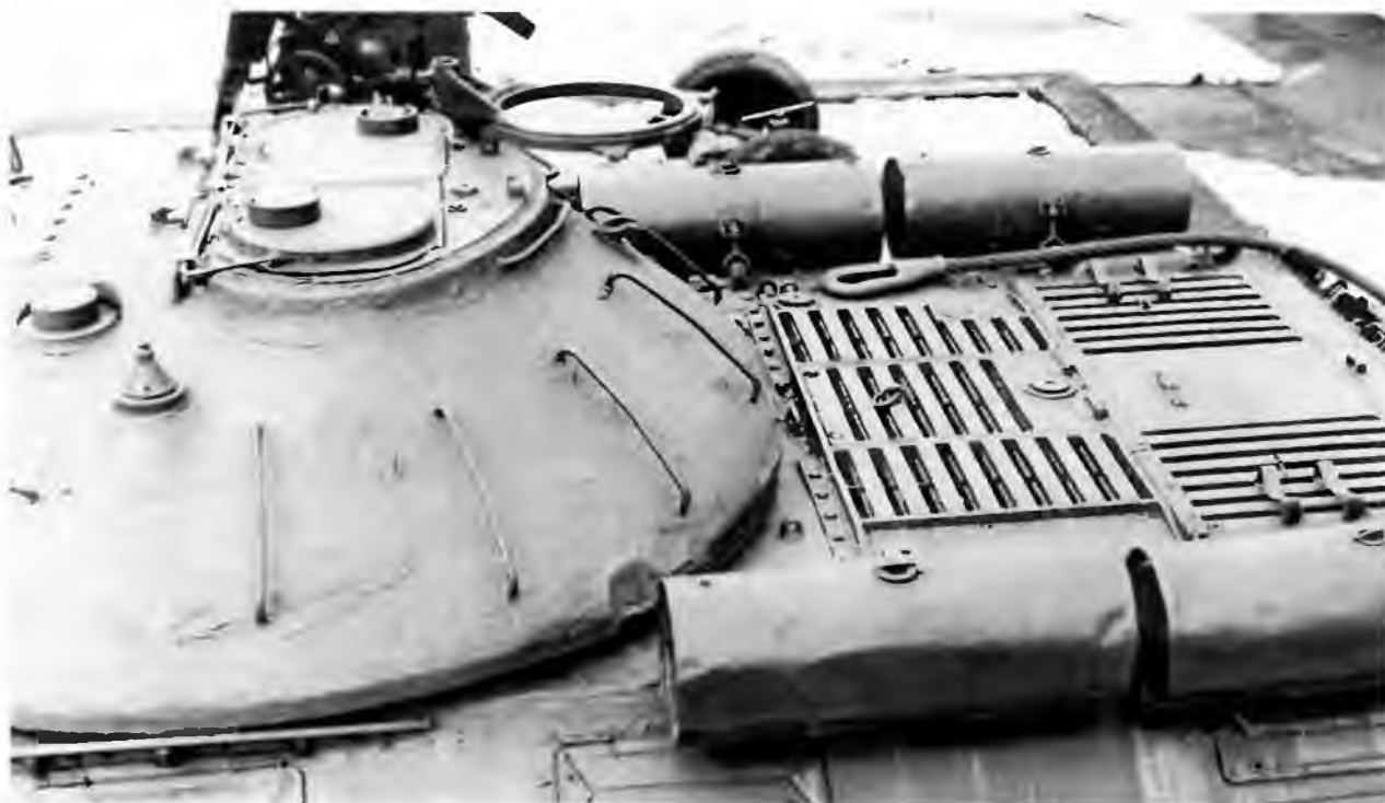
Вид на кормовую часть башни и крышу моторного отделения танка ИС-3М. Хорошо видны крышки башенных люков и приборы наблюдения членов экипажа. Обращает на себя внимание характерное расположение поручней для десанта
