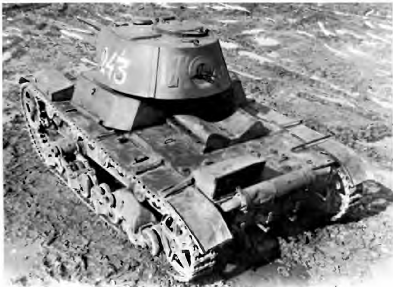
Легкий танк Т-26 обр. 1939 года с конической башней и наклонной броней подбашенной коробки
