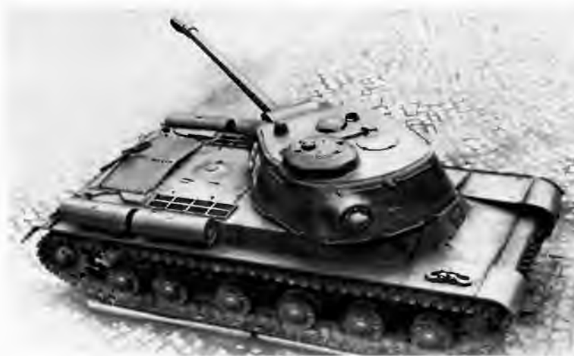
ИС-2 ранних выпусков 1944 года. Обращают на себя внимание характерные детали: литая лобовая часть с «ломаным» носом и люком-пробкой механика водителя; узкая амбразура пушки и броневой колпак перископического прицела ПТ4-17 перед командирской башенкой
