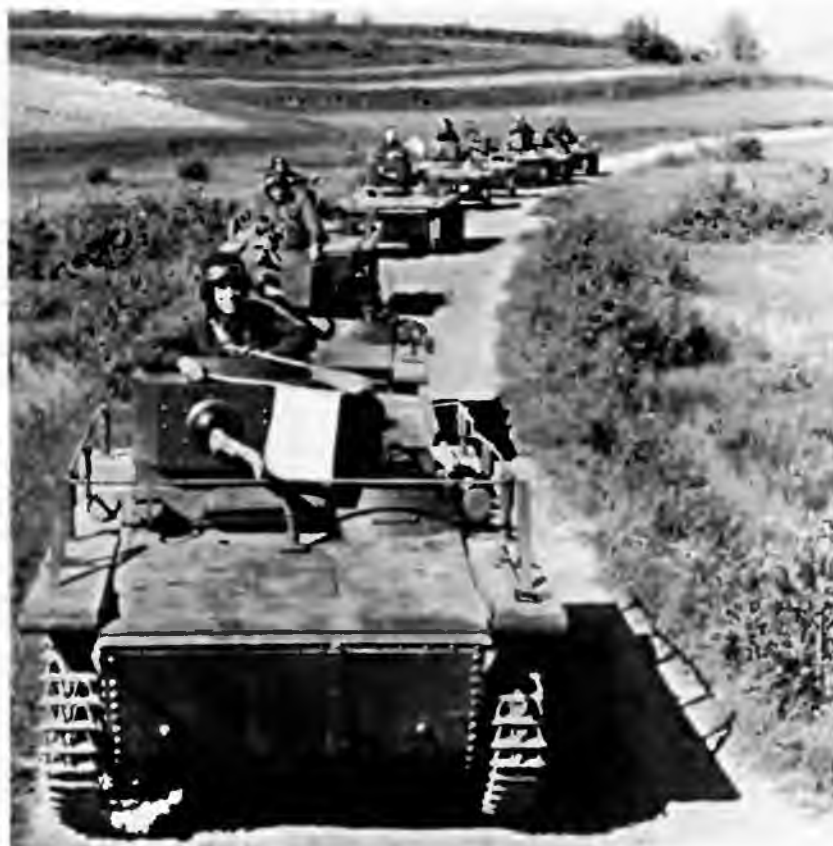
Подразделение танков Т-37А на марше. Впереди – командирский Т-37ТУ, оснащенный радиостанцией с поручневой антенной. Юго-Западный фронт, 1941 год
