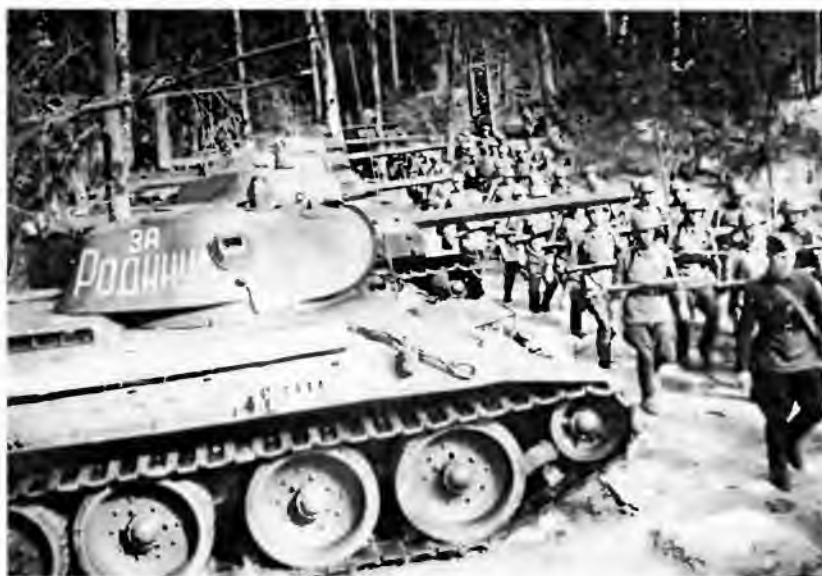
Танк Т-34 выпуска 1941 года с пушкой Ф-34. Хорошо видно, что только одна машина из пяти, стоящих в строю, оснащена радиостанцией. Второй танк вооружен пушкой Л-11. Август 1941 года
