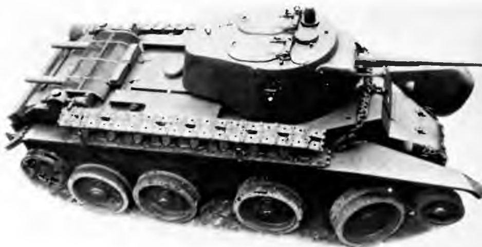
Танк БТ-7М на колесном ходу, гусеницы уложены на надгусеничных полках
