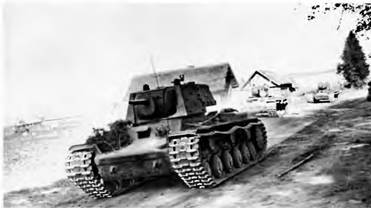
Колонна танков КВ. Головной — КВ-1 с дополнительным бронированием башни. Ленинградский фронт, 1941 год
