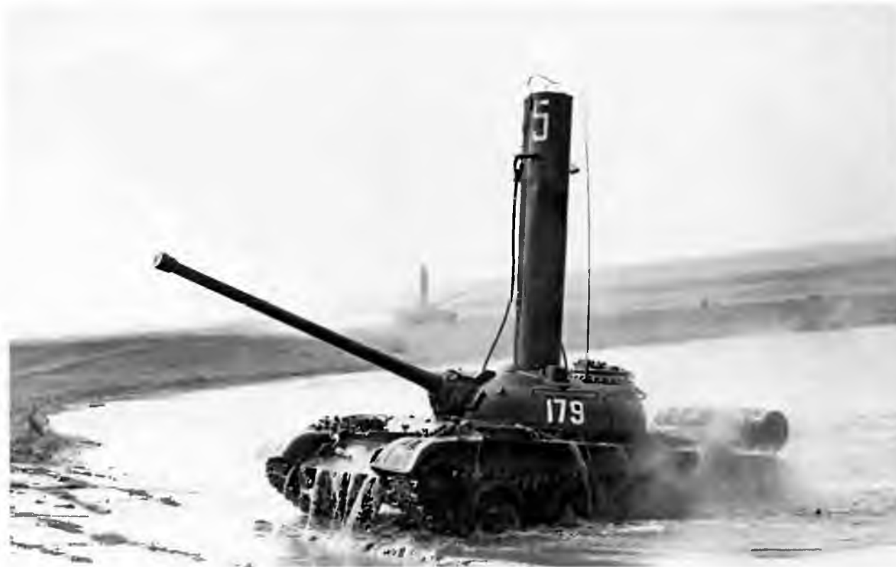
Средний танк Т-54 с установленной трубой-лазом после преодоления водной преграды по дну
