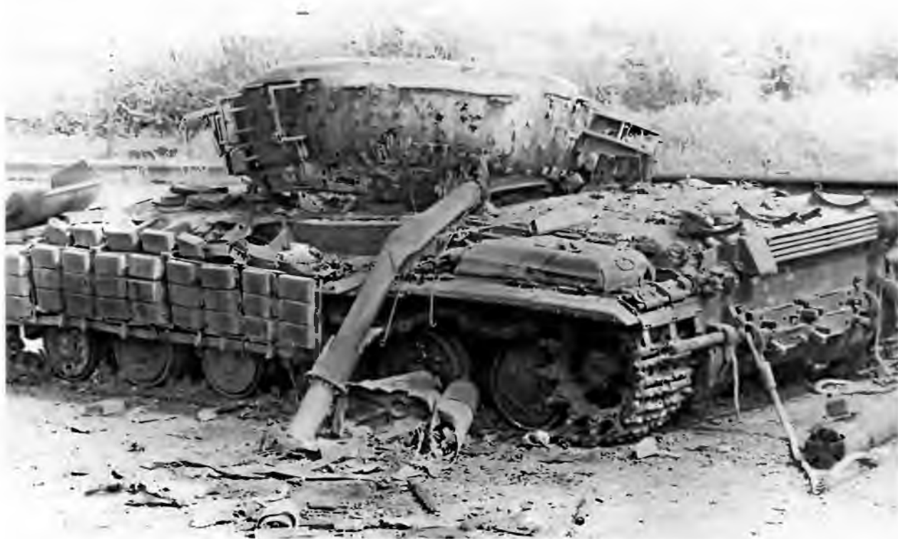
Танк Т-64БВ подбитый на окраине г. Бендеры. Приднестровье, июнь 1992 года. Башня танка сорвана взрывом боекомплекта
