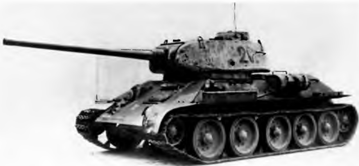
Т-34-85 завода «Красное Сормово». Промежуточная модель, сохранившая часть характерных деталей ранних сормовских машин — смещенный вперед наружный топливный бак и рымы из прутка
