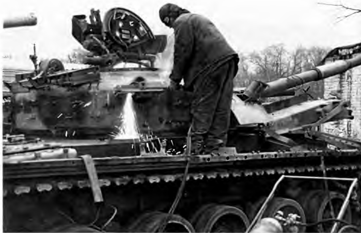
Краснодарский край, Центр ликвидации бронетанковой техники в станице Кучуевской. Идет разделка последнего танка (это Т-80УД) по договору о сокращении обычных вооруженных сил в Европе. Осень 1995 года
