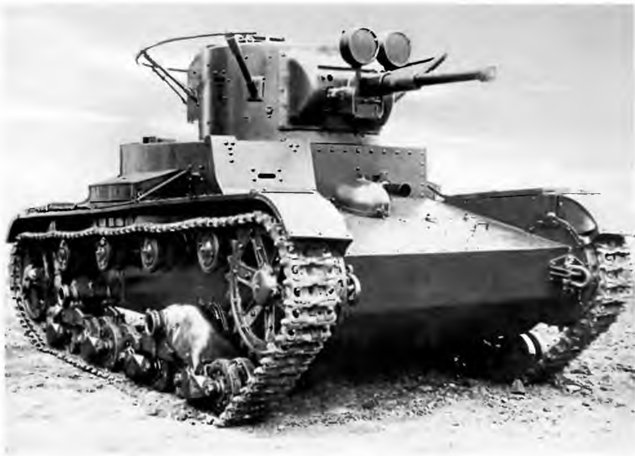
Танк Т-26 выпуска 1937 года. Машина имеет сварной корпус, новый щиток механика-водителя, штампованную маску пушки и фары боевого света
