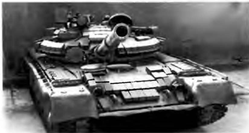
Танк Т-80БВ с комплектом навесной динамической защиты. Дымовые гранатометы перенесены с лобовой части башни на борта. Ящик для имущества экипажа навешен на ограждение для укладки укрывочного брезента вместе с ящиком для изолирующего противогаса АТ-1
