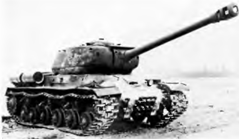
ИС-2 поздних выпусков 1944 года с измененной носовой частью корпуса, расширенной амбразурой пушки и запасными траками на нижнем лобовом листе корпуса
