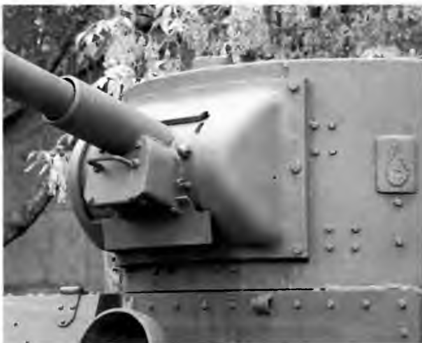
Маск-установка 45-мм пушки и спаренного пулемета (его амбразура справа от орудия и на фото не видна) со штампованным лобовым щитом. На бортах башни видны основания кронштейнов для крепления поручневой антенны
