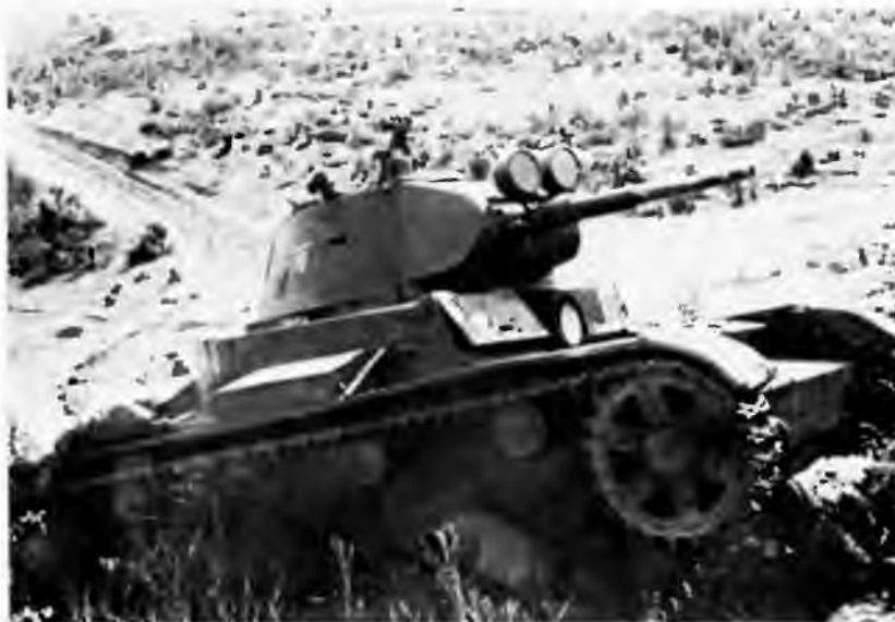
Легкий танк Т-26 обр. 1938 года с конической башней. На маске пушки установлены прожекторы «боевого света»
