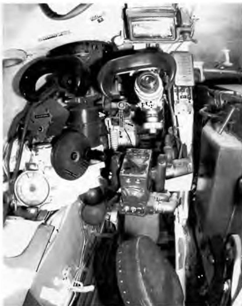
Рабочее место наводчика. Обращает на себя внимание расположение прицелов. Справа — телескопический прицел ТШ2Б-41, слева — перископический ночной прицел ТПН-1
