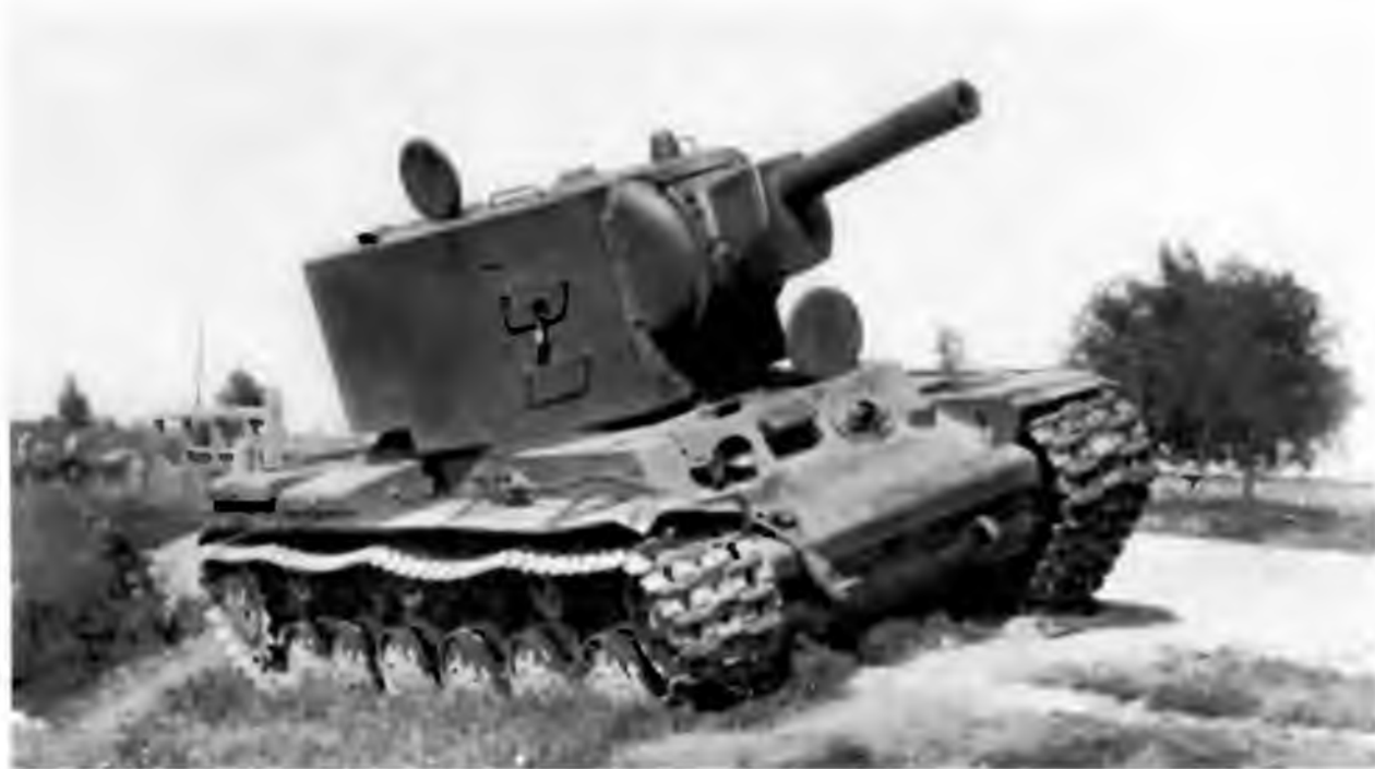
KV-2, оставленный на обочине дороги из-за поломки или отсутствия топлива. Хорошо видна грушевидная заглушка амбразуры для стрельбы из личного оружия
