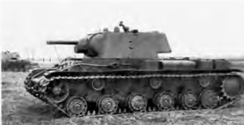
Танк КВ-1 с упрощенной башней, изготовленный на Кировском заводе в Ленинграде осенью 1941 года
