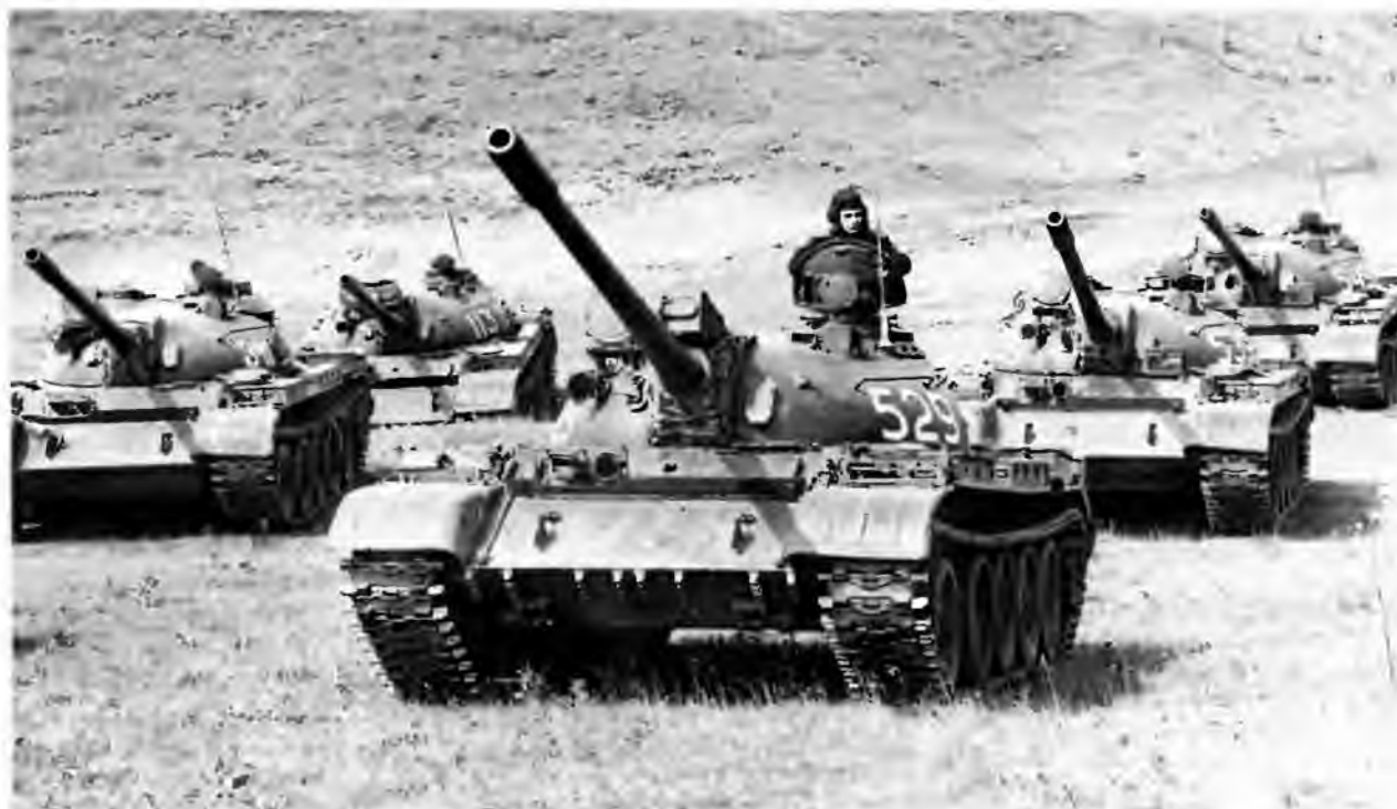
Средние танки Т-55 и Т-55А. Некоторые машины оборудованы лазерными дальномерами КДТ-1
