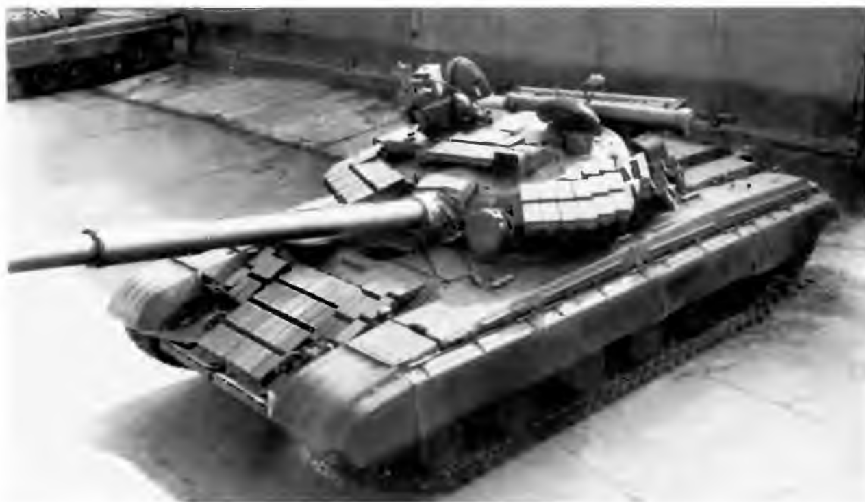
Основной танк Т-64Б с установленным КДЗ
