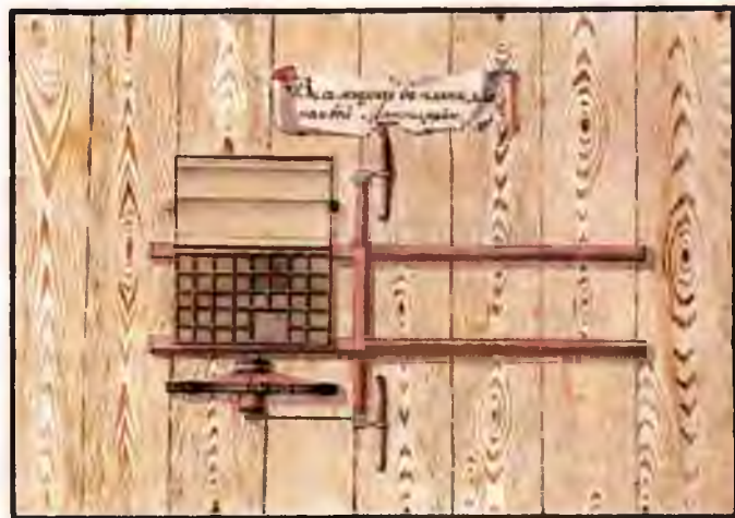
Зарядный ящик для перевозки зарядов и снарядов (вид сбоку и сверху). Старинная акварель.
