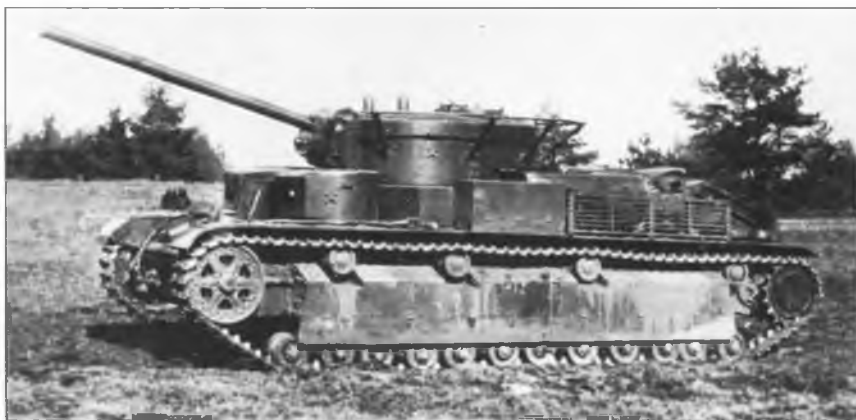
95-мм танковое орудие Ф-39 в башне танка Т-28 на испытаниях возкой. 1940 г.
