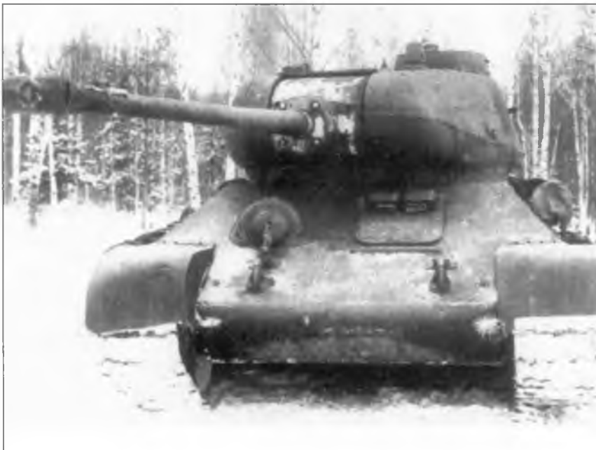
85-мм пушка ЛБ-1 в увеличенной башне танка Т-34 на испытаниях. 1943 г.
