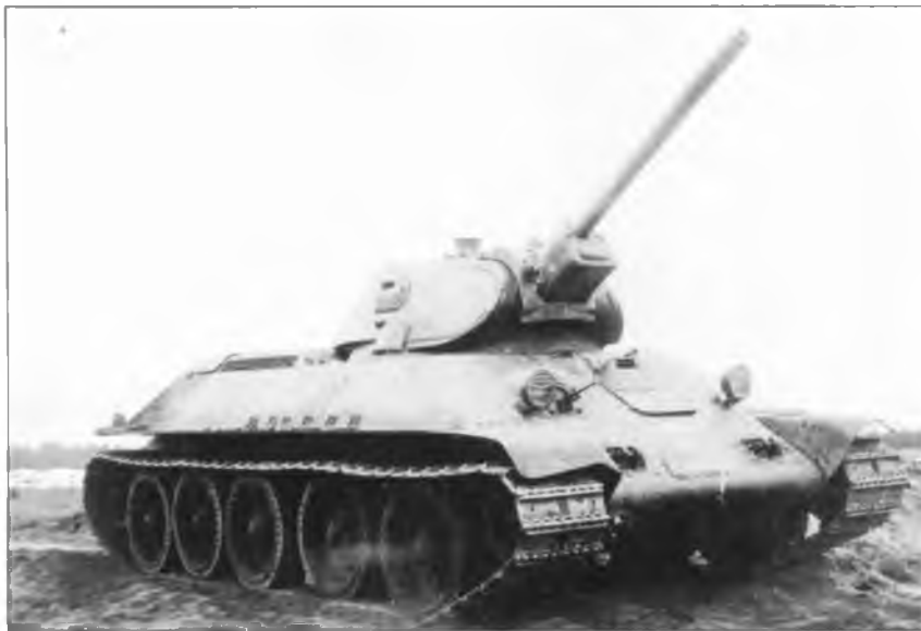
Испытания опытного образца 76,2-мм пушки Ф-34 в башне танка Т-34. 1940 г.
