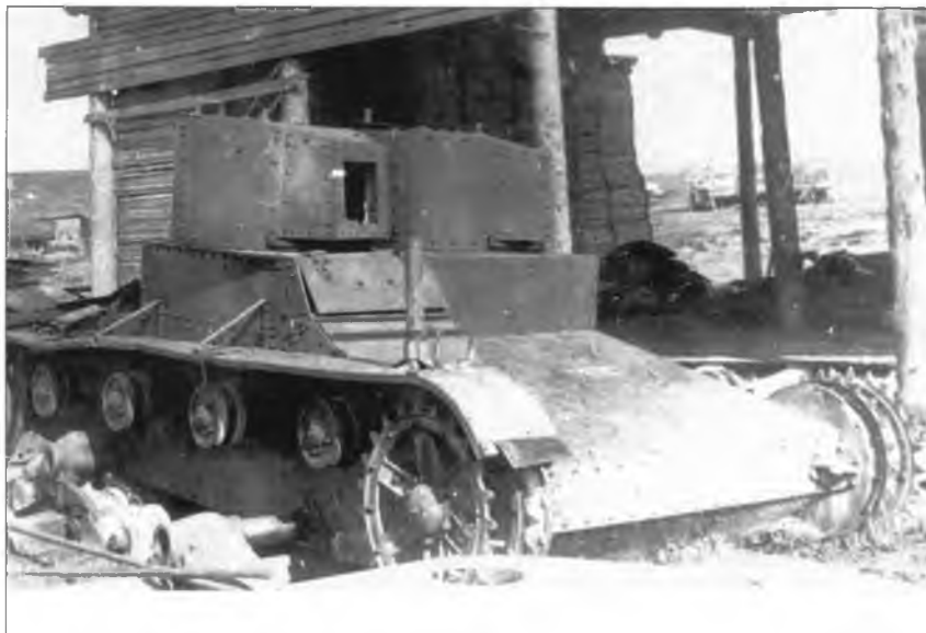
Корпус танка «Виккерс», подготовленный для обстрела его бронебойными пулями. Завод им. Орджоникидзе, август 1931 г.
