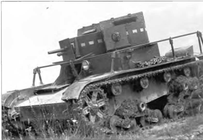
Танк Т-26 с пушечно-пулеметным вооружением и радиостанцией № 7 на испытаниях, 1933 г.
