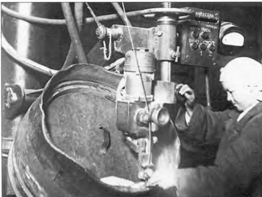
Приварка обода под крышу командирской башенки. Завод № 183, 1944 г.
