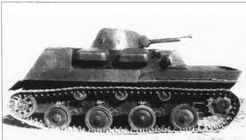
Танк «010» № 7/4 с торсионной подвеской на испытаниях
