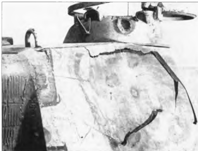
Борт башни танка «Пантера», расколовшийся от разрыва фугасных снарядов.
