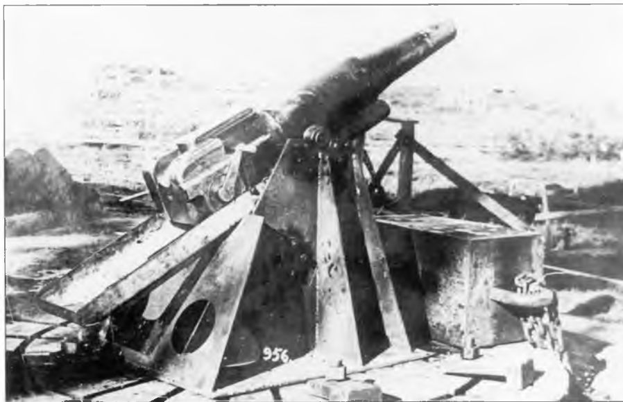
76-мм танковая пушка ПС-3 на полигонном станке. 1935 г.
