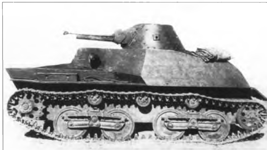
Танк «010» № 6/2 с тележечной подвеской на испытаниях
