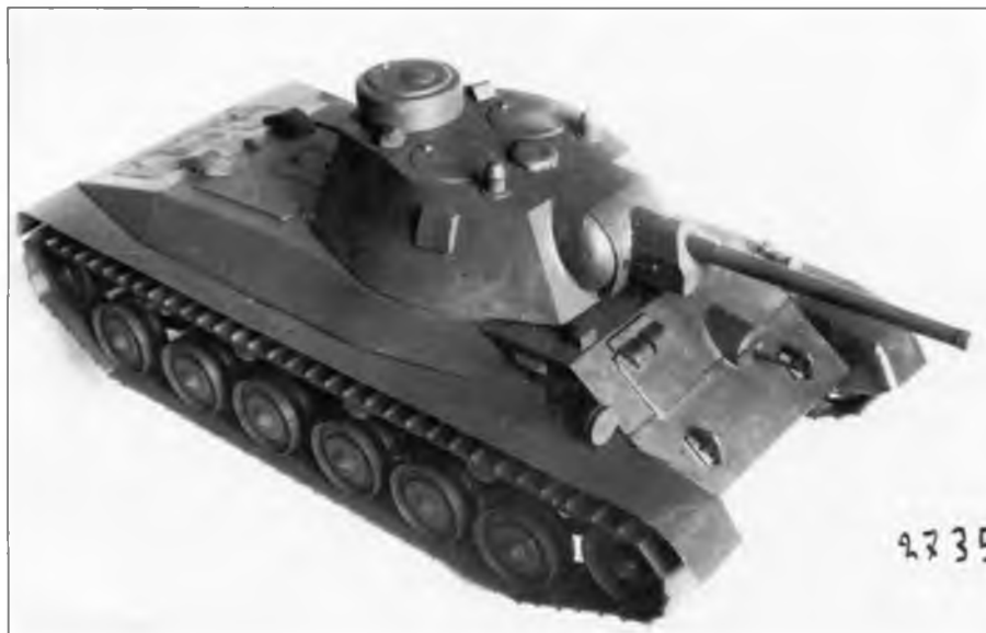
Деревянный макет танка Т-34м (А-43) сверху. 1941 г.
