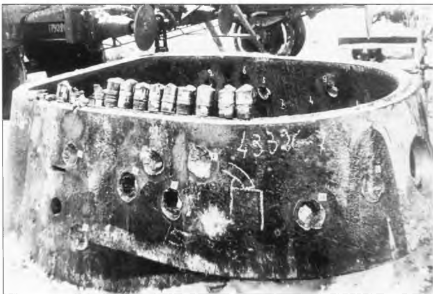
Пробная отливка башни танка КВ. 1941 г.
