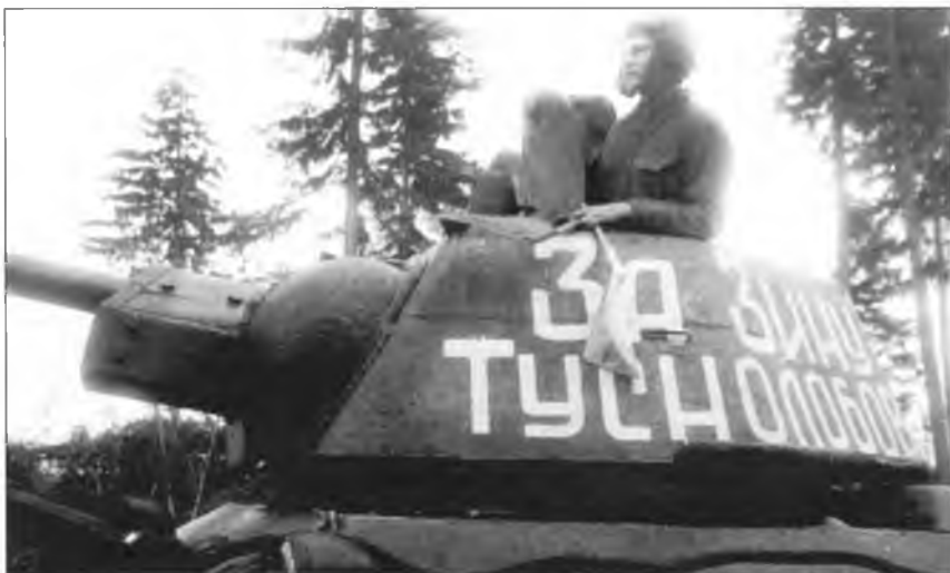
Танк Т-34 с литой шестигранной башней образца 1942 г.
