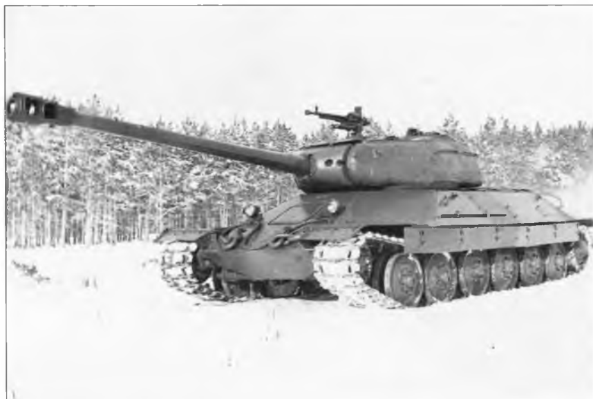
Испытания танка ИС-6 («Объект 252») с механической трансмиссией. Ноябрь 1944 г.
