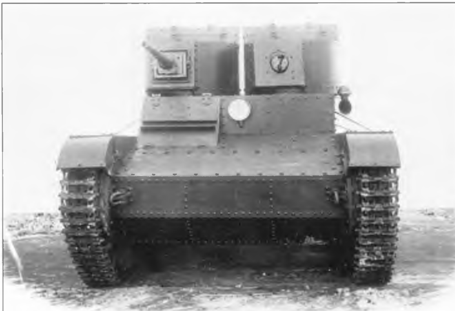
Танк Т-26 с 37-мм пушкой Б-3 (5К) в правой башне, 1933 г.
