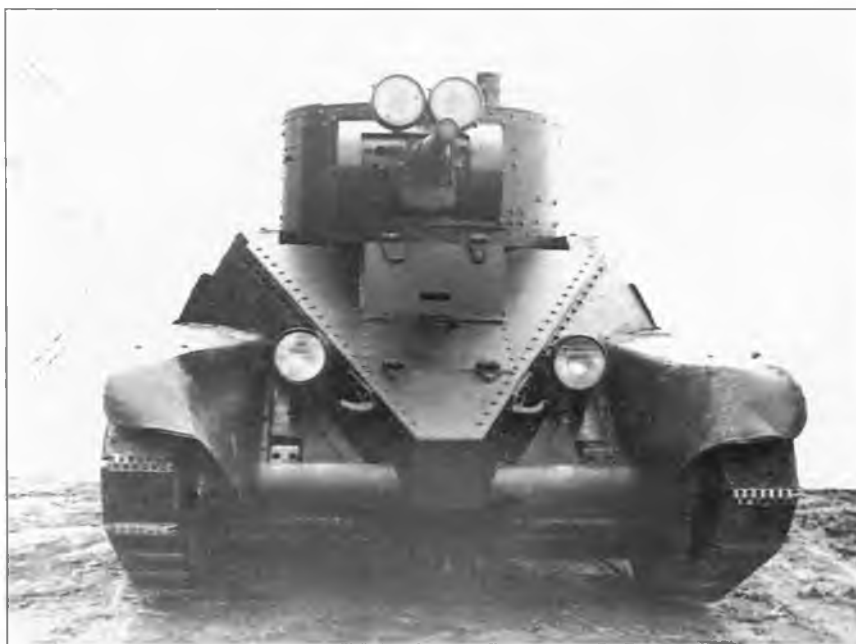
Вид спереди танка БТ-5-ИС с наклонными бортами, 1938 г.
