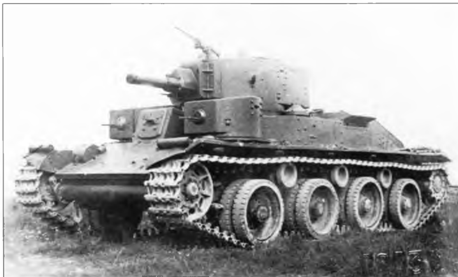
Эталонный танк Т-29, вооруженный 76,2-мм пушкой Л-10. 1938 г.
