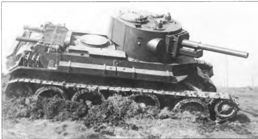
Танк БТ-7А, вооруженный 76,2-мм пушкой Ф-32, на испытаниях. 1940 г.
