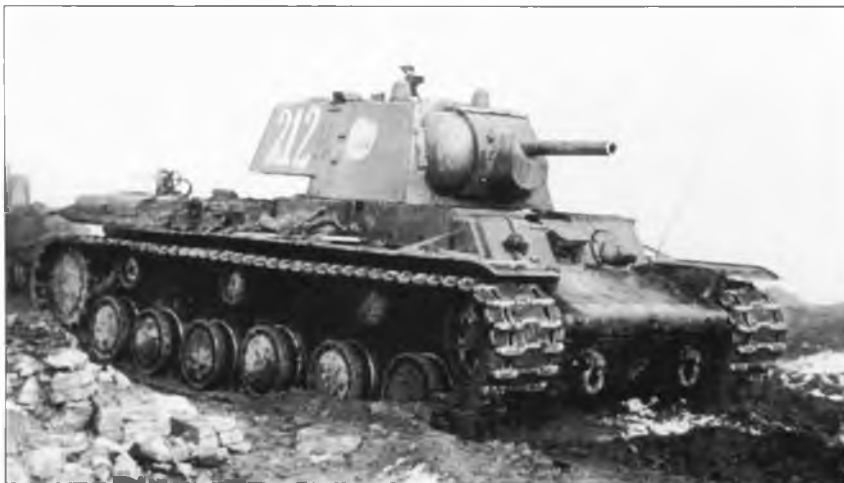
Танк КВ-1 с граненой башней и 76,2-мм пушкой Ф-32. 1941 г.
