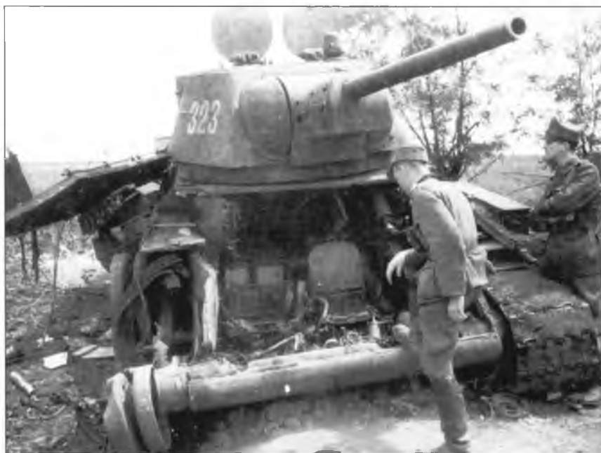
Лобовой и бортовой листы этого танка Т-34 оторваны внутренним взрывом. Лето, 1943 г.
