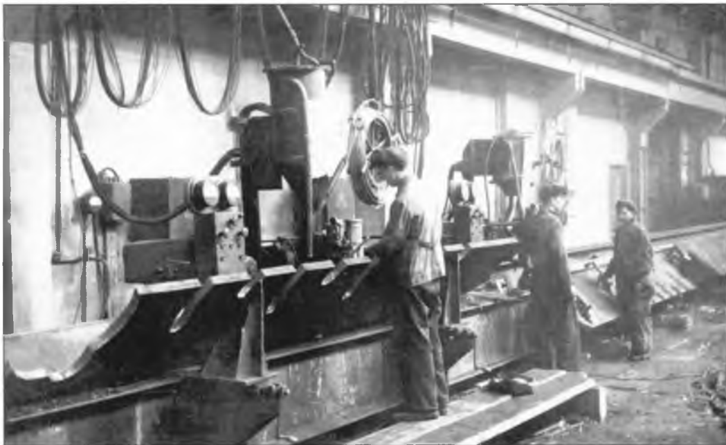
Участок автоматической сварки корпусов. Завод № 183, 1943 г.
