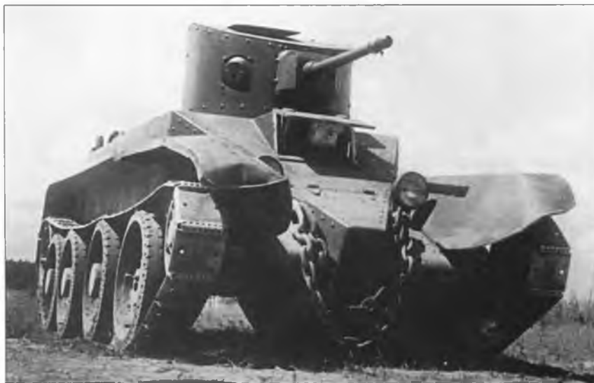
Танк БТ-2 с пушечно-пулеметным вооружением.
