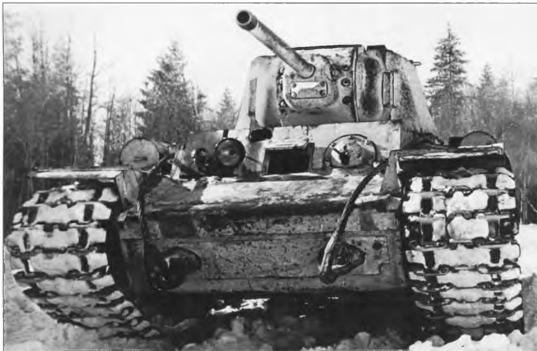
Танк КВ-1 с литой башней на фронте. Зима 1942 г.
