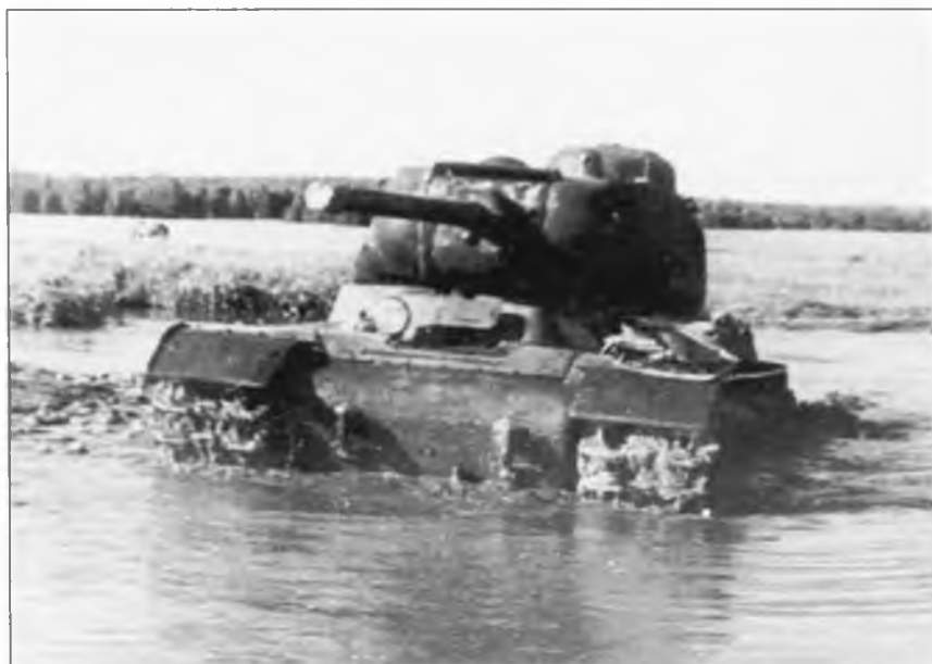
Испытания танка ИС-85 № 1 с 85-мм пушкой С-31 под Челябинском. 1943 г.
