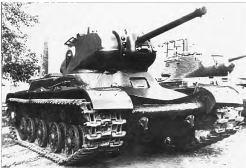
Танк KB-13 с траками танка KB. 1942 г.
