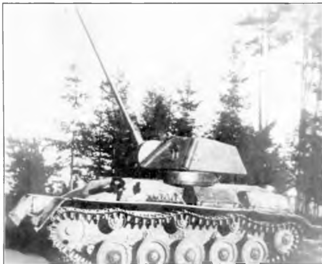
Испытания 45-мм пушки ВТ-43 в танке Т-80, август 1943 г.
