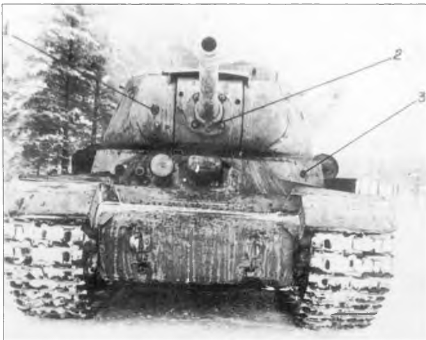
Танк ИС-85, подбитый у Лысянки. Цифрами показаны попадания немецких снарядов 1944 г.
