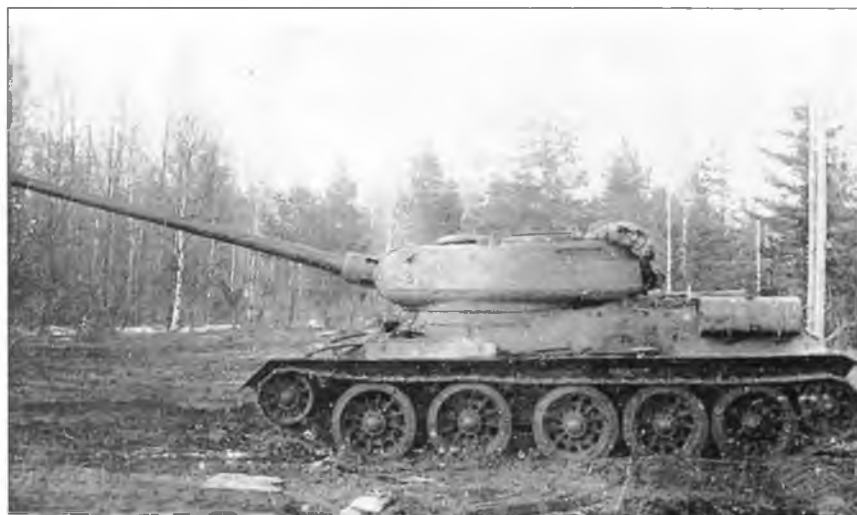
Т-34-100, вооруженный 100-мм пушкой Д-10Т на испытаниях. 1945 г.
