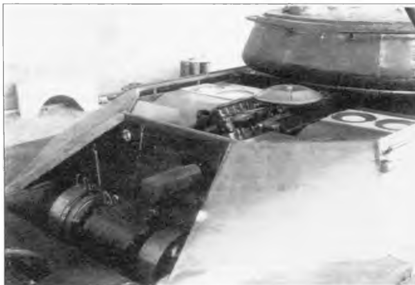
МТО ИС-6, скомпонованное в деревянной модели танка.
