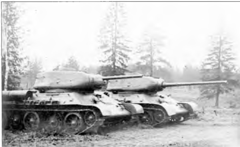
Танки Т-34 с башней на погоне 1600 мм с вооружением из 76-мм пушки Ф-34М и 85-мм пушки Д-5Т. Осень 1943 г.
