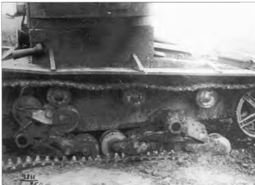
Разрушение ходовой части Т-26-4 после стрельбы из пушки ПС-3, октябрь 1933 г.
