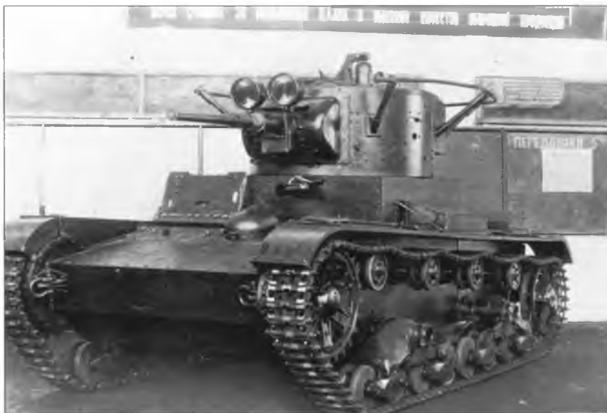
Танк Т-26 выпуска 1936 г. со сварным корпусом и штампованным щитком (маской) башни.
