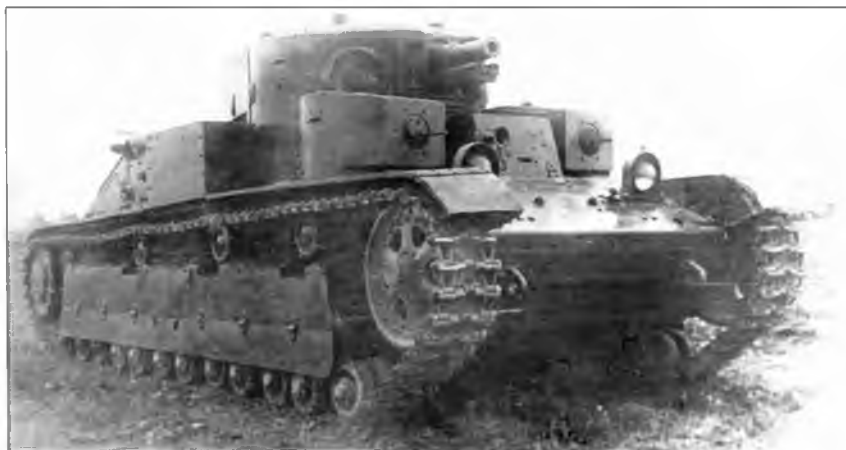
Серийный танк Т-28, вооруженный 76,2-мм пушкой КТ, 1933 г.
