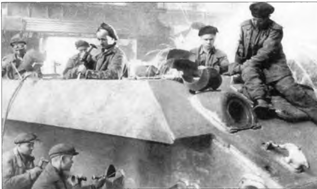
Зачистка бронекорпуса Т-34 после сварки, завод № 183, весна 1943 г.
