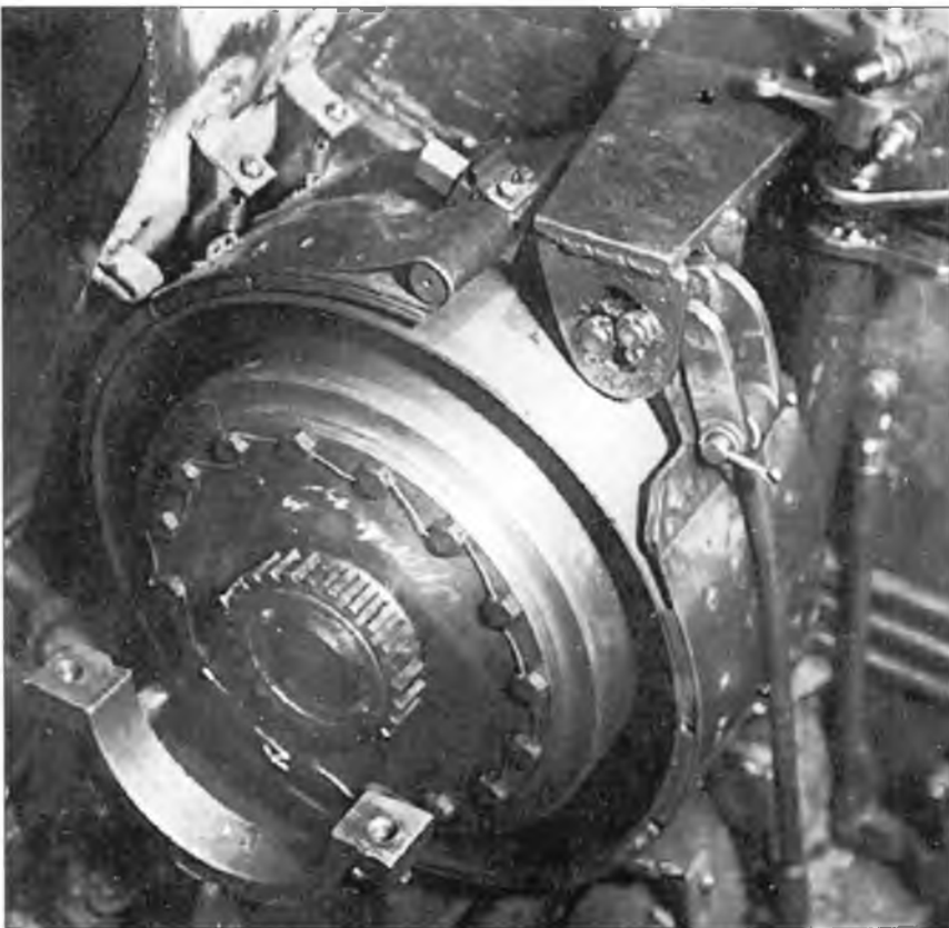
Тормоз танка Т-44а
