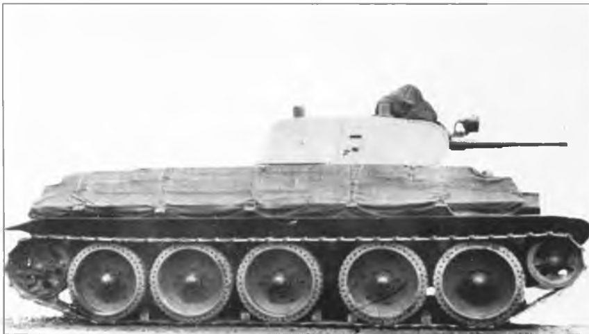
Догруженный балластом танк А-32 №2, вид сбоку. 1939 г.
