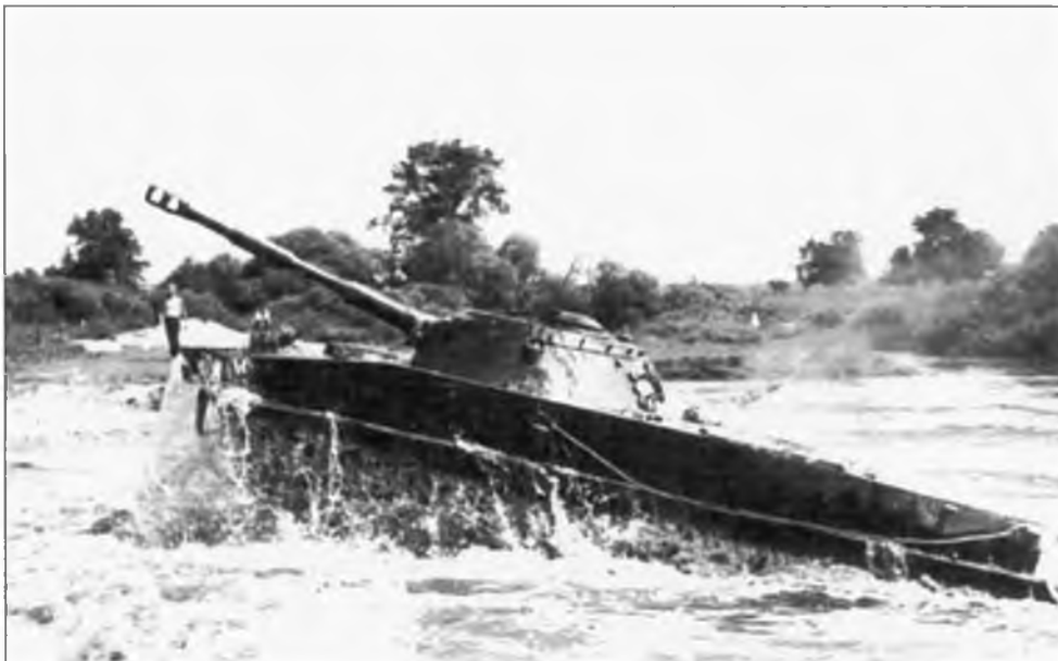
Танк ПТ-76 с 76-мм орудием Д-56ТМ выпуска после 1954 г.
