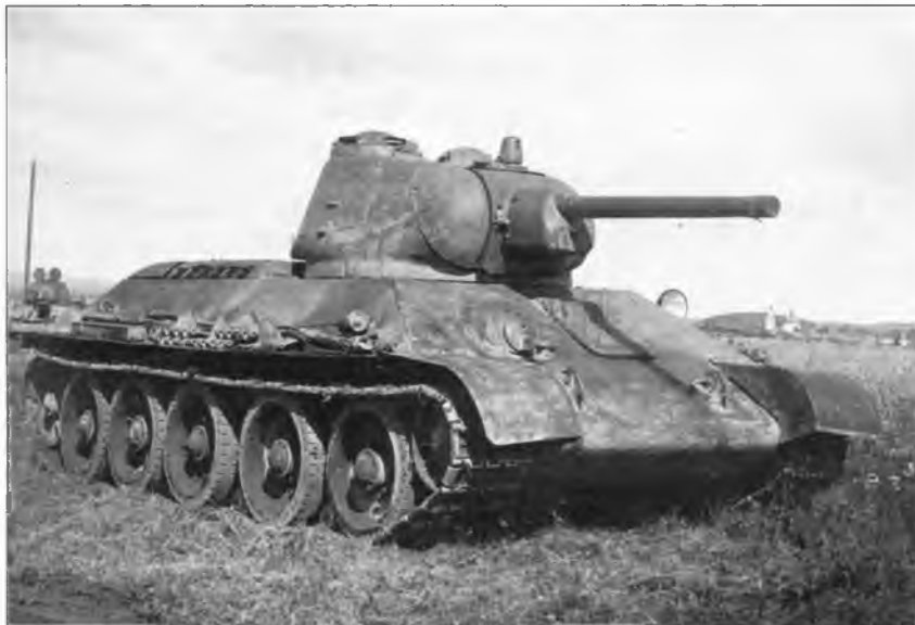
Испытания танка Т-34 с башней танка Т-43 первого варианта. 1942 г.
