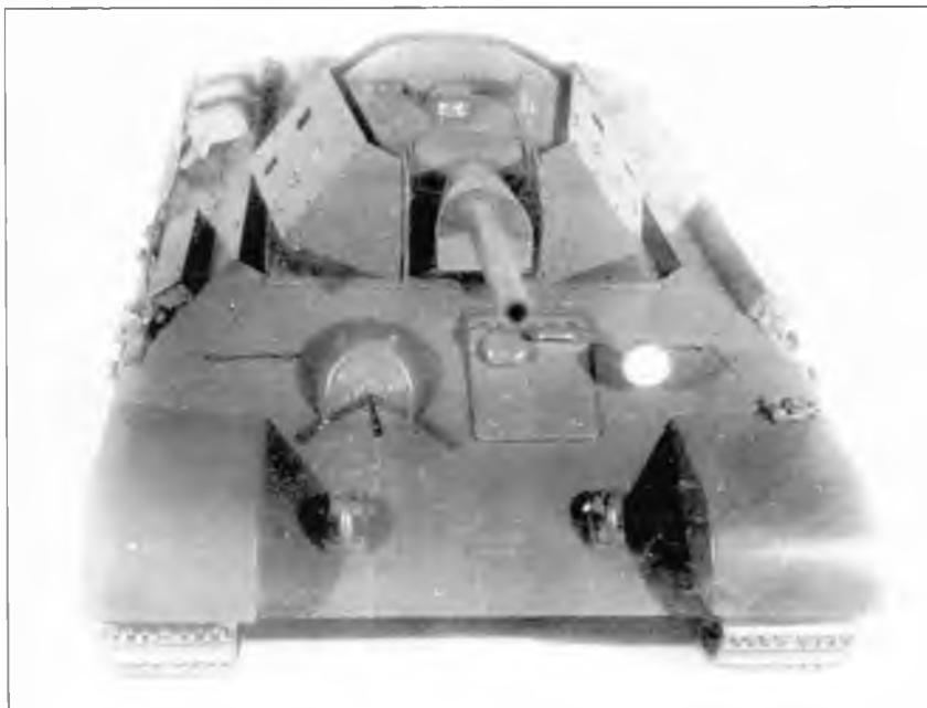
Макет экранирования Т-34 группы И. Бурцева спереди. 1943 г.
