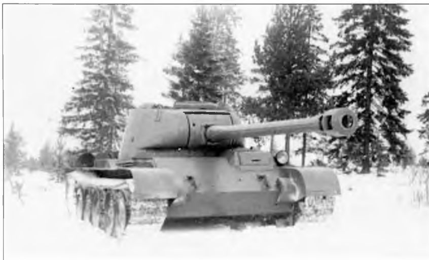
Третий прототип Т-44, вооруженный 122-мм орудием Д-25-44
