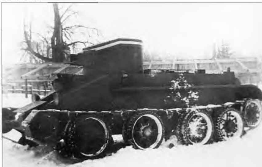
Танк БТ-2 с вооружением из пулеметной спарки в башне, 1933 г.
