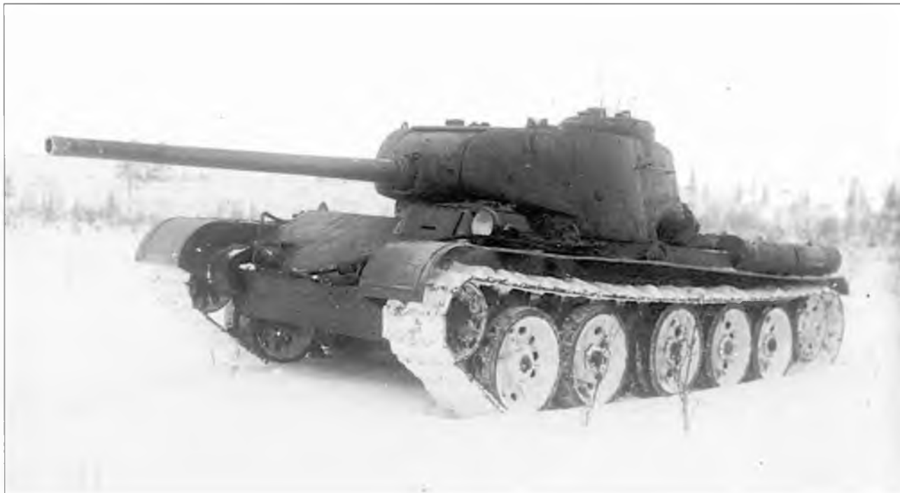
Второй прототип Т-44 с башней на увеличенном погоне, январь 1944 г.
