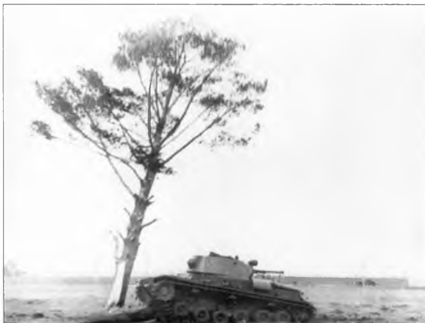
Танк Т-111 (Т-46-5) валит дерево на заводских испытаниях, 1938 г.
