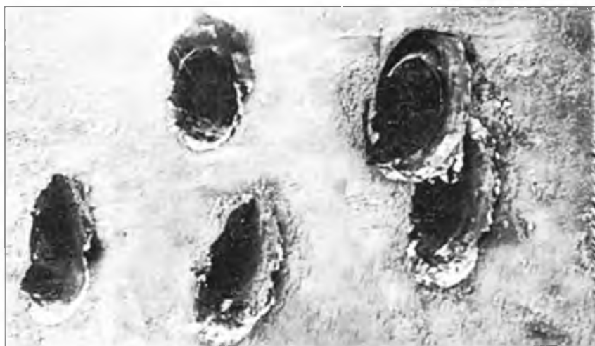
Вырезанный фрагмент 32-мм бортовой брони танка PzKpfw III после обстрела серией из пяти 45-мм снарядов (2 пробоины). Угол встречи около 30 градусов. 1940 г.
