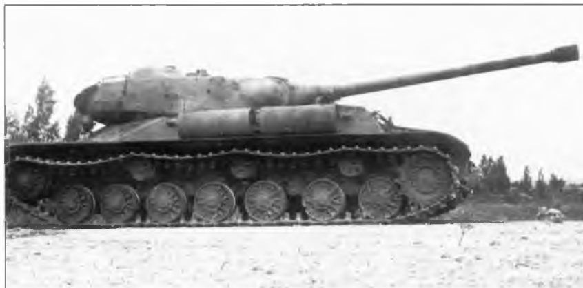
Танк «Объект 701» № 3 со 100-мм орудием С-34-1.
