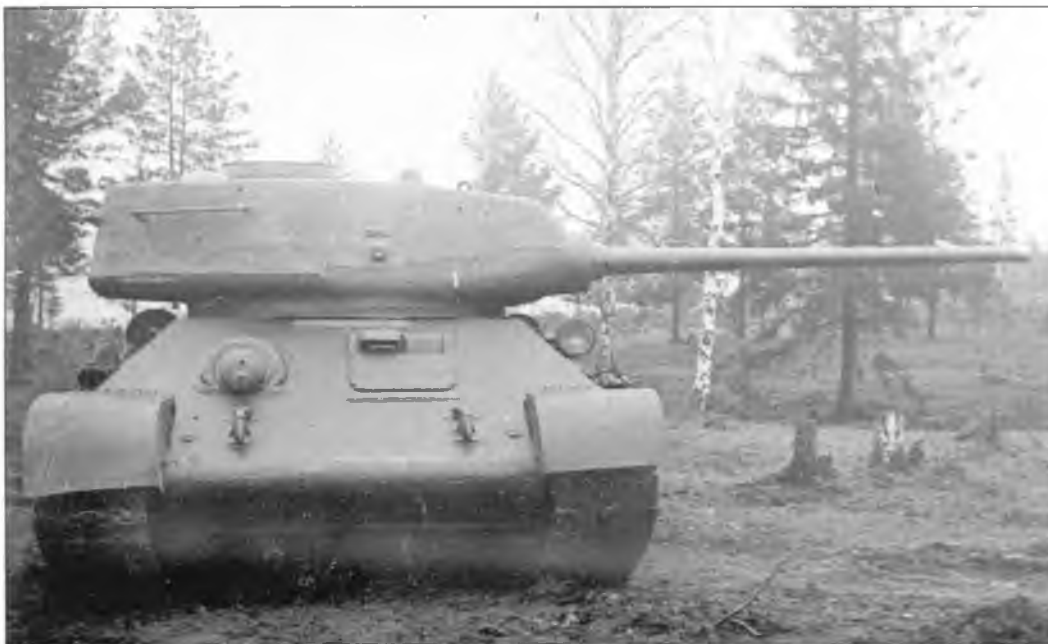
Танк Т-34 с 85-мм орудием Д-5Т в башне Т-43. 1943 г.
