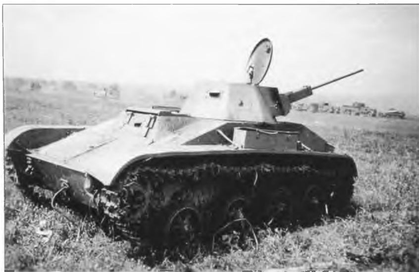
Танк Т-60 с литой башенкой водителя. Южный фронт, 1942 г.
