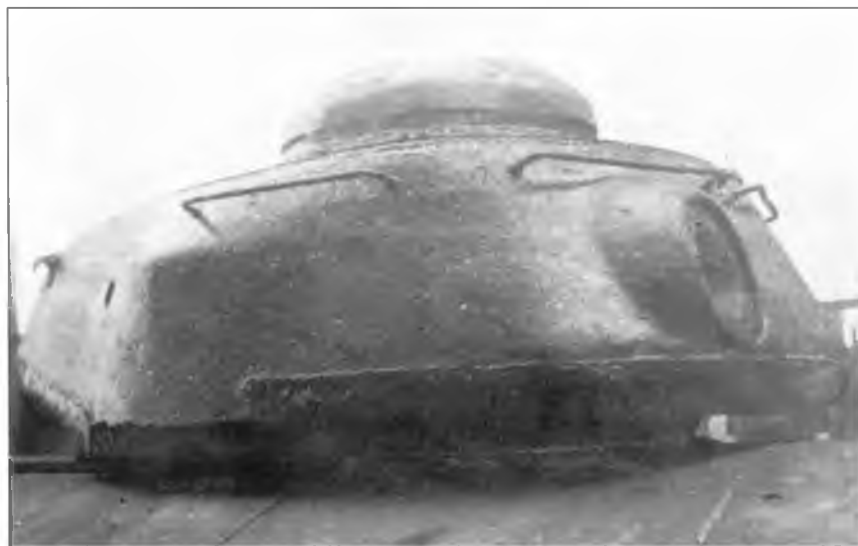
Серийная башня ИС-2 перед подачей на сборку. 1944 г.
