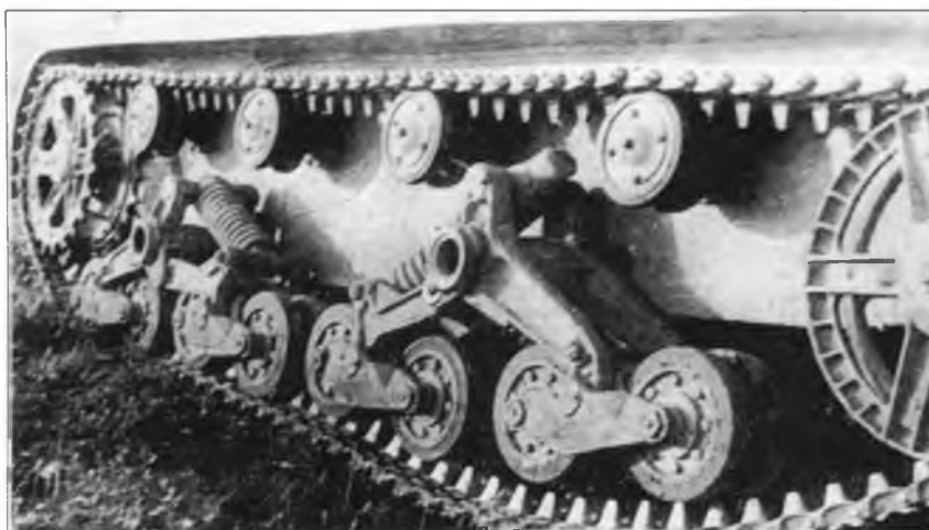
Подвеска Переверзева на опытном образце танка Т-26-5. 1940 г.
