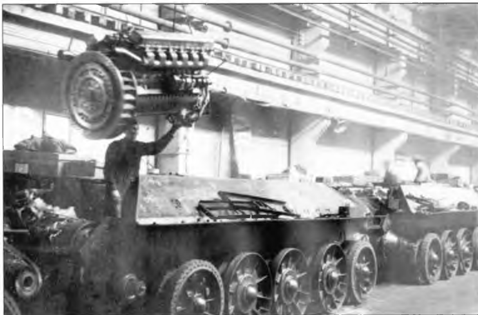
Монтаж двигателя В-2 в МТО Т-34. Конвейер завода № 183, весна 1943 г.
