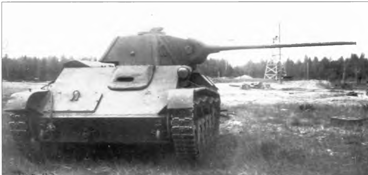
Проверка максимального бортового габарита орудия ВТ-42 для оценки маневренности танка Т-70М. Лето 1943 г.
