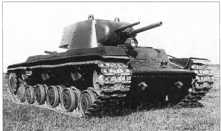
Первый экземпляр танка КВ. В башне — два орудия. Осень 1939 г.
