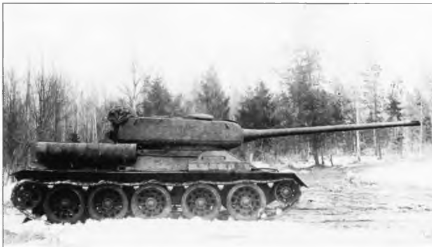
Т-34-100, вооруженный 100-мм пушкой ЛБ-1, на испытаниях. 1945 г.
