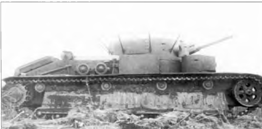
Танк Т-28, вооруженный 76,2-мм пушкой Л-11. 1939 г.
