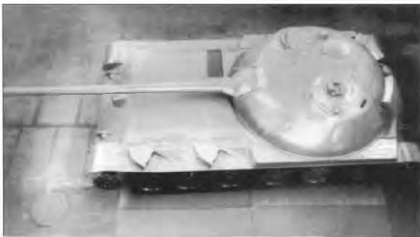
Опытный образец танка «Объект 416» со 100-мм орудием Д-10Т. 1950 г.
