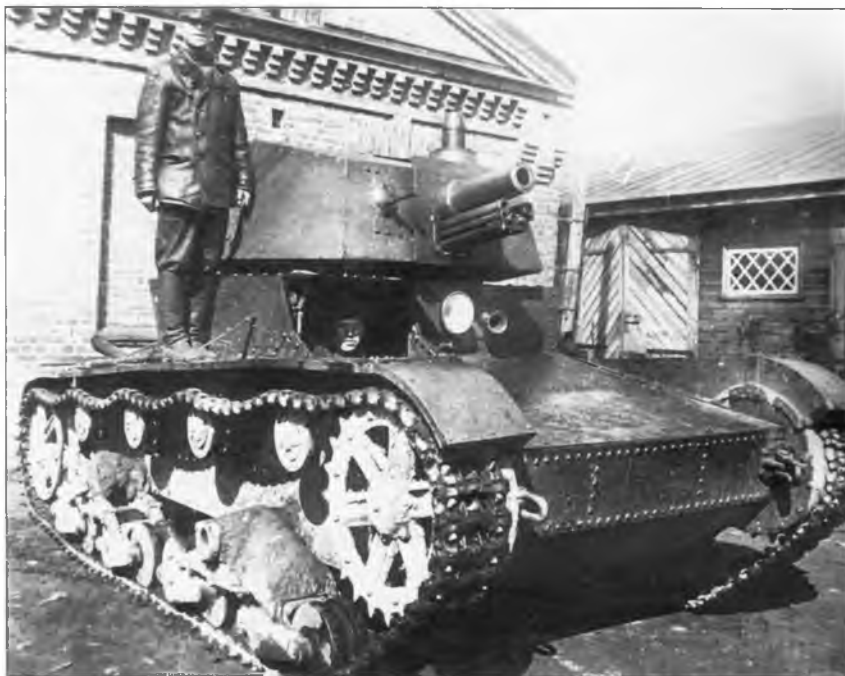
Танк Т-26 со сварной башней А-43 Н. Дыренкова, 1932 г.
