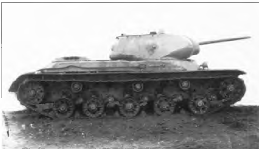
Танк KB-13 с траками танка Т-34. Вид справа. 1942 г.
