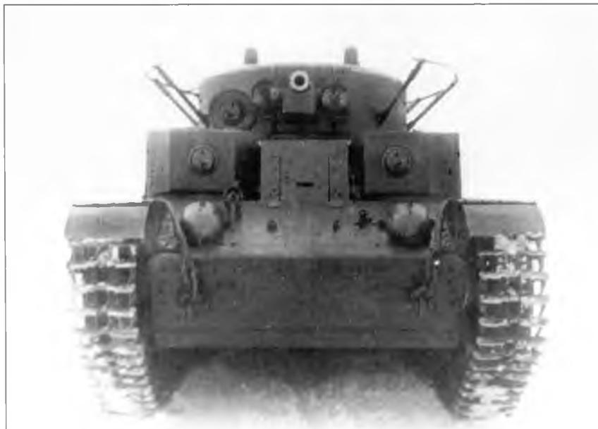
Вид спереди на танк Т-28, оснащенный фарами боевого света, 1933–1934 гг.
