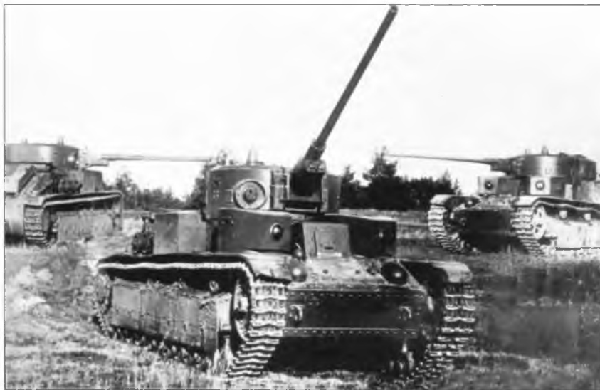
85-мм пушка Ф-30 в башне танка Т-28 на испытаниях возкой. Коллаж из отчета ГАУ, 1939 г.
