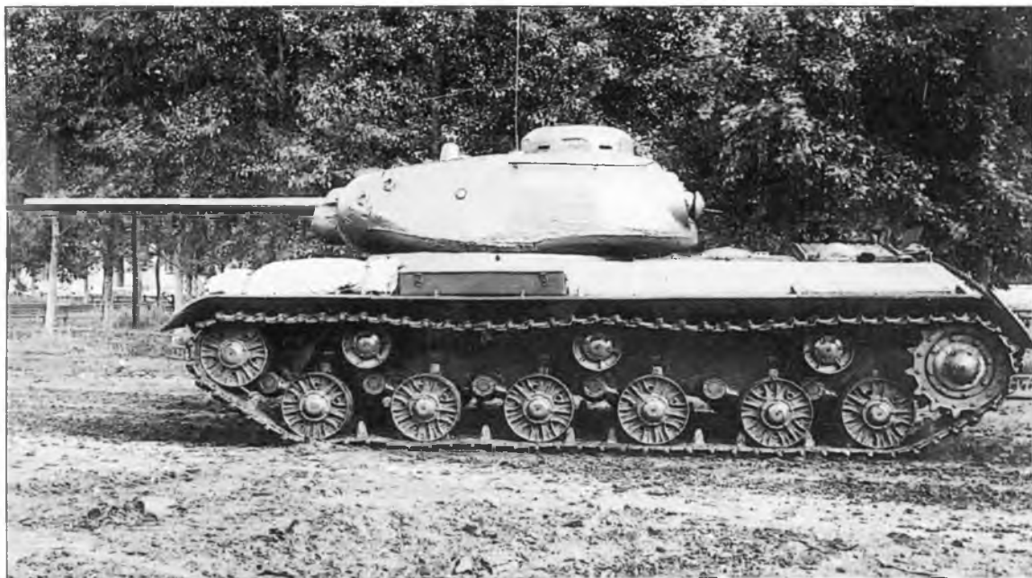
Опытный образец танка ИС «образец № 3» с 85-мм пушкой С-31. Лето 1943 г.
