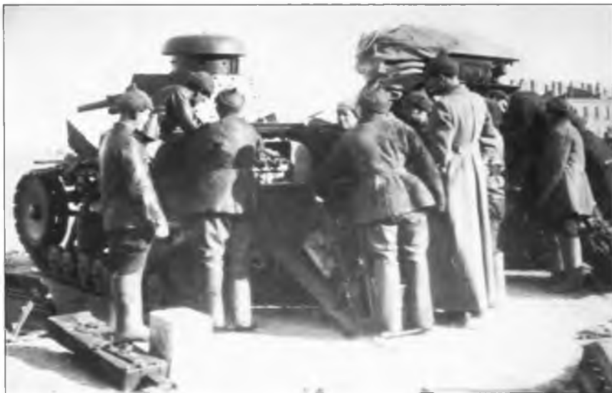
Ремонт и обслуживание танков МС-1. ОДВА, ноябрь 1929 г.
