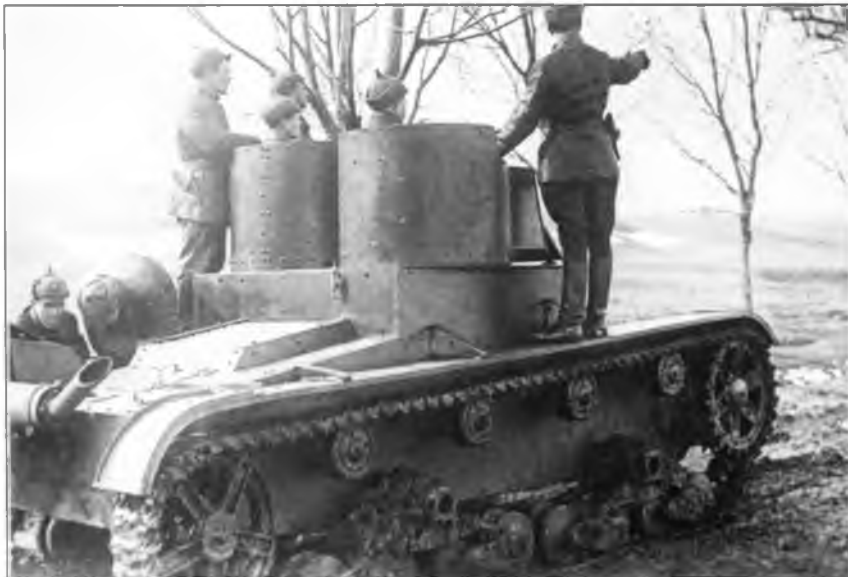
Танк Т-26 выпуска 1932 г. со сварным корпусом и сварной правой башней. Маневры МВО, 1933 г.
