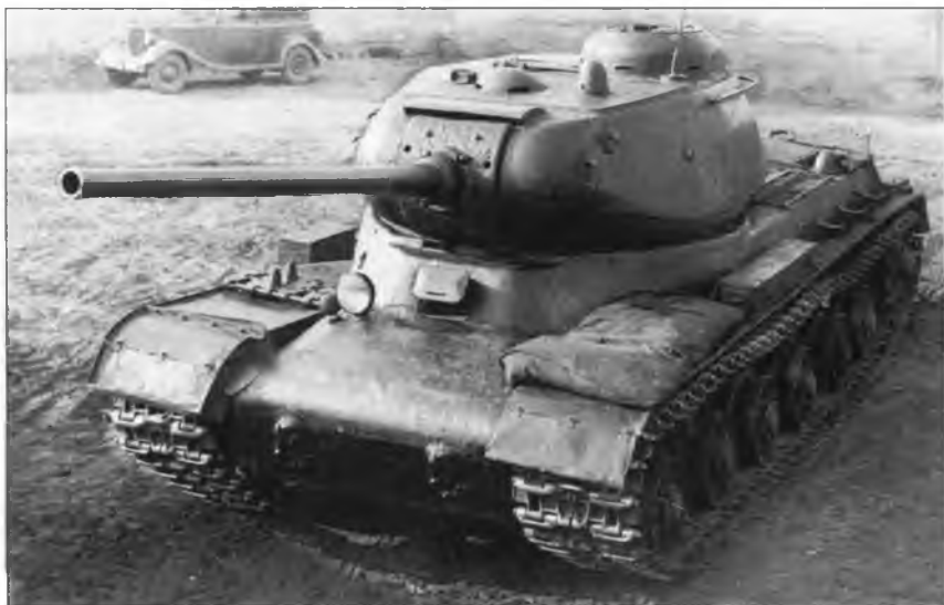
Танк ИС-85 («Объект 237») с 85-мм пушкой Д-5Т. Лето 1943 г.
