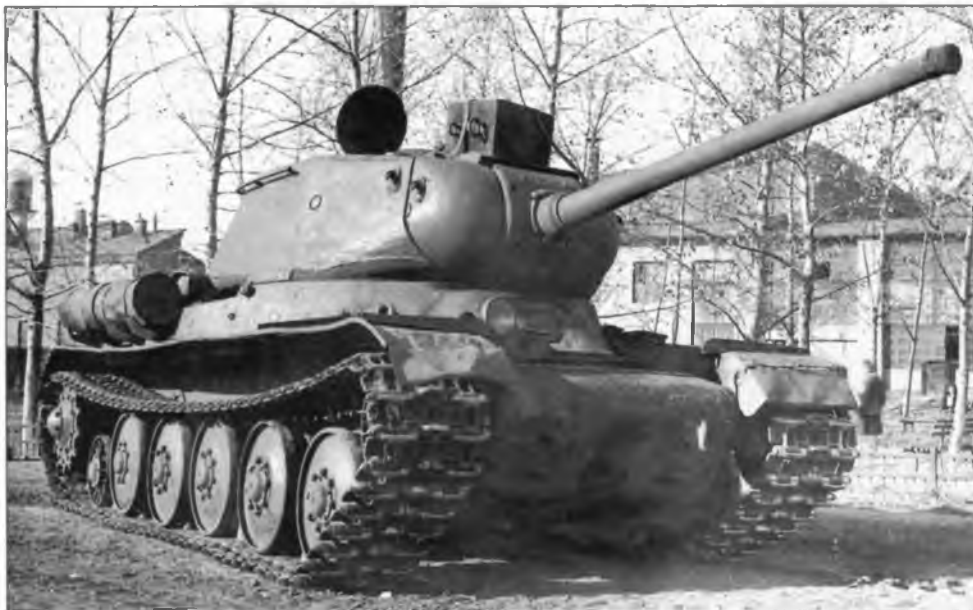
Именно в этом танке прошли испытания 85-мм пушки большой мощности Д-5Т-85БМ. 1944 г.
