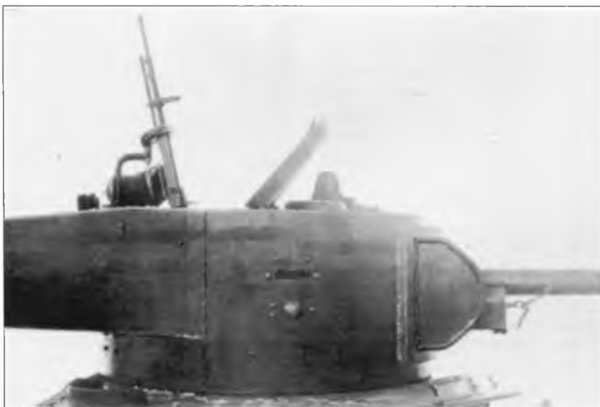
Шкворневая установка зенитного пулемета на башне Т-26, 1936 г.
