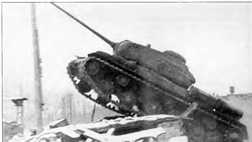
Испытания танка ИС-85 № 2 с 85-мм пушкой Д-5Т под Челябинском. Лето 1943 г.
