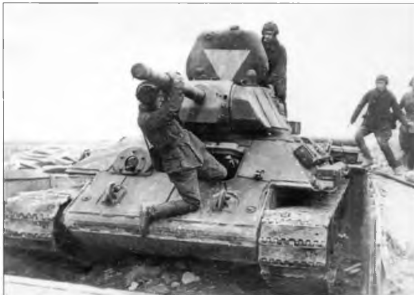
Экранированный Т-34 завода № 112 на фронте. Осень 1942 г.
