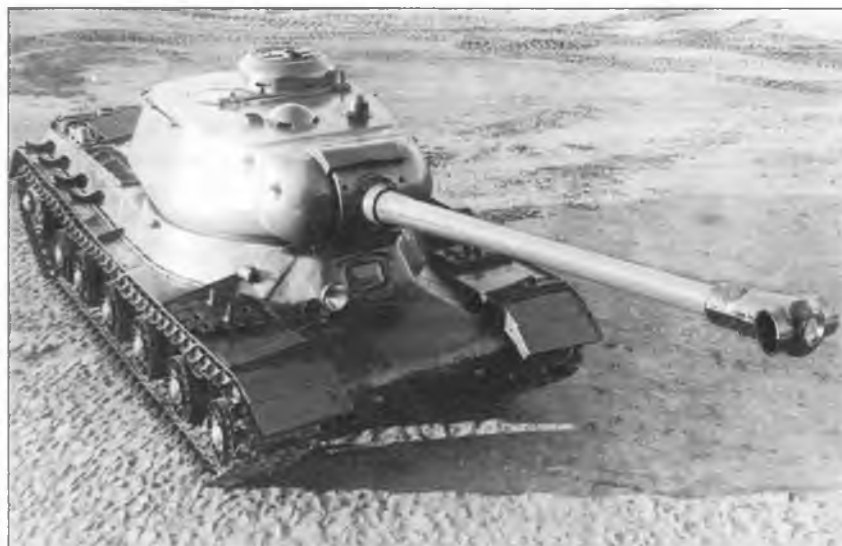
ИС-122 («Объект 240») со 122-мм орудием Д-25 во дворе ЧКЗ. 1943 г.
