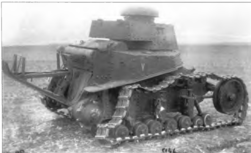
Дистанционно управляемый модернизированный танк МС-1(Т-18) выпуска 1930–31 гг.
