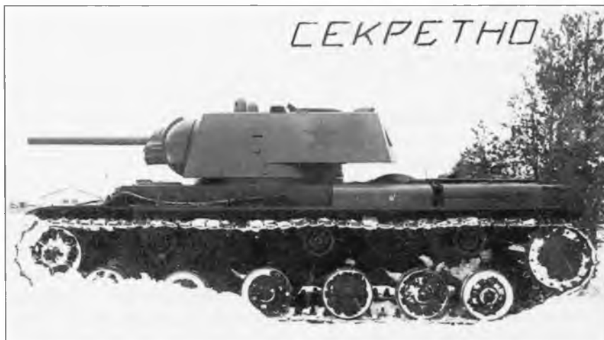
Танк КВ-1, вооруженный 76,2-мм орудием Ф-34. Февраль 1941 г.
