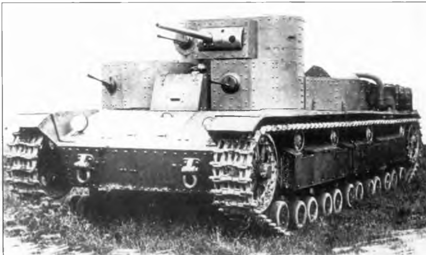
Прототип танка Т-28 с установленным вооружением, 1932 г.
