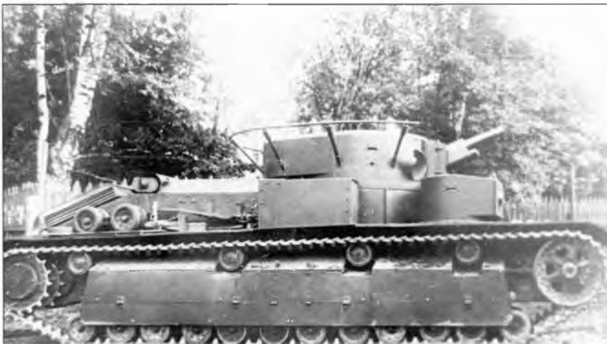
Серийный танк Т-28, вооруженный 76,2-мм пушкой ПС-3, 1934 г.
