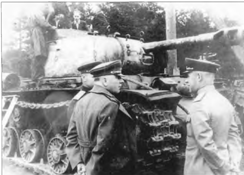
Показ К.Ворошилову опытного танка КВ-1С, вооруженного орудием С-41. Август 1943 г.
