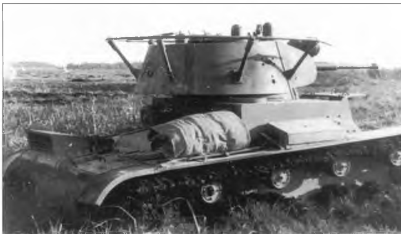
Танк Т-26, с улучшенной башней и усиленной подвеской, на испытаниях. Весна, 1938 г.
