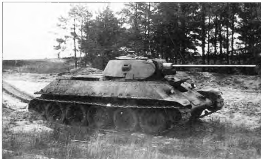
Заводские испытания опытного образца танка Т-34 «танк-истребитель», вооруженного 57-мм пушкой ЗИС-4. Весна, 1941 г.
