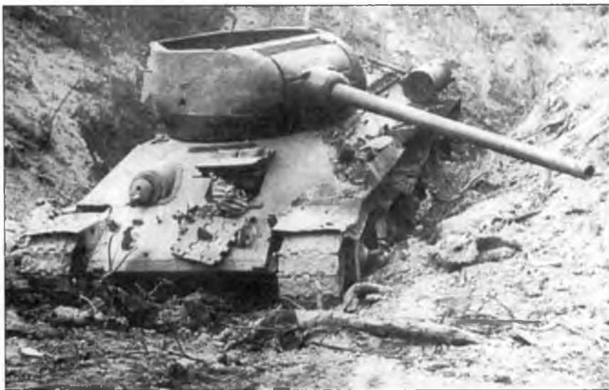
Еще один Т-34-85 северокорейских войск с детонировавшим боекомплектom. 1950 г.
