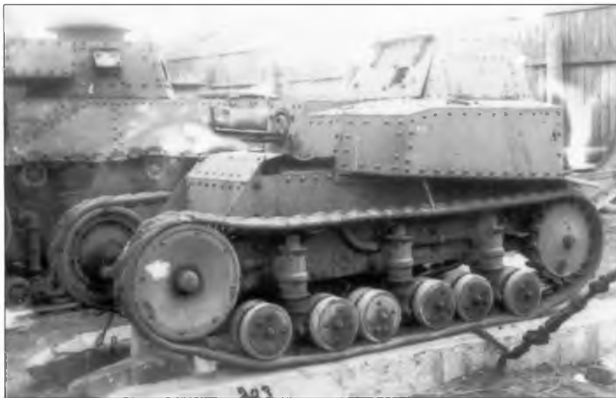
Танкетка Т-17 первого образца, 1929 г.
