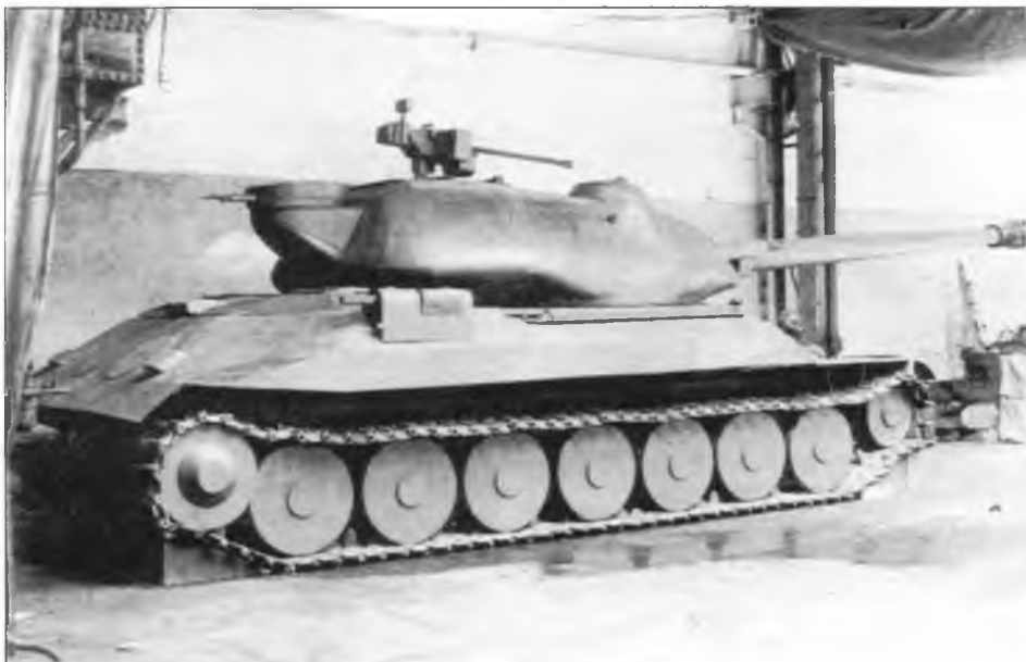
Деревянная модель танка «Объект 260» в натуральную величину. 1946 г.
