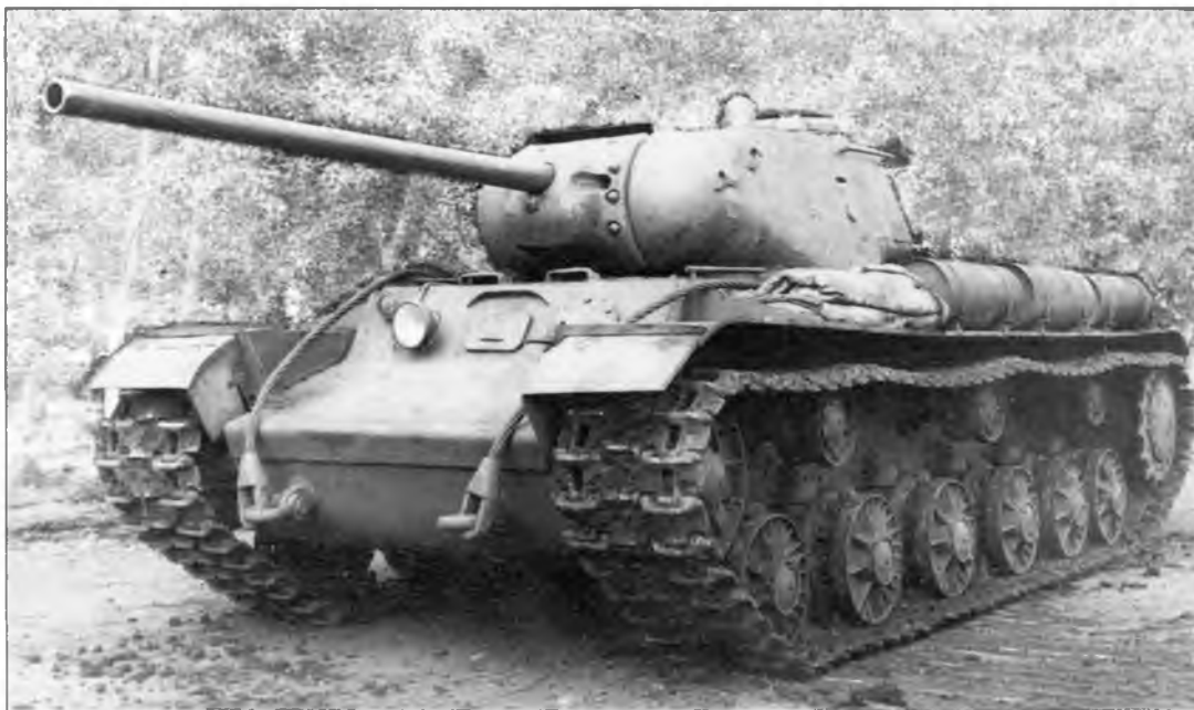
Танк КВ-85 («Объект 238») с 85-мм пушкой С-31 в штатной башне КВ-1С. Лето 1943 г.
