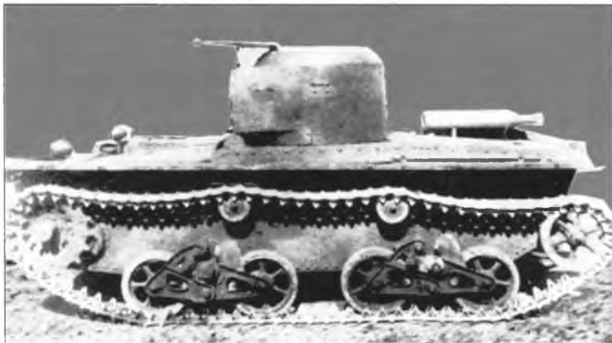
Танк Т-38 с подвеской Куликова на составных торсионных валах.
