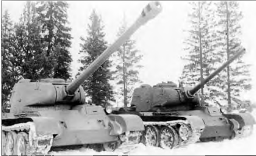
Совместные испытания танков Т-44 с 85-мм танковой пушкой Д-5Т и 122-мм танковой пушкой Д-25Т-44
