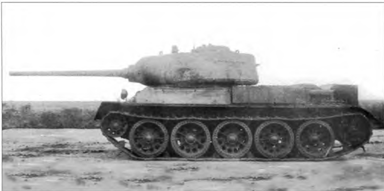
Танк Т-43серийный, вооруженный опытным образцом 85-мм пушки Д-5Т. Осень 1943 г.
