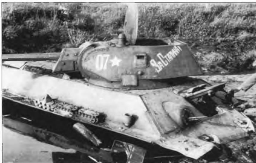
Оставленный Т-34 выпуска СТЗ с экранированной лобовой броней. Лето 1942 г.
