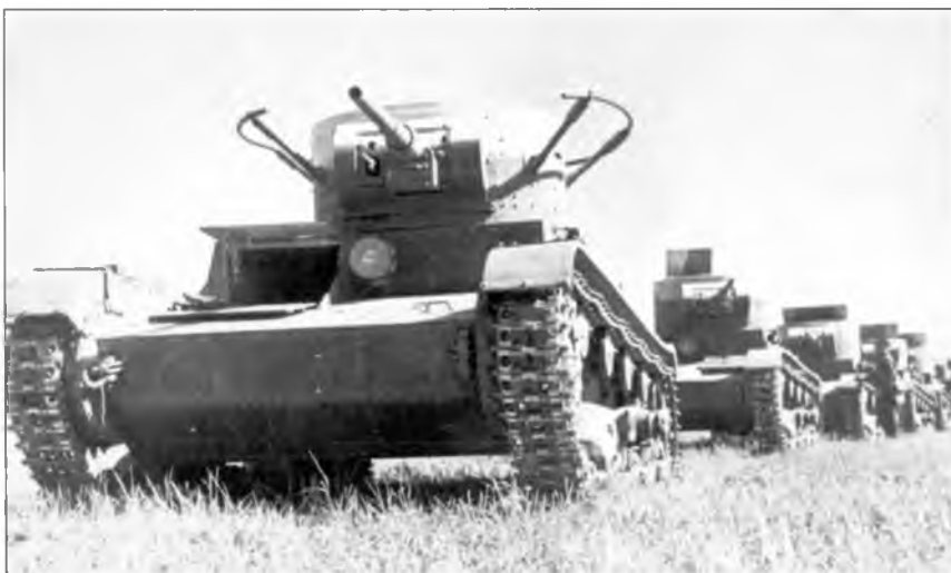
Колонна танков Т-26 с пушечными 45-мм башнями клепаной конструкции, 1934 г.
