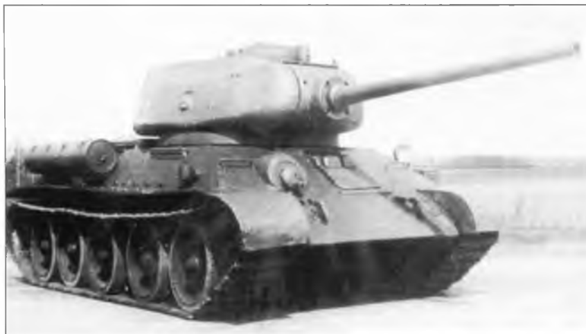
Танк Т-34-85 с орудием Д-5Т выпуска завода № 112. Весна 1944 г.
