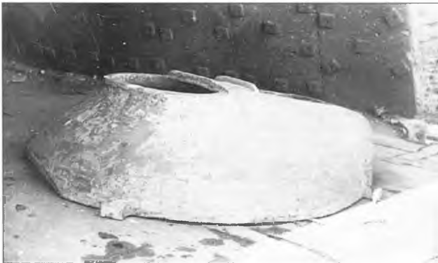
Отливка башни опытного образца модернизированного танка ИС. 1944 г.
