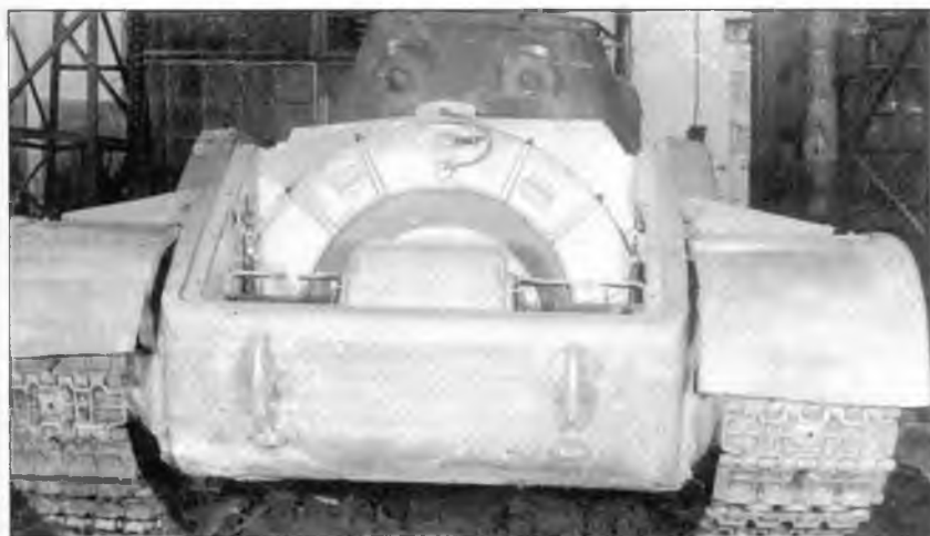
Вид сзади на танк KB-13 и систему охлаждения двигателя со снятой бронеплитой. 1942 г.
