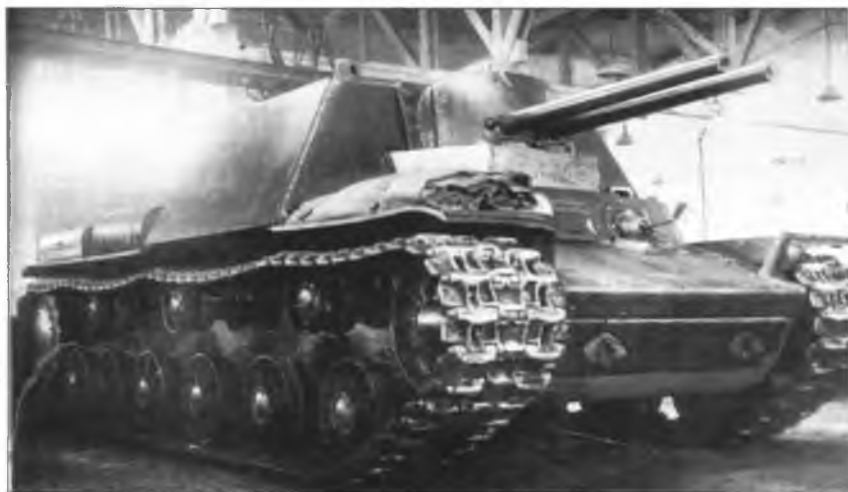
Второй вариант танка KB-7. Весна 1942 г.
