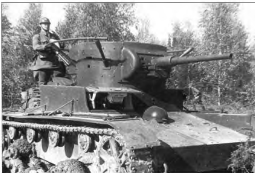
Танк Т-26 выпуска 1936 г. со сварным корпусом и штампованным щитком (маской) башни на учениях. 1937 г.
