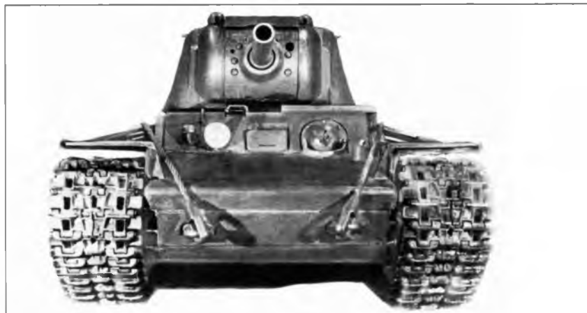
Артиллерийский танк KB-9. Зима, 1941–42 гг.
