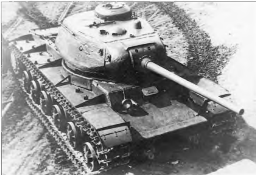
Танк КВ-85 («Объект 239») с 85-мм пушкой Д-5Т. Лето 1943 г.
