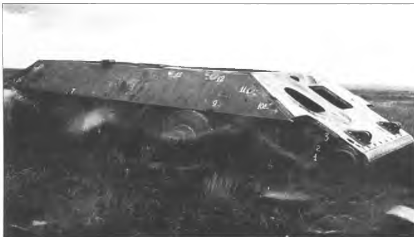
Бронекорпус Т-34 завода № 264 на полигоне 4-й танковой бригады. Сентябрь 1941 г.
