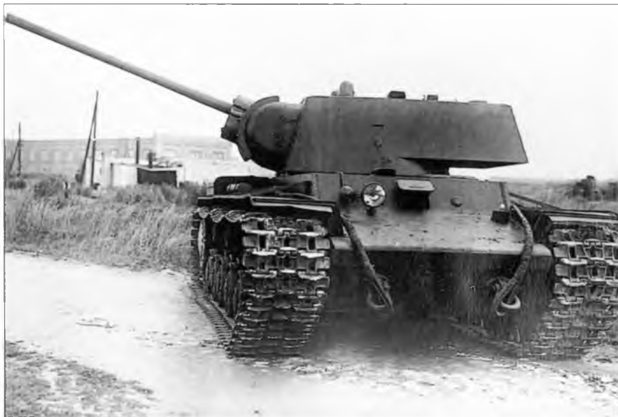
Испытания опытного образца 76,2-мм пушки Ф-27 (ЗИС-5) в танке КВ. Весна 1941 г.
