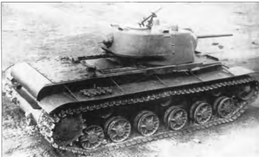
Танк КВ-1 с литой башней и корпусом завода № 200. Лето, 1942 г.
