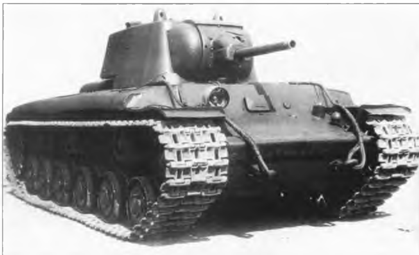
Серийный танк КВ, вооруженный 76,2-мм пушкой Л-11. 1940 г.
