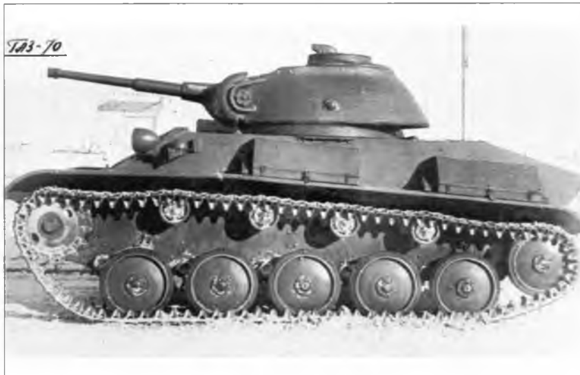
Танк ГАЗ-70 с литой башней конструкции В. Дедкова. 1941 г.
