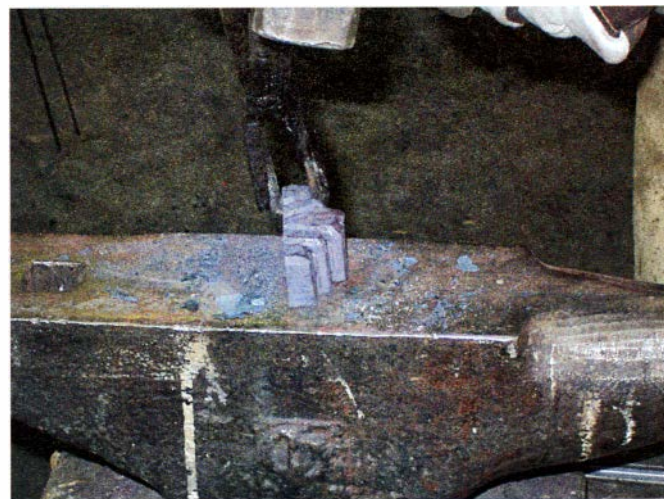
Ковка закончена. В последующем детали кроны будут обрабатывать напильником
