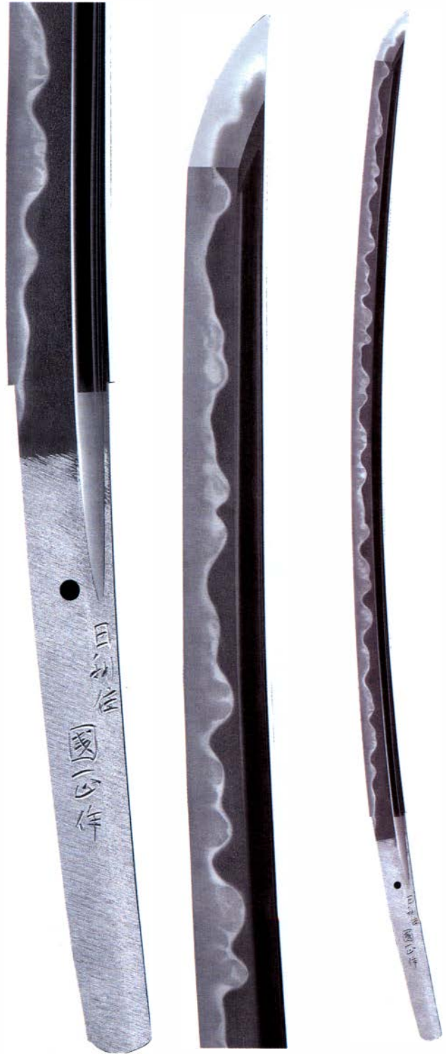
На отполированном клинке ясно видно разграничение закаленного лезвия и тела клинка линией твердости (хамон)
