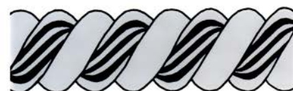
Прут дамасской стали из семи слоев скручивают, в результате чего получают характерный рисунок
