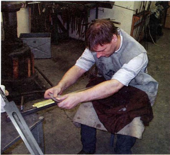
Клинок шлифуется и полируется вручную
