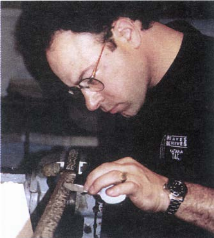
Уолли Хайес наносит глиняное покрытие для закаливания самурайского меча
