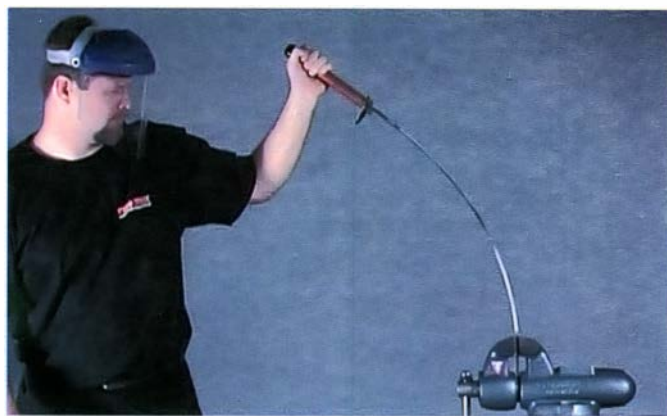
Современное испытание на гибкость. Объект испытаний – боевой нож, изготовленный фирмой Cold Steel
