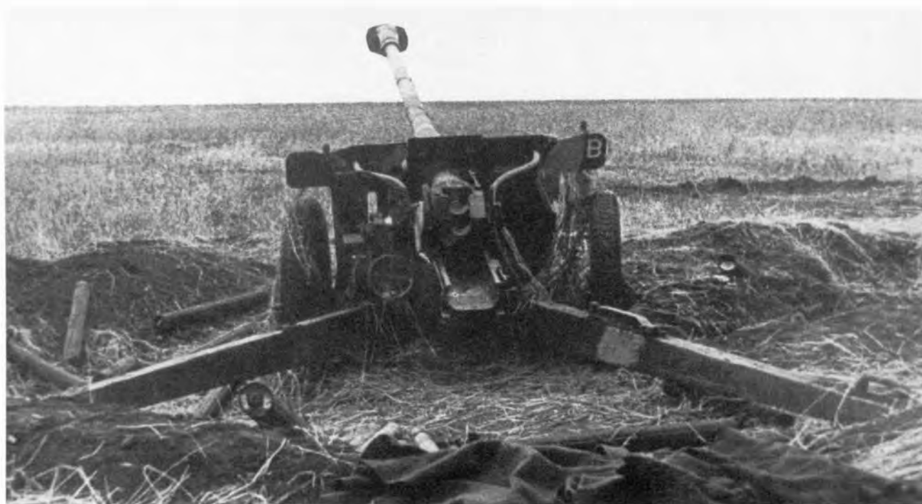
76,2-мм противотанковая пушка Pak 36 (г), брошенная на огневой позиции. 2-й Белорусский фронт, лето 1944 года. Хорошо виден казенник, маховики подъемного и поворотного механизмов слева от него и латинская буква В на правой стороне щита (АСКМ).
