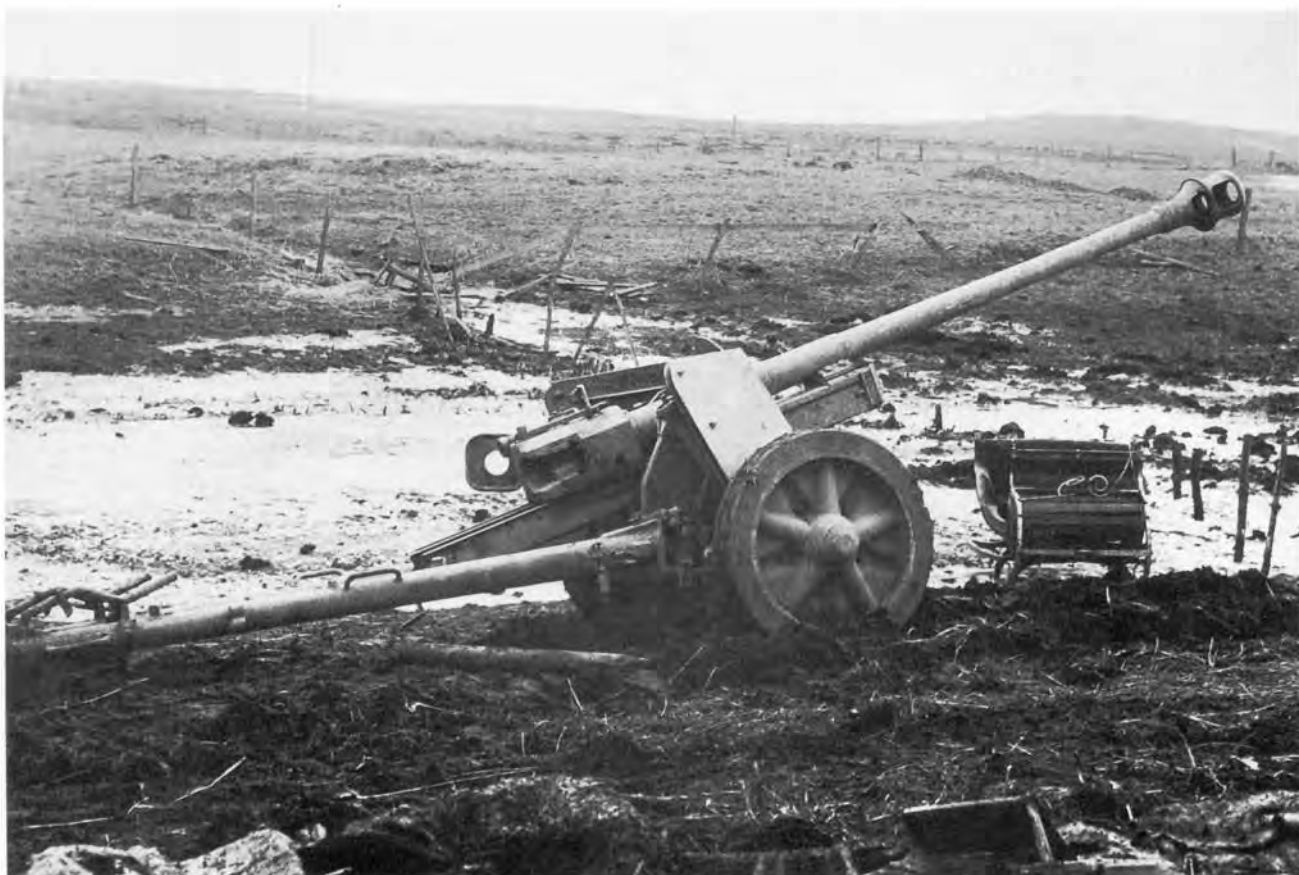
75-мм противотанковая пушка Pak 40, брошенная немцами при отступлении в Восточной Пруссии на подступах к Кенигсбергу. Апрель 1945 года. Пушка имеет сплошные колеса, отличные по конструкции от колес Pak 40 изображенной на предыдущем фото (АСКМ).
