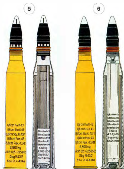
Выстрелы к 88-мм противотанковым пушкам Pak 43 и Pak 43/41: 5 – с бронебойно-трассирующим снарядом PzGr 39-1; 6 – с бронебойно-трассирующим снарядом PzGr 39/43; 7 – с осколочной гранатой SprGr Flak 41 (старого образца); 8 – с осколочной гранатой SprGr 43; 9 – с кумулятивным снарядом 39 HL; 10 – с кумулятивным снарядом 39/43 HL.
