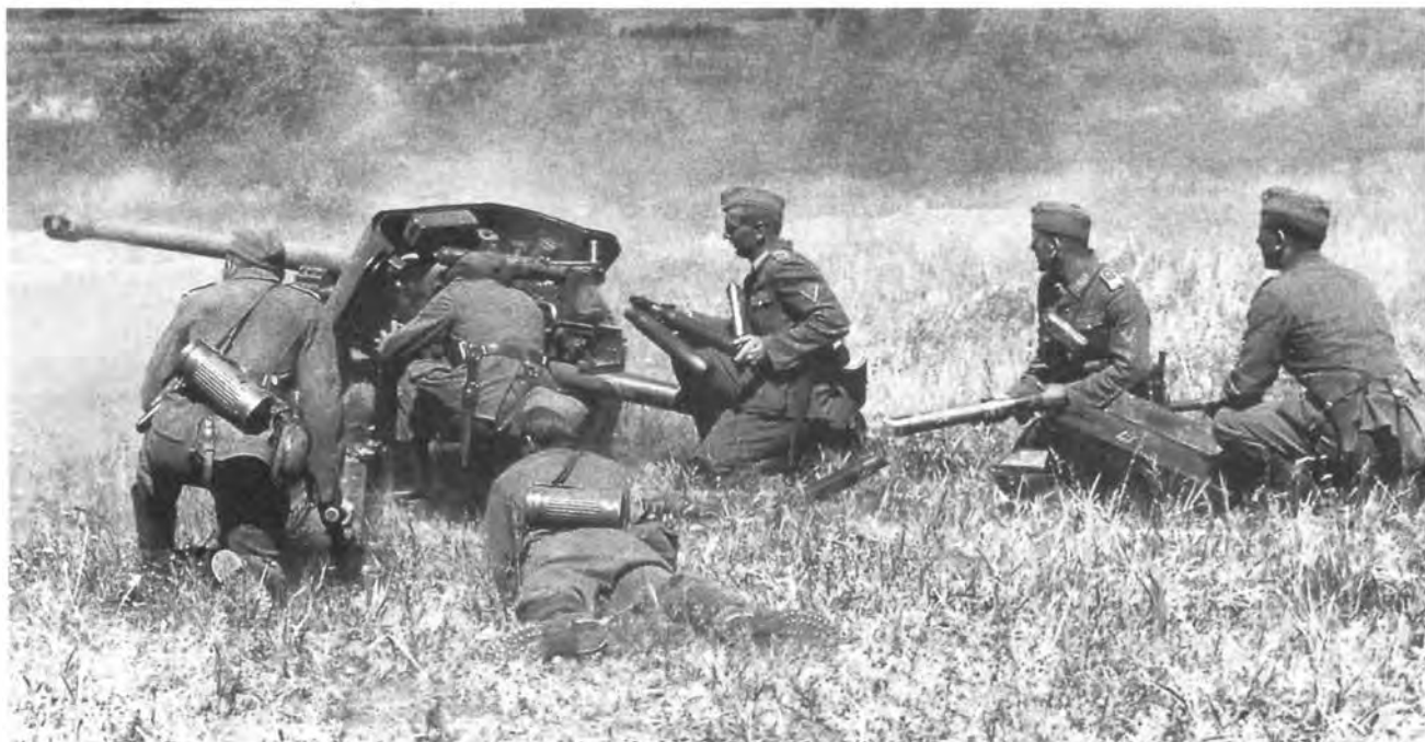
Расчет 50-мм противотанковой пушки Pak 38 во время боя. Лето 1941 года, советско-германский фронт. Хорошо видно расположение командира, наводчика, заряжающего и двух подносчиков выстрелов. У казенника видна гильза, экстрактирующаяся после выстрела (АСКМ).
