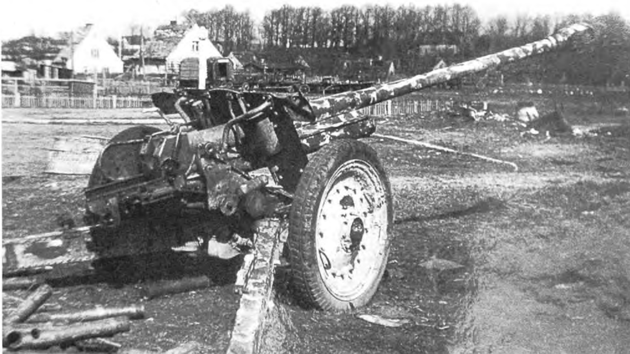
76,2-мм противотанковая пушка Pak 36 (г), захваченная на окраине Данцига. 2-й Белорусский фронт, март 1945 года. Орудие имеет трехцветный камуфляж, между станинами лежат стреляные гильзы (АСКМ).
