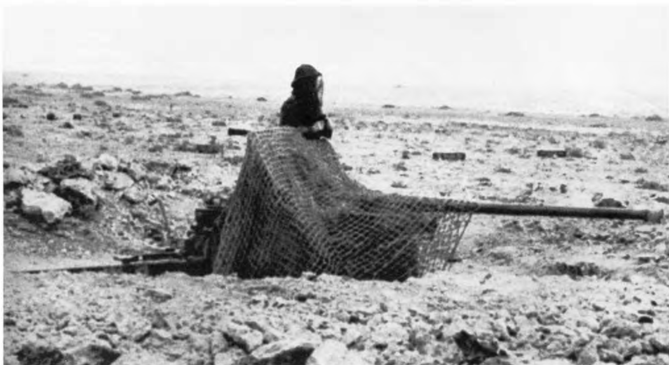
42/28-мм противотанковая пушка Pak 41 с коническим каналом ствола на огневой позиции. Северная Африка, 1942 год. Орудие закрыто маскировочной сетью (ЯМ).
