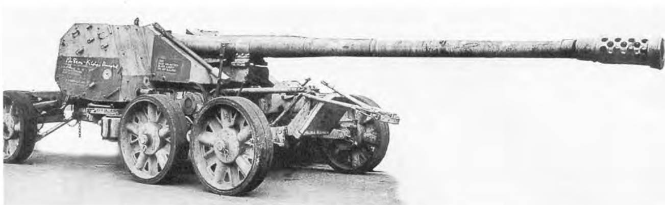
128-мм противотанковое орудие Рак 44 фирмы Рейнметалл-Борзиг в транспортном положении (ИП).
