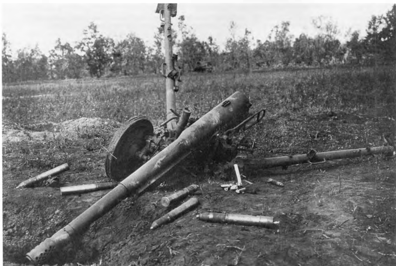
75-мм противотанковое орудие Rak 97/38, уничтоженное частями Красной Армии в ходе контрнаступления на орловском направлении. Центральный фронт, июль 1943 года, юго-восточнее деревни Подсобурово. На переднем плане видны 75-мм выстрелы к Rak 97/38 с кумулятивными снарядами (АСКМ).
