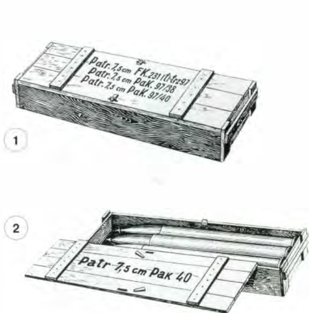
1 – деревянный ящик для 3 выстрелов к 75-мм противотанковой пушке Pak 97/38; 2 – деревянный ящик для 3 выстрелов к 75-мм противотанковой пушке Pak 40; 3 – металлический футляр для одного выстрела к 76,2-мм противотанковым пушкам Pak 36 (r) и Pak 39 (r); 4 – металлический футляр для одного выстрела к 75-мм противотанковой пушке Pak 40.
