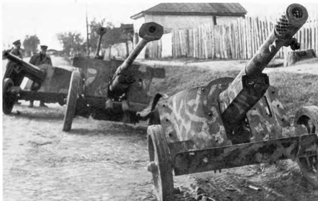
Немецкие противотанковые орудия, захваченные частями Красной Армии в ходе операции «Багратион» летом 1944 года: 75-мм противотанковые орудия Rak 97/38 (первое и третье) и 76,2-мм Rak 36 (r) (второе и четвертое). Rak 97/38 имеет камуфляж в виде узких полос желтого цвета, а Rak 36 (r) – в виде пятен неправильной формы (АСКМ).
