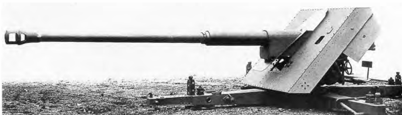
88-мм противотанковая пушка Rak 43 в боевом положении. Для фиксации орудия в землю вбивались 4 специальных трехлопастных клина, которые вставлялись в специальные отверстия на концах балок лафета (ИП).
