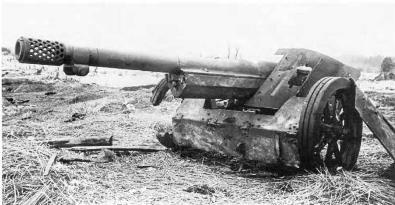
75-мм противотанковое орудие Pak 97/38, подбитое и захваченное частями Красной Армии во время одной из атак. Калининский фронт, 1942 год. Хорошо видна конструкция дульного тормоза пушки (АСКМ).
