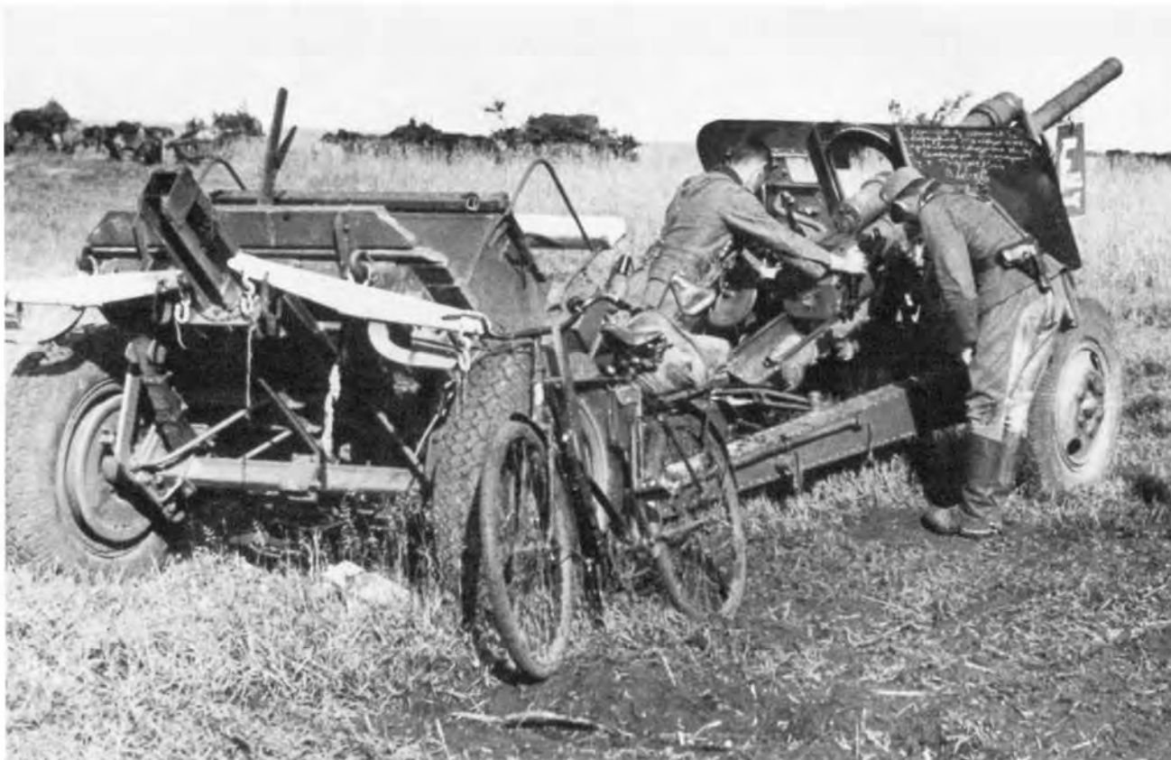
Немецкие солдаты осматривают брошенную частями Красной Армии 76,2-мм дивизионную пушку образца 1939 года (Ф-22УСВ). Группа армий «Юг», июль 1942 года. Часть таких орудий было переделано в противотанковые и использовались в вермахте как Pak 39 (r) (АСКМ).
