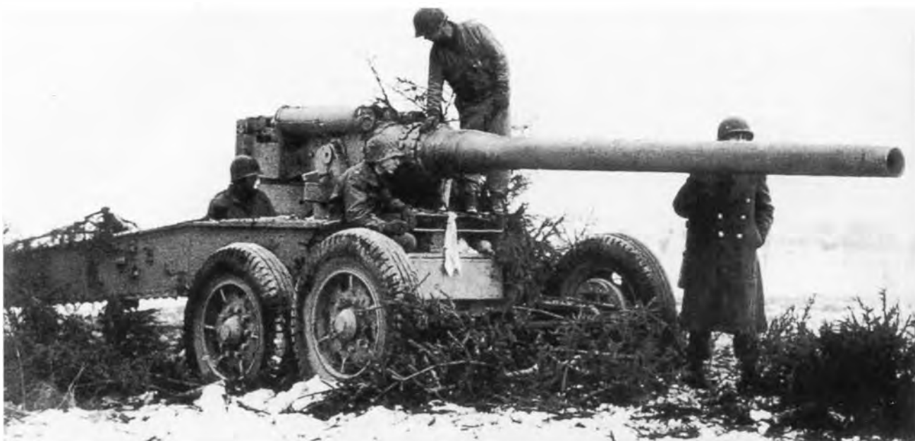
Американские солдаты осматривают 128-мм пушку К 81/1 (на лафете 155-мм французского орудия Canon de 155-mm Grand Puissance Filloux), захваченную в ходе боев в Арденнах. Январь 1945 года (АСКМ).
