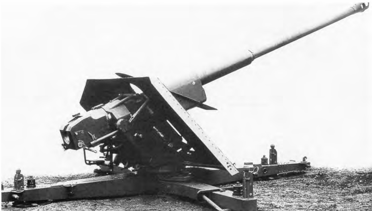
88-мм противотанковая пушка PaK 43 в боевом положении. Опоры боковин крестообразного лафета откинуты вверх (ИП).
