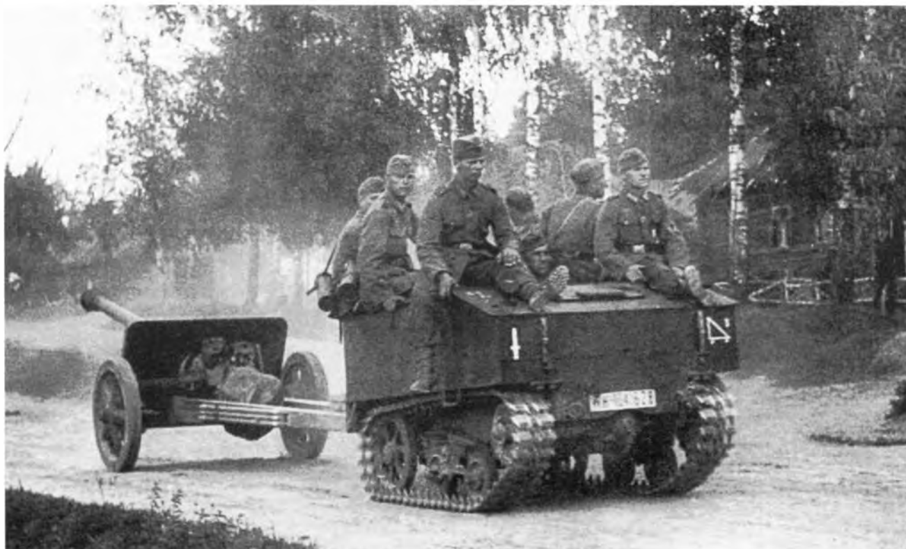
Трофейный артиллерийский тягач Vickers- Armstrong VA 601 (b), производимый в Англии для бельгийской армии в 1934–1936 годах, буксирует 75/55-мм противотанковую пушку Pak 41. Дивизион истребителей танков 30-й пехотной дивизии, советско-германский фронт, лето 1942 года (АСКМ).
