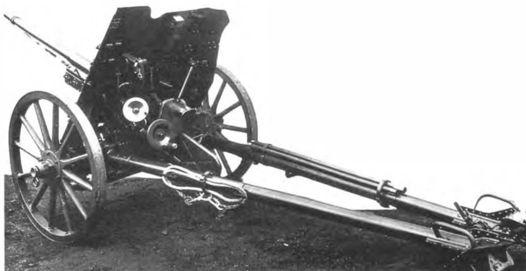
37-мм противотанковое орудие Так 28, поступавшее на вооружение рейхсвера с 1928 года. Пушка имеет деревянные колеса со спицами, хорошо видны маховики горизонтальной и вертикальной наводки, находящиеся слева от казенника (АСКМ).
