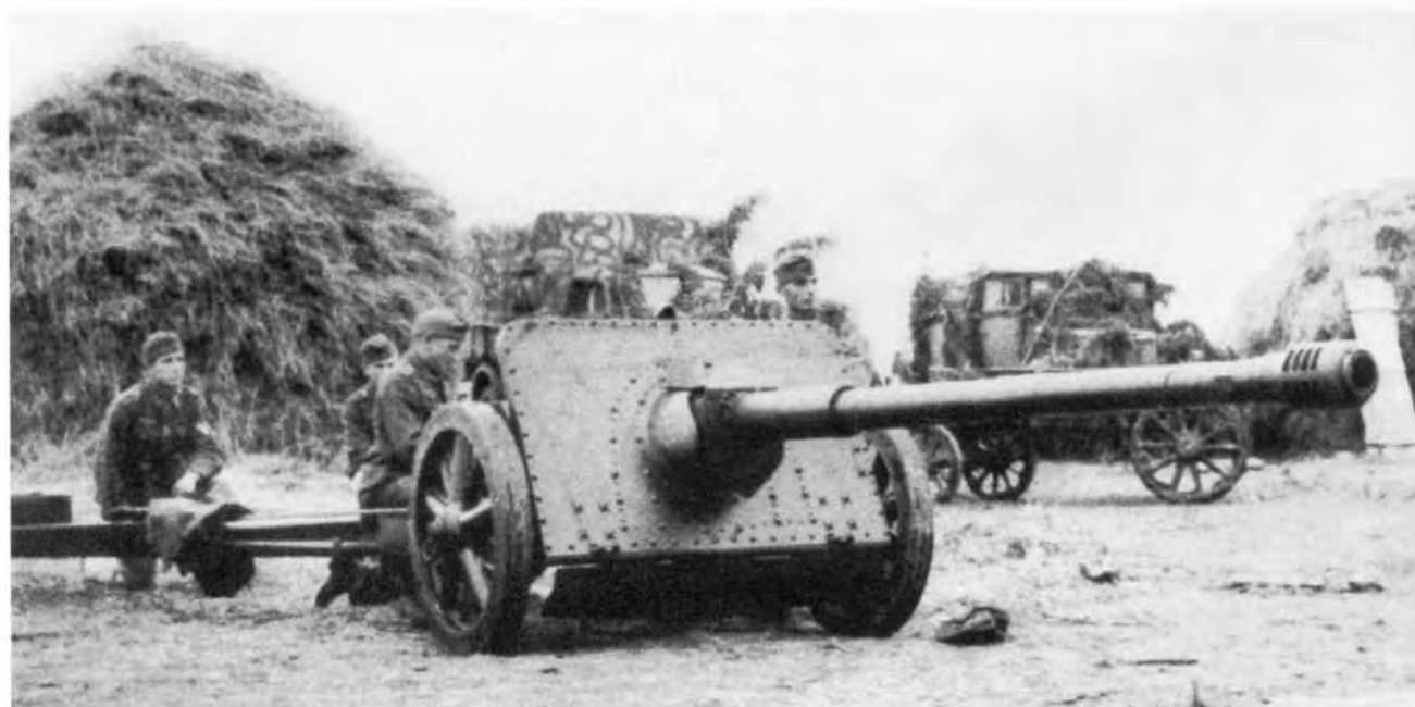
75/55-мм противотанковое орудие Pak 41 из состава 25-го дивизиона истребителей танков 25-й пехотной дивизии. Советско-германский фронт, лето 1942 года. Хорошо видна конструкция орудийного щита (РГАКФД).
