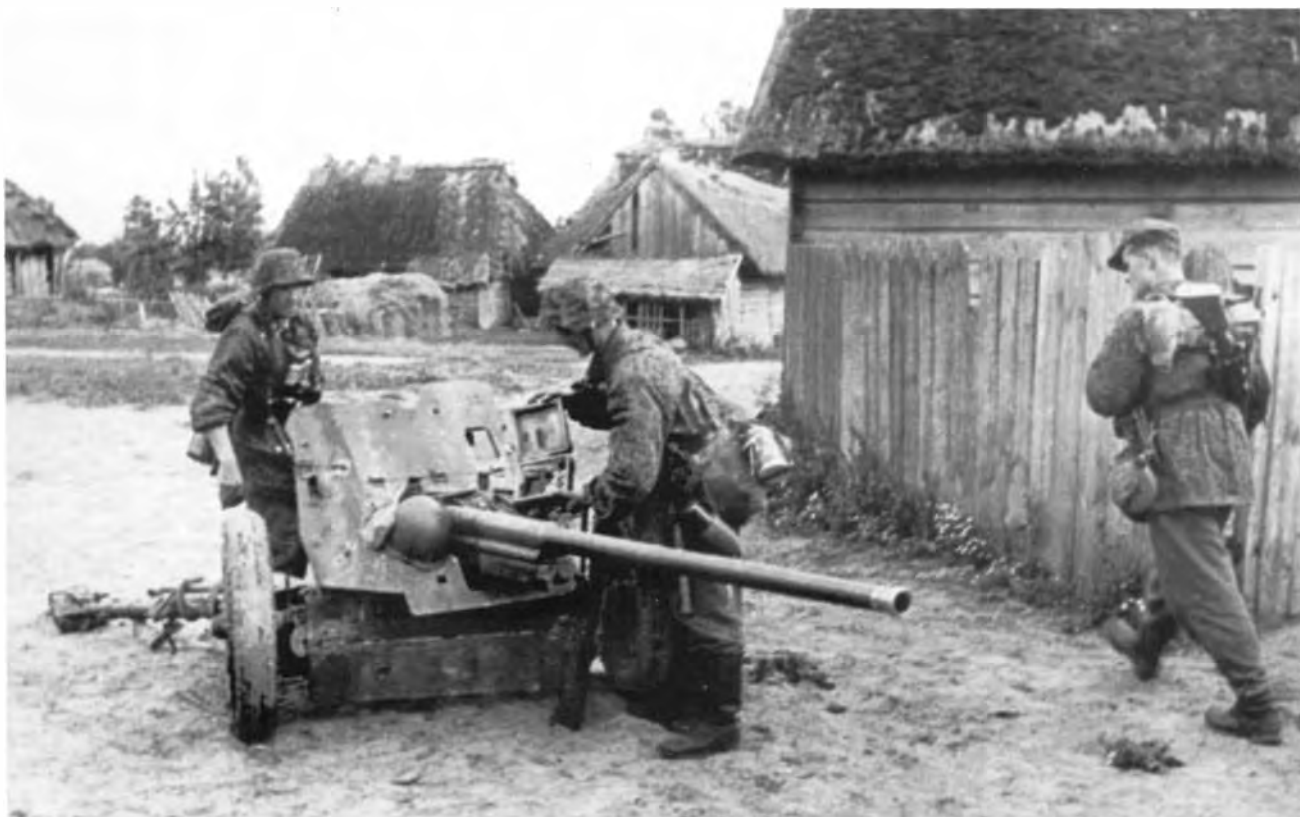
Немецкие солдаты осматривают трофейную советскую 45-мм противотанковую пушку образца 1942 года. Лето 1943 года. В вермахте такие орудия получили обозначение Рак 186 (r) , хотя фотографий их использования немцами автор не видел (РГАКФД).
