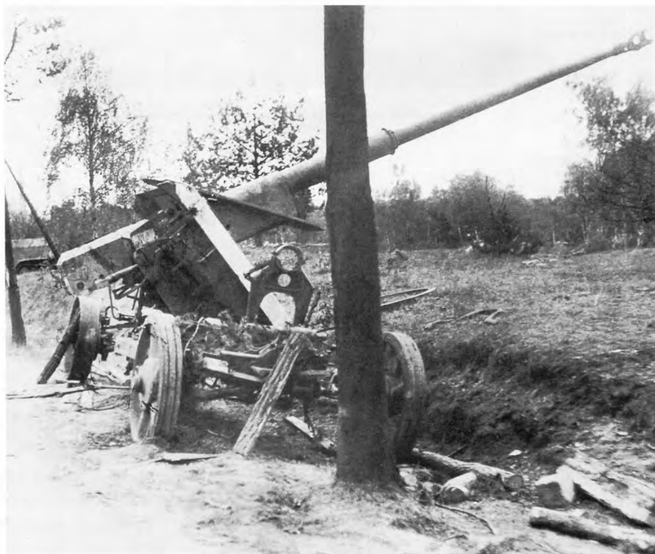
88-мм противотанковая пушка Rak 43 на колесных ходах, брошенная на дороге юго-восточнее Берлина. Апрель 1945 года. Хорошо виден стопор ствола орудия в походном положении (АСКМ).
