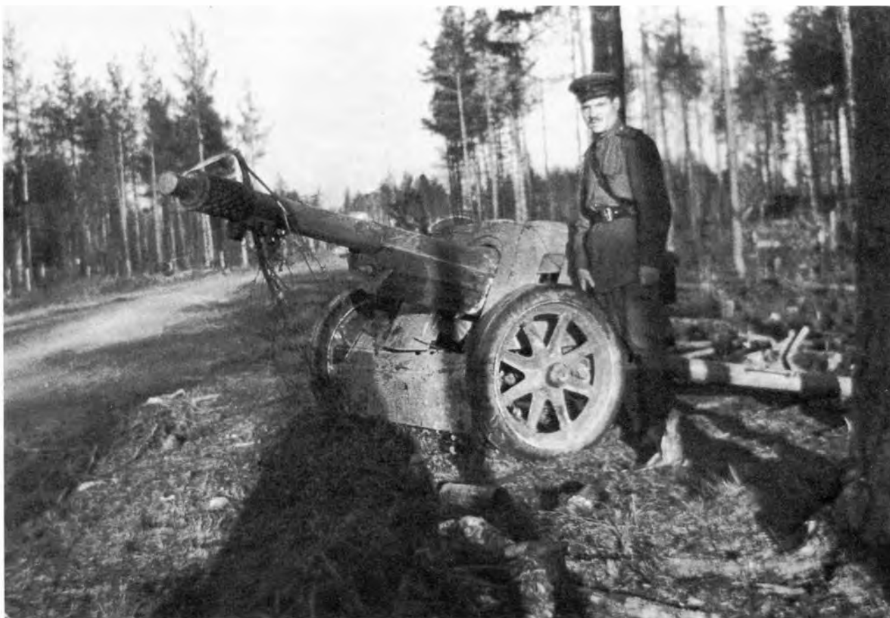
Офицер Красной Армии у трофейного 75-мм противотанкового орудия Pak 97/38. 1-й Белорусский фронт, июль 1944 года. В ствол пушки вставлена стреляная гильза (АСКМ).
