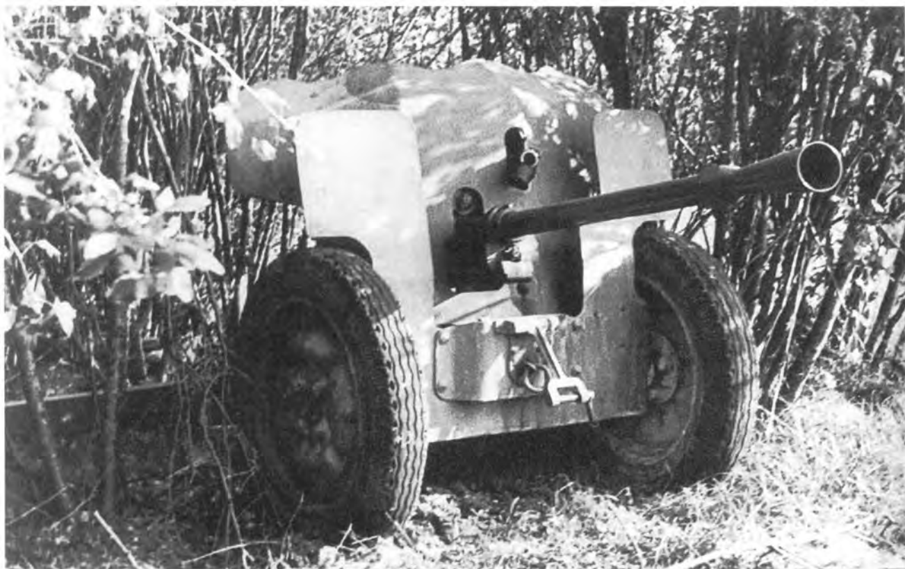
25-мм противотанковая пушка Гочкиса образца 1934 года SA-L mle 34, получившая в вермахте обозначение Pak 112 (f) (АСКМ).
