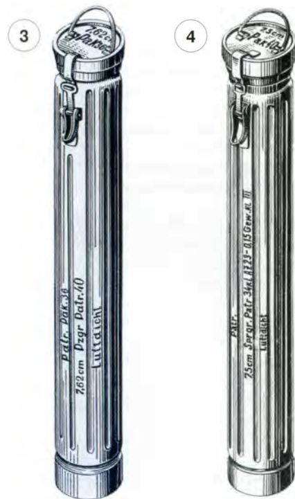
1 – деревянный ящик для 3 выстрелов к 75-мм противотанковой пушке Pak 97/38; 2 – деревянный ящик для 3 выстрелов к 75-мм противотанковой пушке Pak 40; 3 – металлический футляр для одного выстрела к 76,2-мм противотанковым пушкам Pak 36 (r) и Pak 39 (r); 4 – металлический футляр для одного выстрела к 75-мм противотанковой пушке Pak 40.
