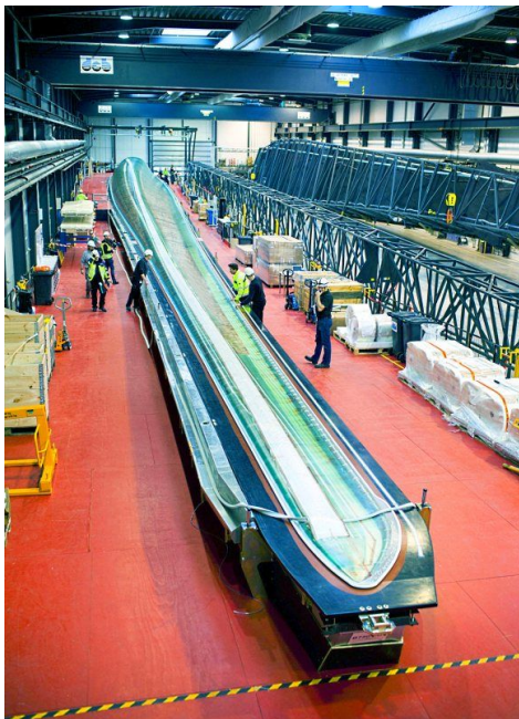
Самая длинная лопасть для ветрогенератора (75 м) — для ветряка 6 МВт в Дании — на заводе Siemens. Фото с сайта zhelezyaka.com
