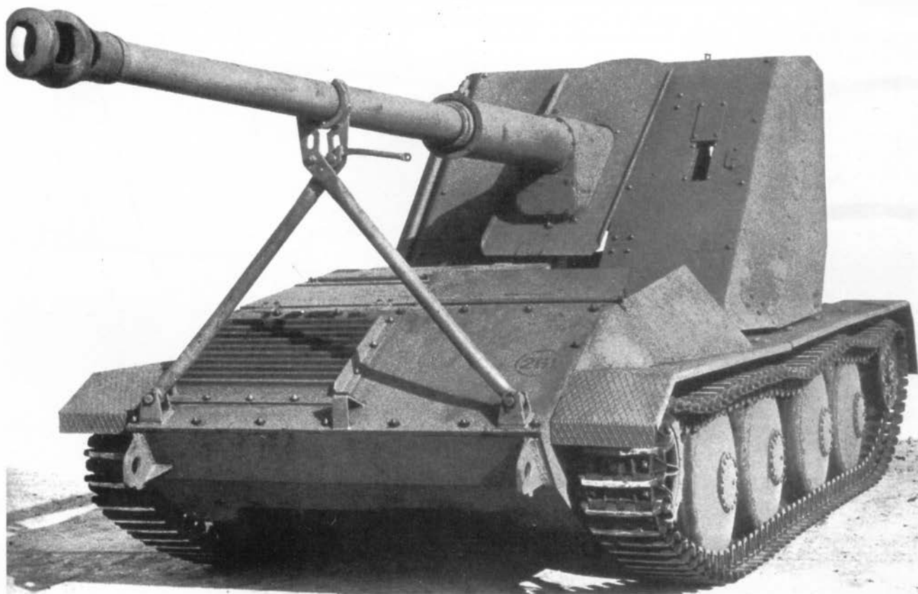
Второй опытный образец Waffenträger конструкции Ардельта с 88-мм пушкой PaK 43, общий вид и вид слева.
