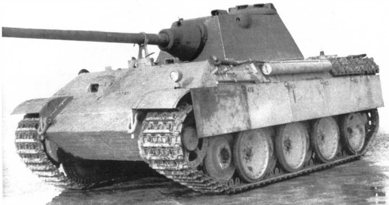
Второй вариант «узкой» башни с 75-мм орудием, установленный на шасси «Пантеры» Ausf. G. Сентябрь 1944 года.
