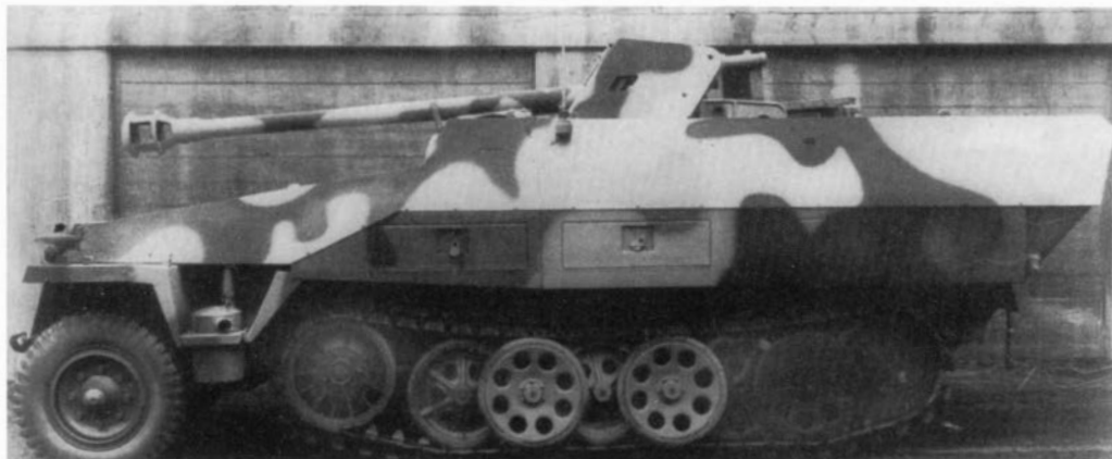
Бронетранспортер Sd. Kfz. 250/22 с 75-мм пушкой PaK 40. Эти машины предполагалось производить и в 1945 году. При этом рассматривался вариант замены PaK 40 на новое 75-мм орудие AK 7 В 84 L/48.
