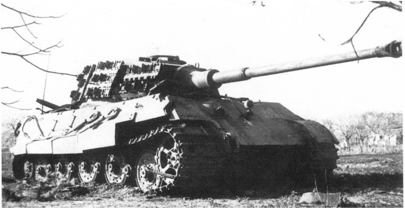
Еще один «Королевский тигр» выпуска начала 1945 года. Скорее всего, машина была оставлена экипажем. Обратите внимание на запасные гусеничные траки, закрепленные на борту башни. Венгрия, 3-й Украинский фронт, март 1945 года (АСКМ).
