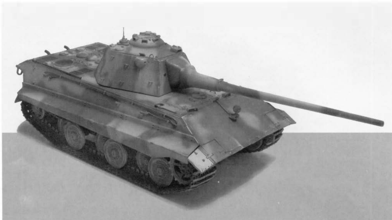
Возможные варианты вооружения 88-мм пушкой танков Е 50 (вверху) и Е 75 (внизу). На Е 50 установлена «узкая» башня (по типу той, которая была разработана для «Пантеры» Ausf F), а на Е 75 башня, аналогичная по конструкции башне «Королевского тигра» (модели изготовлены С. Федоровым).
