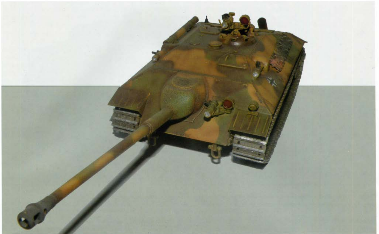
Истребитель танков Е 25 с 88-мм пушкой Рак 43 L/71. Такой вариант вооружения самоходки также прорабатывался, но окончательно вопрос о том, какую артсистему ставить на Е 25 так и не был решен (фото модели из коллекции С. Федорова).
