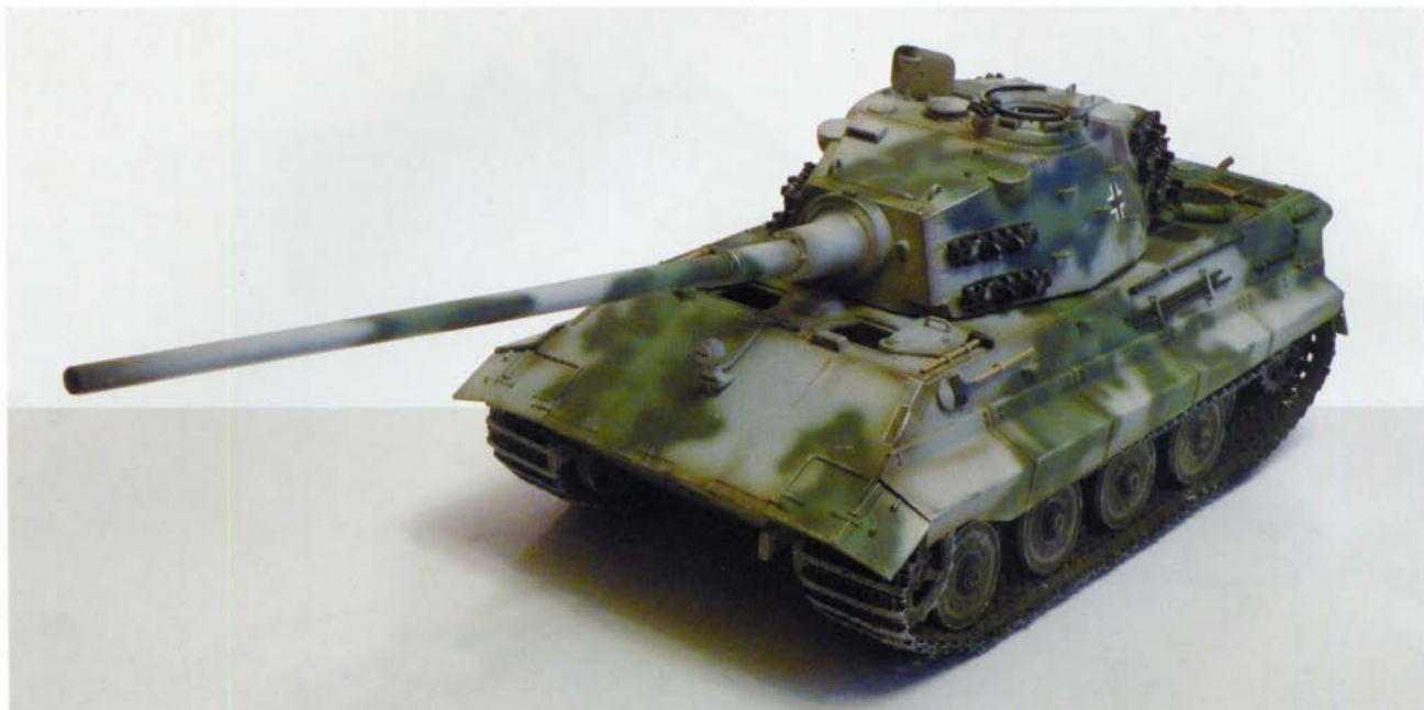
Проект танка Е 75 с башней по типу «Королевского тигра», но с 88-мм орудием. Как и в случае с Е 50, окончательный вариант вооружения Е 75 был не определен (фото модели из коллекции С. Федорова).
