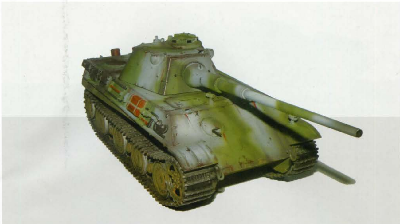
Вариант танка «Пантера» Ausf. F с 88-мм орудием в так называемой «узкой» башне. Однако появление опытного образца такой машины можно было ожидать самое раннее в конце 1945 года. Но в начале 1945 года вопрос о развертывании серийного производства такого танка вообще не ставился (фото модели из коллекции С. Федорова).
