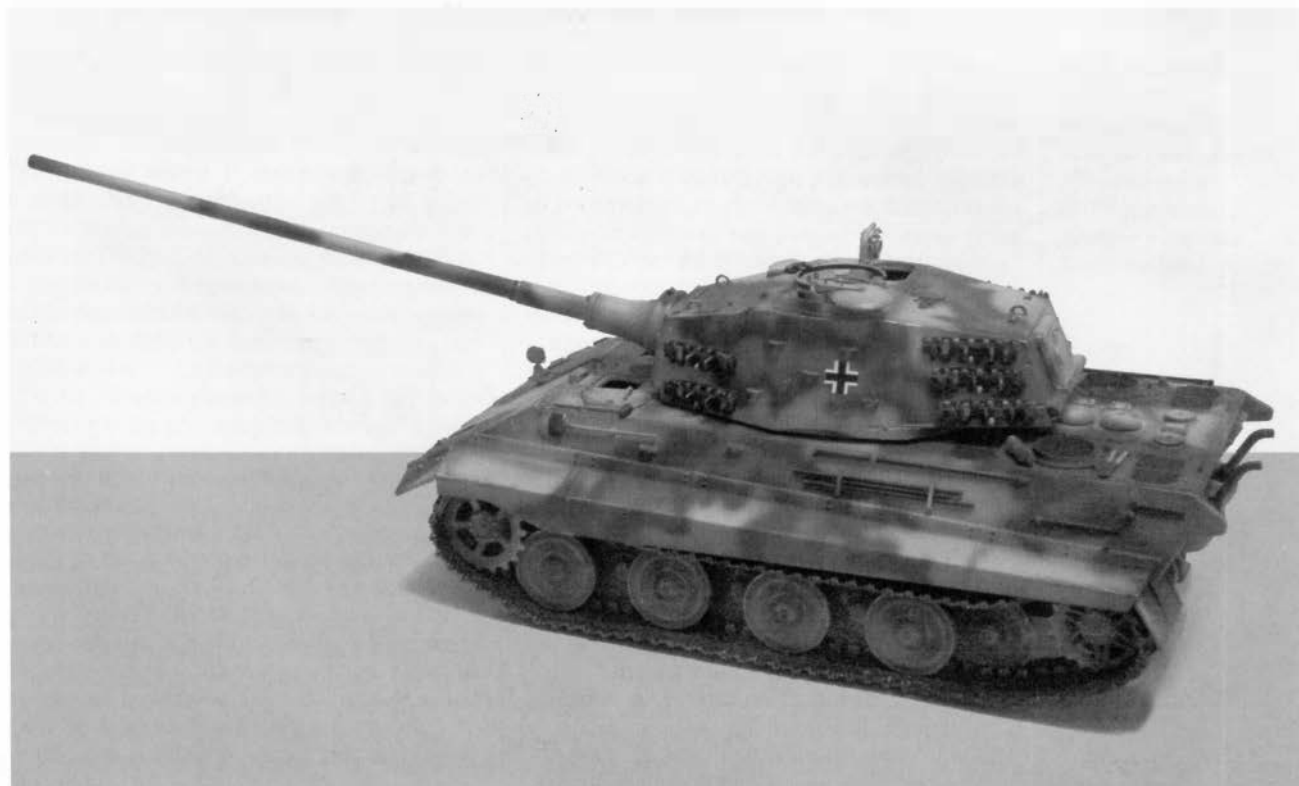
Возможные варианты вооружения 88-мм пушкой танков Е 50 (вверху) и Е 75 (внизу). На Е 50 установлена «узкая» башня (по типу той, которая была разработана для «Пантеры» Ausf F), а на Е 75 башня, аналогичная по конструкции башне «Королевского тигра» (модели изготовлены С. Федоровым).
