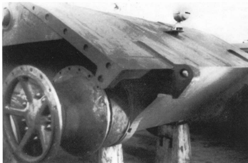
Вид на переднюю часть корпуса Е 100 – хорошо видно ведущее колесо (зубчатый венец не установлен), а также способ соединения броневых листов.
