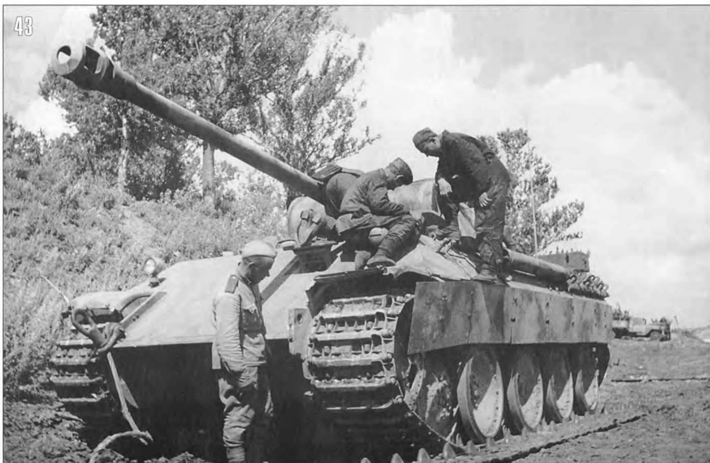
43. Бойцы и офицеры Красной Армии осматривают подбитую «Пантеру» 39-го танкового полка (бортовой № 824). Июль 1943 года. Машина получила две пробойны маски пушки (сбоку) 45-мм бронейными снарядами, и была оставлена экипажем.
