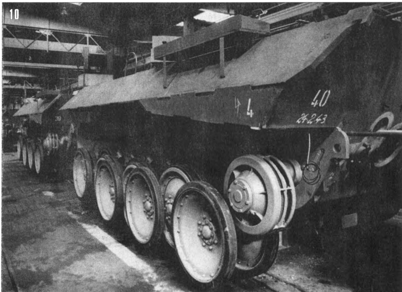
10. Линия сборки танков «Пантера» в цеху завода фирмы MAN. На корме ближайшего шасси видна дата – 24.2.43. При изготовлении «пантер» шасси устанавливались на специальные тележки (видна снизу).
