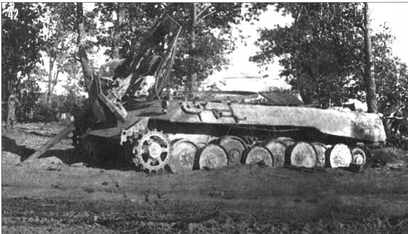
42. Эта «Пантера» 39-го танкового полка (бортовой № 512) получила три 76-мм пробойны в борт корпуса, и при отступлении была подорвана немцами. Июль 1943 года.
