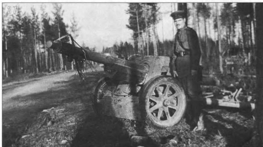
37. Офицер Красной Армии у трофейного 75-мм противотанкового орудия Pak 97/38. 1-й Белорусский фронт, июль 1944 года. В ствол пушки вставлена стреляная гильза (АСКМ).
