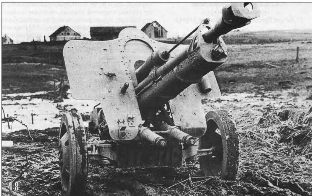
49. 76,2-мм противотанковое орудие Pak 39(r), захваченное частями Красной Армии, везут в тыл автомобилем «Виллис». Лето 1944 года. В отличие от фото 48, эта пушка имеет «родные» колеса от ЗИС-5 (фото из коллекции М. Свирина).
