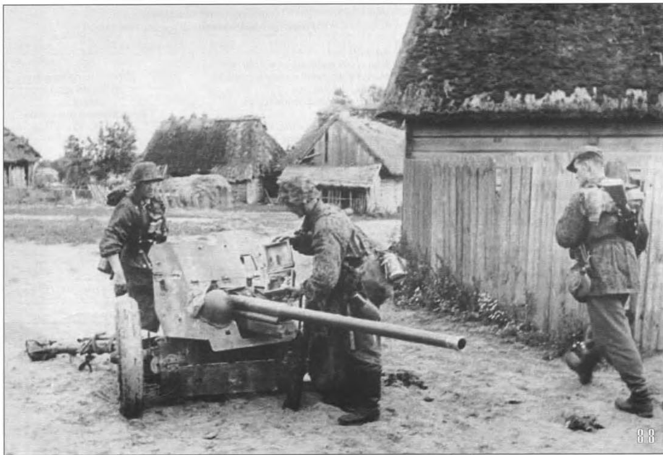
88. Немецкие солдаты осматривают трофейную советскую 45-мм противотанковую пушку образца 1942 года. Лето 1943 года. В вермахте такие орудия получили обозначение Pak 186(r), хотя фотографий их использования немцами автор не видел (РГАКФД).
