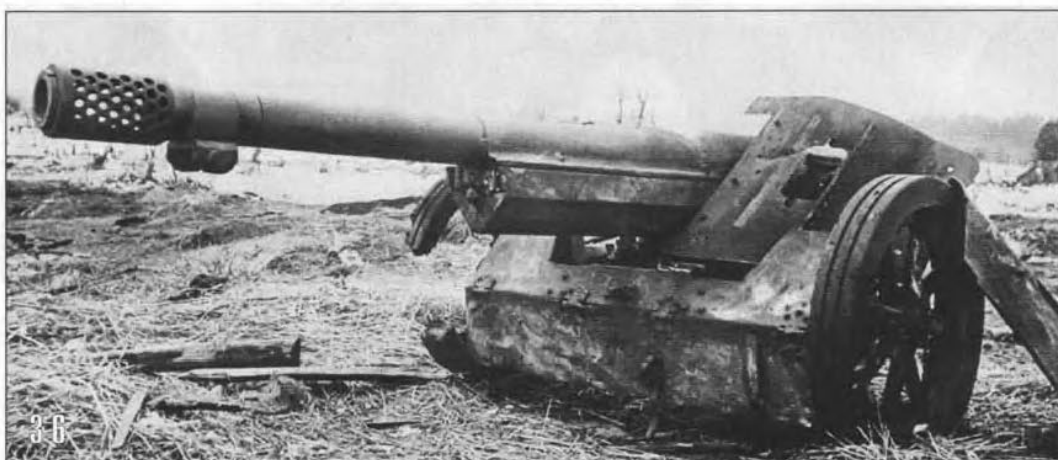
37. Офицер Красной Армии у трофейного 75-мм противотанкового орудия Pak 97/38. 1-й Белорусский фронт, июль 1944 года. В ствол пушки вставлена стреляная гильза (АСКМ).
