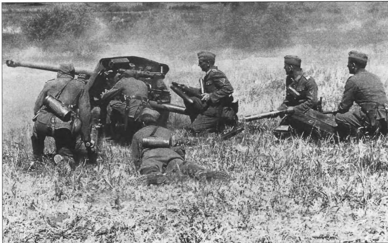
15. Расчет 50-мм противотанковой пушки Pak 38 во время боя. Лето 1941 года, советско-германский фронт. Хорошо видно расположение командира, наводчика, заряжающего и двух подносчиков выстрелов. У казенника видна гильза, экстрактирующаяся после выстрела (АСКМ).
