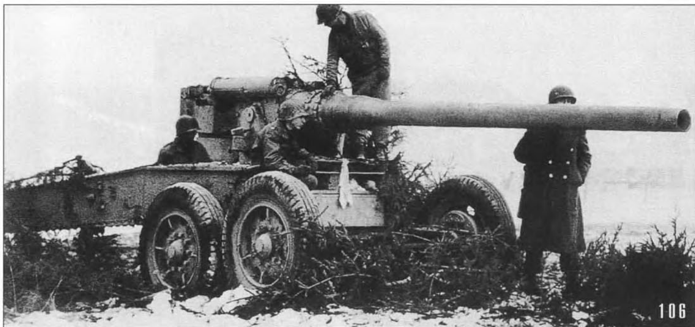
106. Американские солдаты осматривают 128-мм пушку К 81/1 (на лафете 155-мм французского орудия Canon de 155-mm Grand Puissance Filloux), захваченную в ходе боев в Арденнах. Январь 1945 года (АСКМ).
