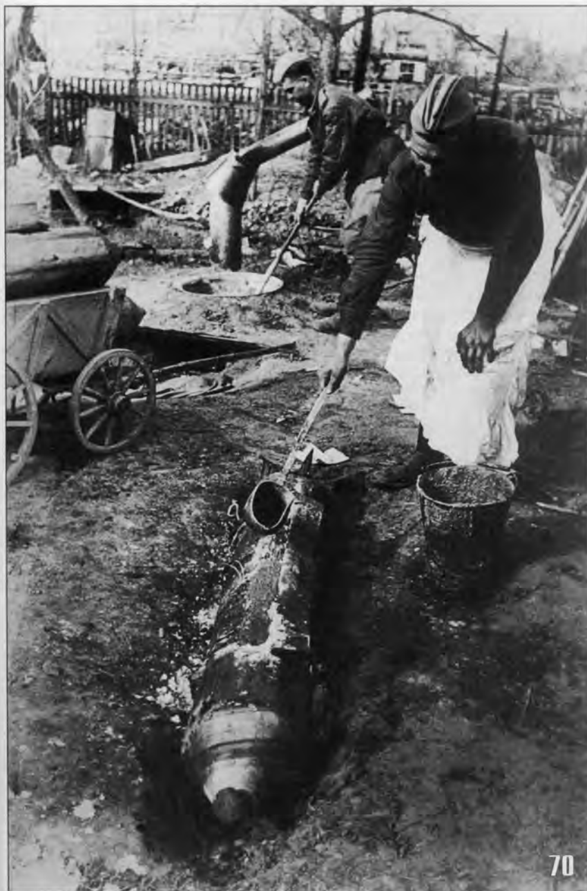
70. Заливка расплавленного тола в дополнительный корпус летающей торпеды, установленный на снаряд М-13. 1-й Украинский фронт, Бреславль, саперное подразделение инженер-майора Морозова, 29 апреля 1945 года (АСКМ).
