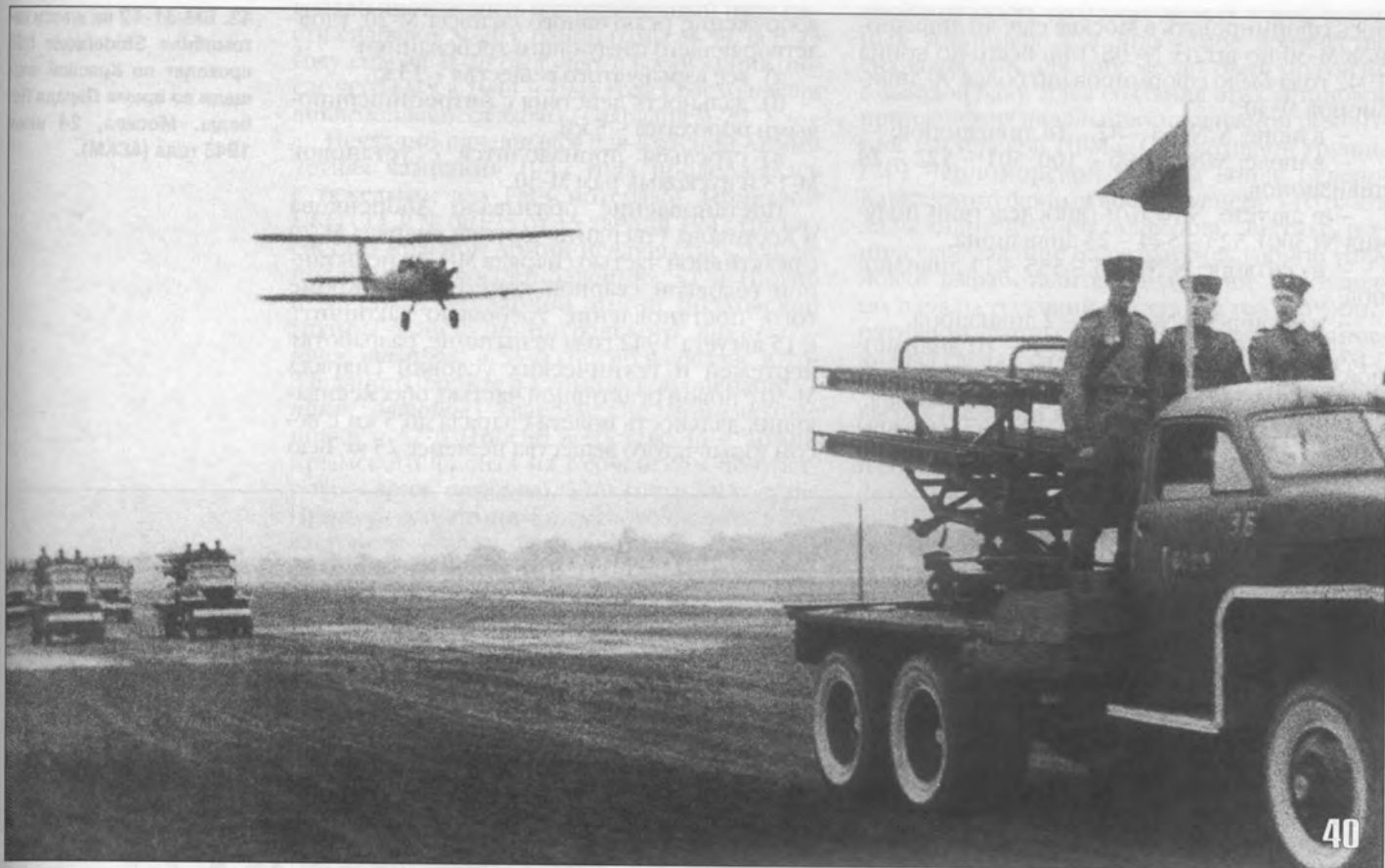
40. Парад частей 2-го гвардейского кавалерийского корпуса по случаю окончания войны. Май 1945 года. На переднем плане БМ-8-48 на шасси автомобиля Studebaker US6 (АКМ).
