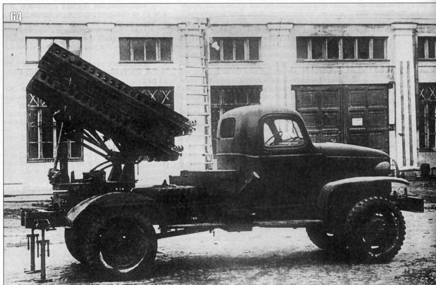
64. Установка М-8-48 на шасси Chevrolet G-7117 во дворе завода «Компрессор». 1942 год (АСКМ).
