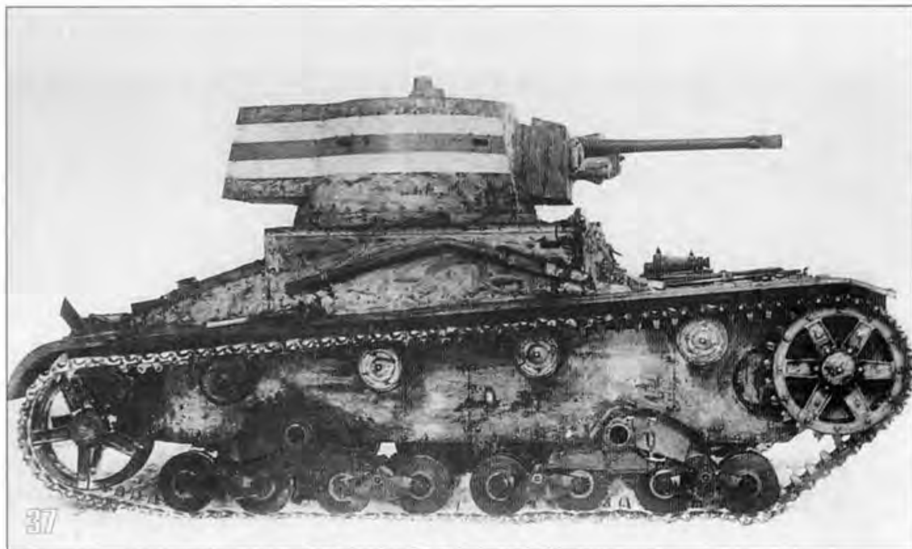
37, 38. Финский «Виккерс» на испытаниях в Кубинке весной 1940 года. На фото 38 хорошо видно вооружение танка, особенно амбразура для пистолета-пулемета «Суоми» в лобовом листе корпуса (фото из Российского государственного военного архива).
