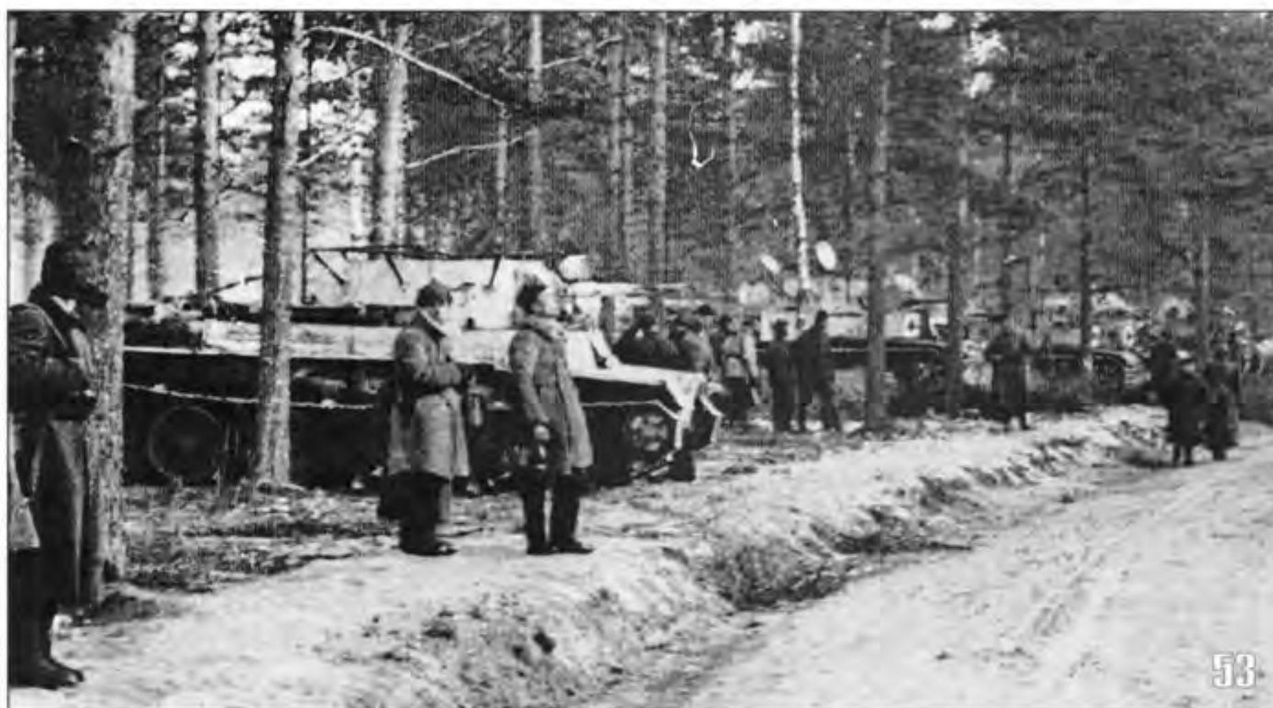
53. Танки БТ-7 (с цилиндрической башней и поручневой антенной) и Т-28 (на заднем плане) из состава 20-й тяжелой танковой бригады на подступах к Выборгу. Северо-Западный фронт, март 1940 года. Все танки перекрашены в белый цвет (АСКМ).
