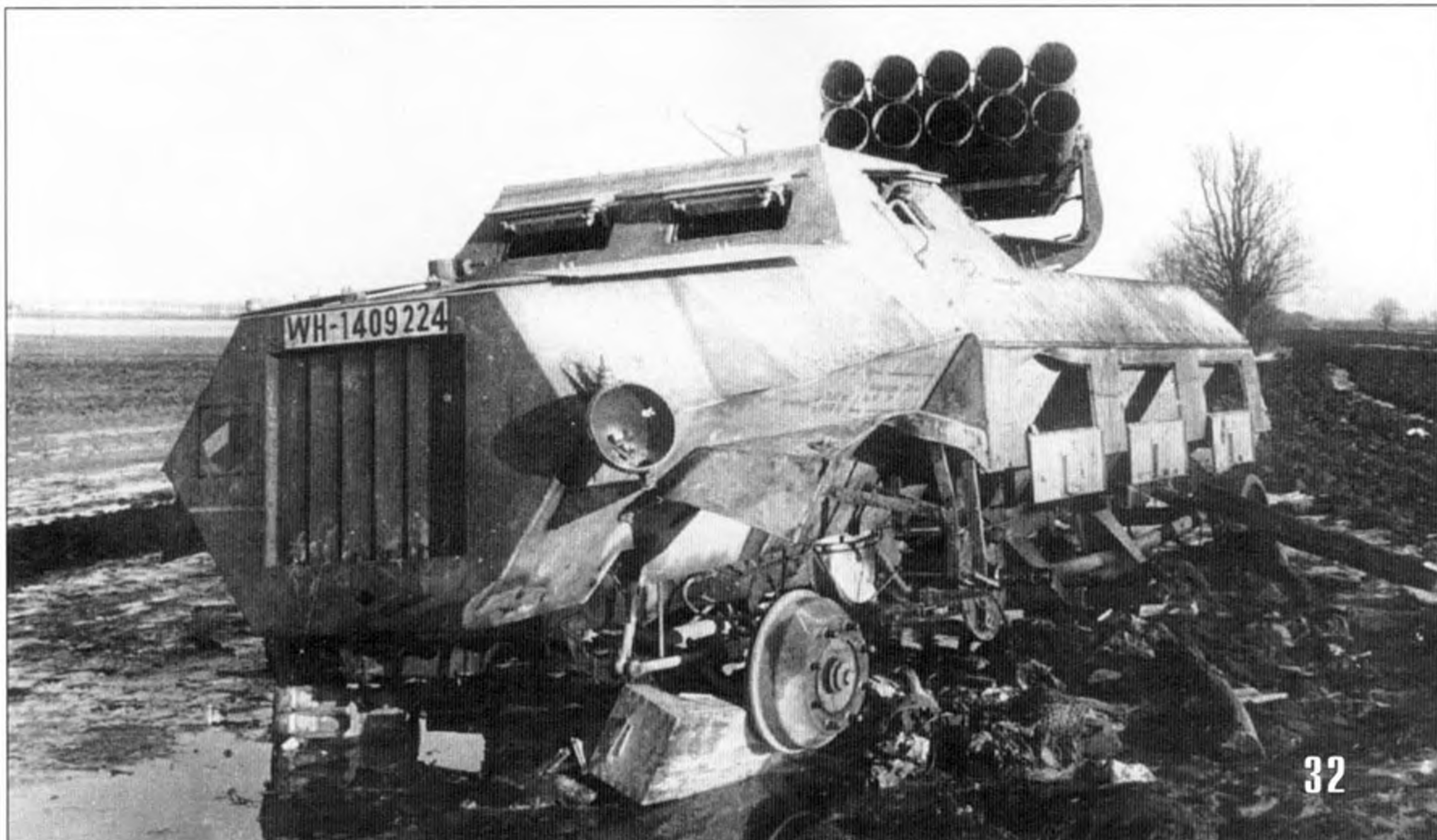
32. Реактивный 150-мм миномет на бронированной полугусеничной базе Panzerwerfer 42 Ausf SF (Sd Kfz 4/1) (номер "WH-1409224") предположительно из состава 11-й бригады реактивных установок. Восточная Пруссия, Земландский полуостров, апрель 1945 года (АСКМ).
