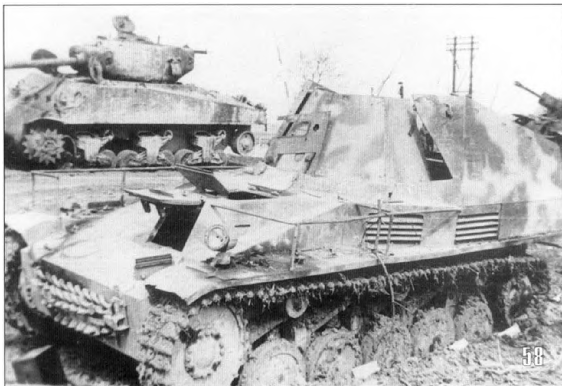
58. Транспортёр боеприпасов на базе самоходного орудия Sd Kfz 124 • "Веспе". На борту видна эмблема 13-й тд и надпись "I Pz Art Rgt 13" (13-й артиллерийский полк).
