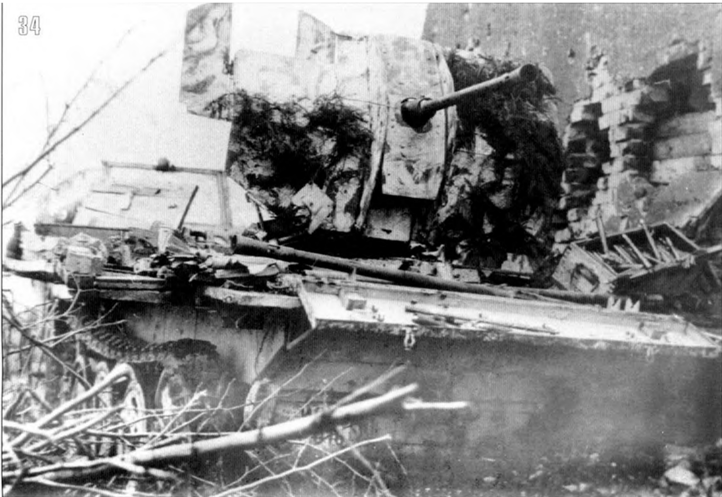
34, 35. 20-мм зенитная пушка Flak 38 на базе полугусеничного транспортера Sd Kfz 10/4. Восточная Пруссия, февраль 1945 года (АСКМ). 20-mm self-propelled antiaircraft gun Flak 38 mounted on the Sd Kfz 10/4 chassis. East Prussia, February 1945 (ASKM).
