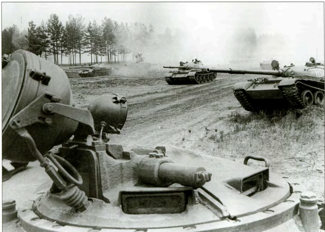
Вверху: Командирская башенка. На переднем плане – ИК-прожектор ОУ-ЗГК; под ним – прибор наблюдения командира ТКН-З
