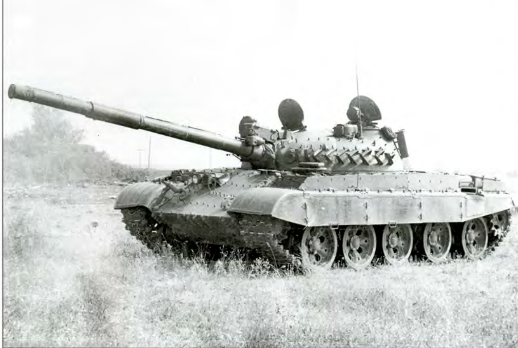
Слева: Средний танк Т-62МВ. На башне и корпусе хорошо видны бонки и крон- штейны для креп- ления элементов комплекса динами- ческой защиты
