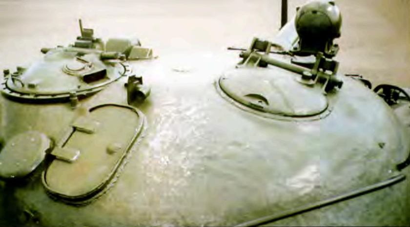
Вид сверху сзади на башню танка Т-62 образца 1962 г. Хорошо виден люк для выброса стреляных гильз, слева от него – броневой грибок над отверстием для подачи воздуха к нагнетателю-сепаратору.
