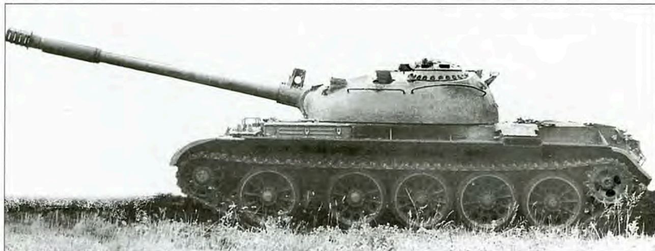
Опытный образец танка «объект 139» с пушкой Д-54ТС
