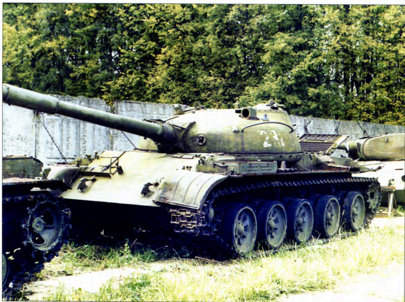
Опытный образец среднего танка «объект 166М»
