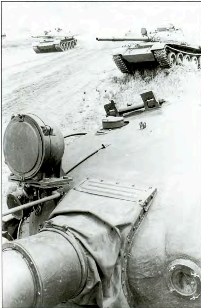
Вид на башню спереди-сверху. Справа от пушки, на подвижную бронировку которой надет защитный брезентовый чехол, видна амбразура телескопического прицела, закрытая защитным стеклом. Слева от пушки, на специальном кронштейне установлен ИК-осветитель ночного прицела Л-2Г, а ниже его – фара ФГ-125 прибора ТВН-2
