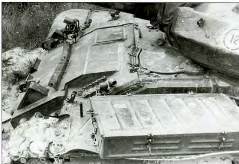
Накладная броня на верхнем лобовом листе корпуса
