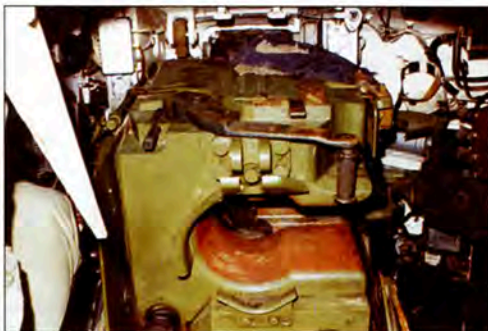
Вид на казенную часть 115-мм пушки
