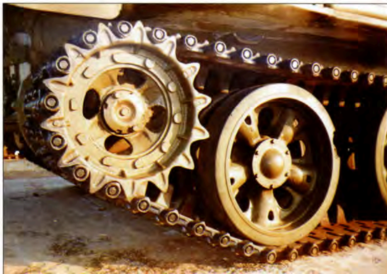
Ведущее колесо и опорный каток танка Т-62
