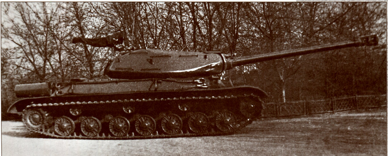
Серийный танк ИС-4 перед началом министерских испытаний, вид справа. Башня развернута «по-боевому», зенитный пулемет ДШК зачехлен (РГАЭ)
