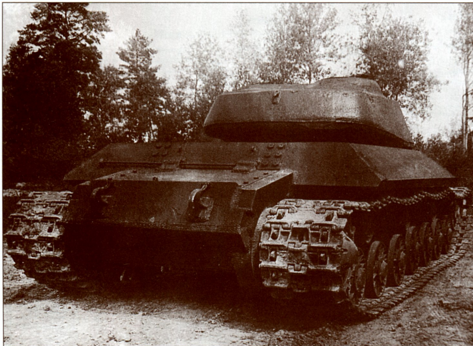
Бронекорпус с башней танка «объект 701» (вариант № 3) перед испытанием обстрелом, вид сзади. Август 1944 года (ЦАМО)
