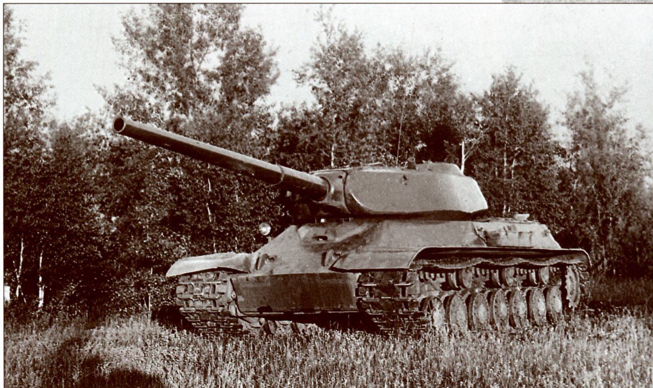
Танк «объект 701» № 1 перед прохождением испытаний. Лето 1944 года. На крыше башни видна установка 50-мм миномета С-11 (РГАЭ)
