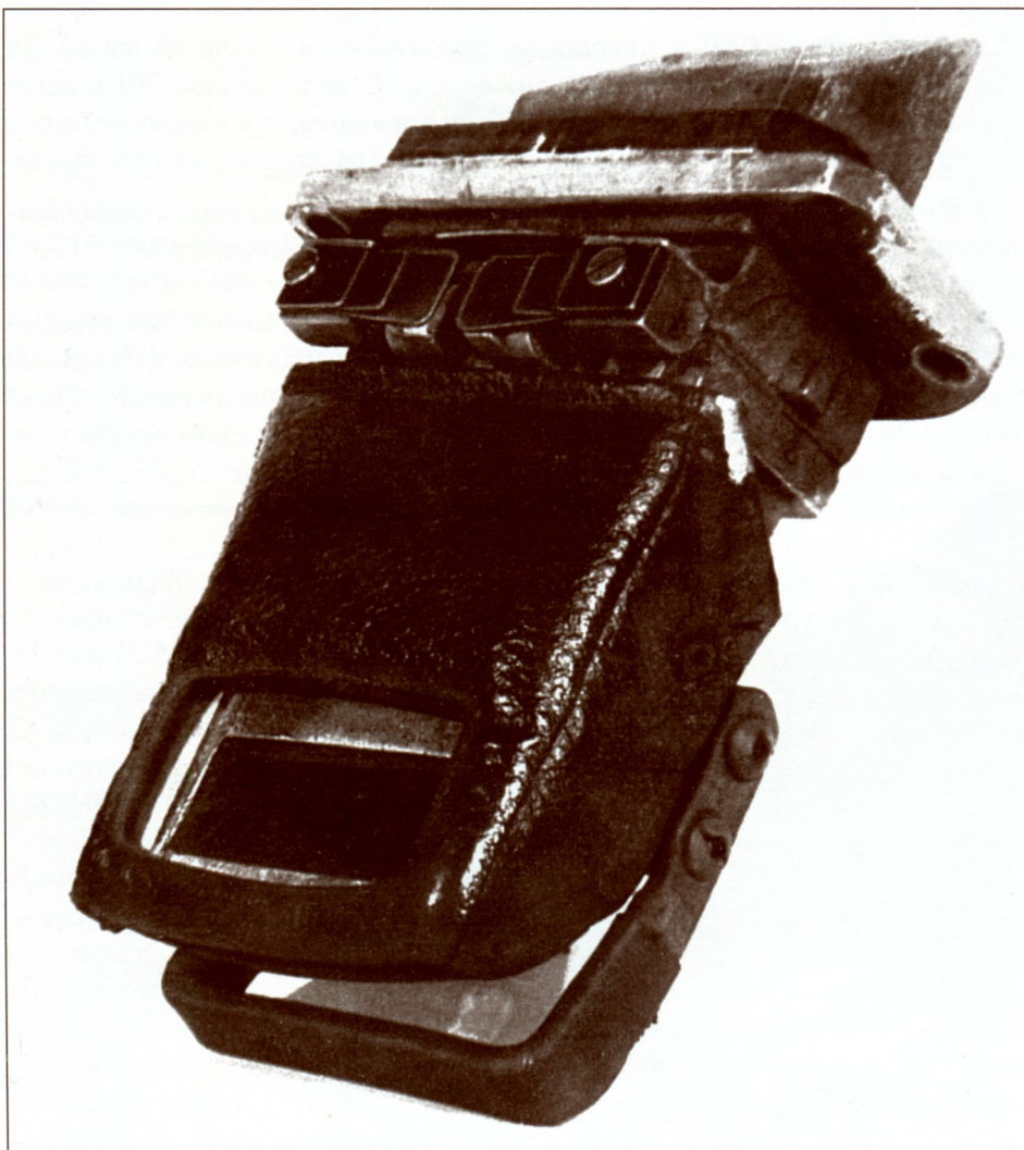
Перископический смотровой прибор МК-4 танка «объект 701» № 5 (ЦАМО)
