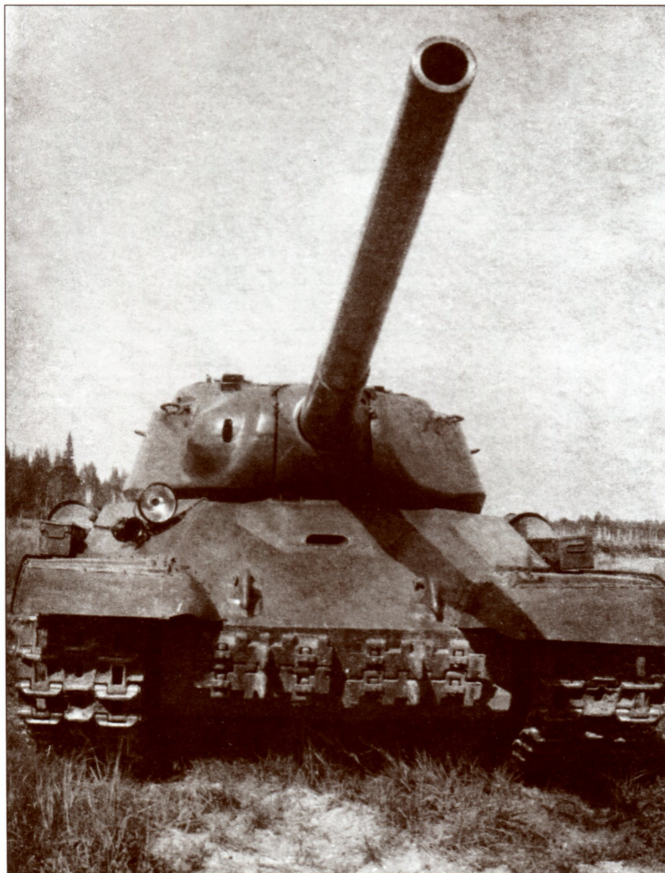
Танк «объект 701» № 0 на полигоне во время испытаний 122-мм пушки С-34, вид спереди. Лето 1944 года (АСКМ)
