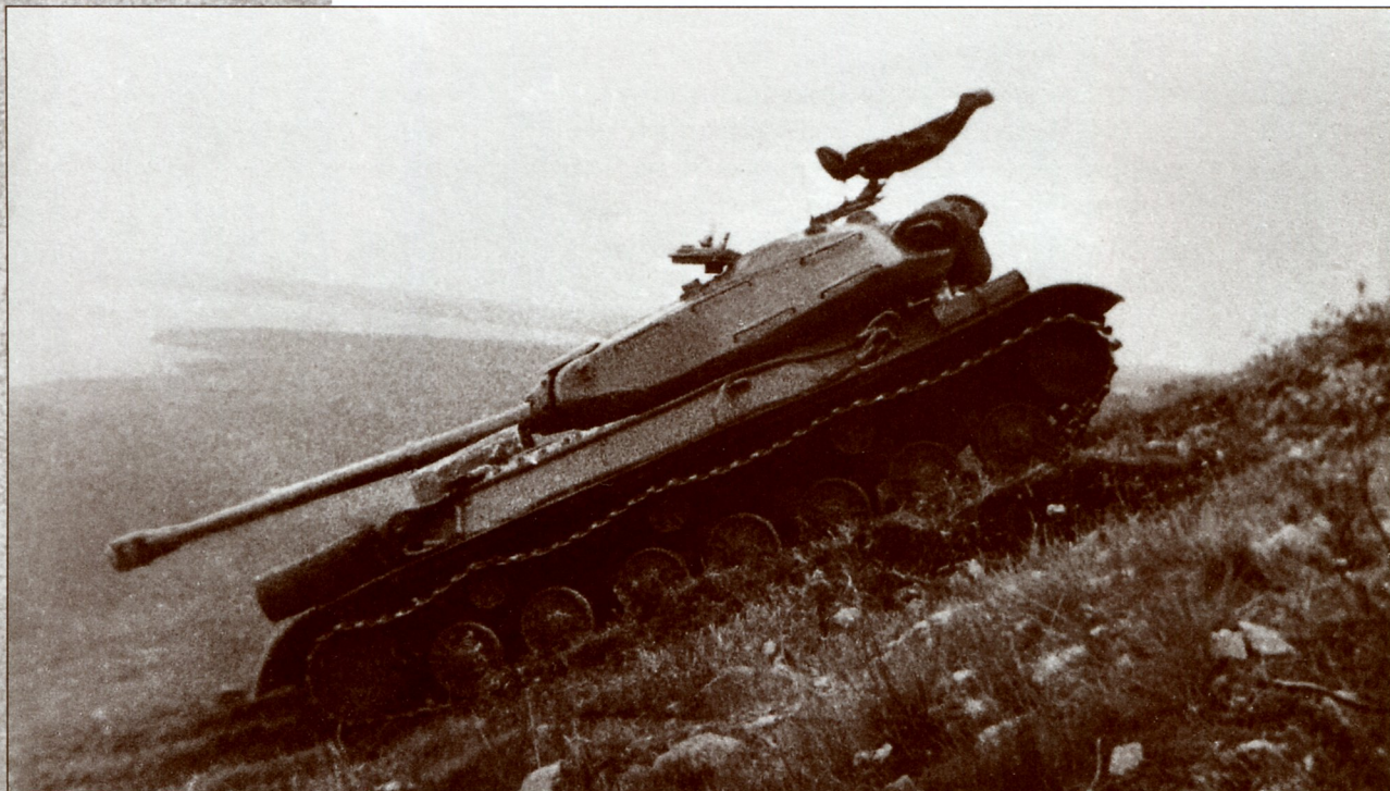
Серийный танк ИС-4 во время проведения министерских испытаний – машина преодолевает подъем крутизной 27 градусов. Весна-лето 1947 года (РГАЭ)
