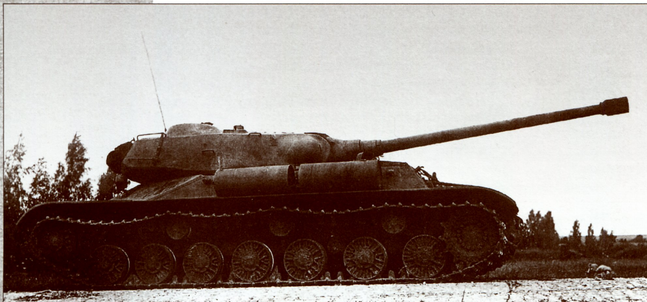
Танк «объект 701» № 2, вид слева. Лето 1944 года. Башня в походном положении, на надгусеничной полке видно крепление двух дополнительных топливных баков (РГАЭ)
