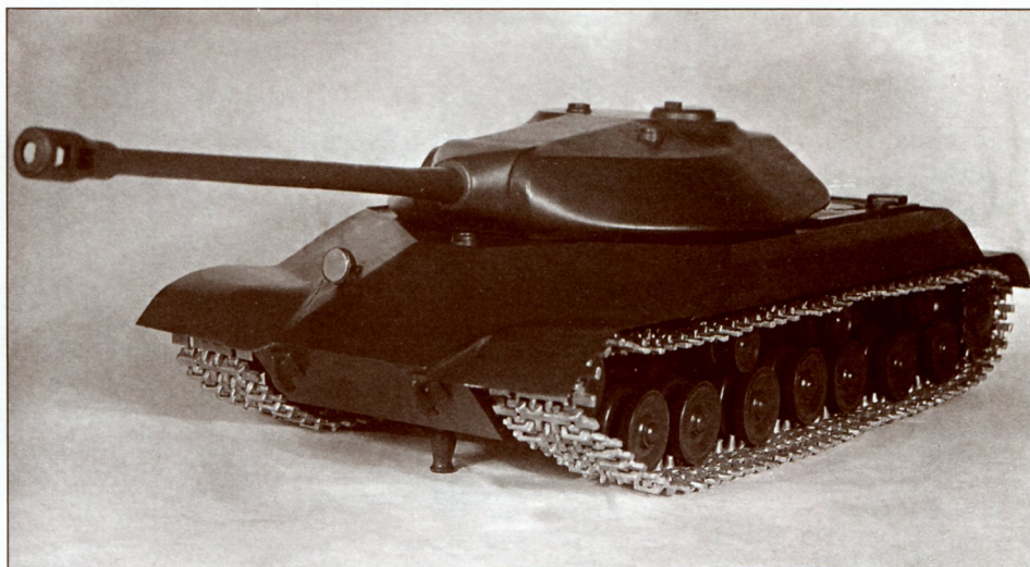
Тот же макет, вид в изометрии. Хорошо видно, что на этом этапе смотровой прибор механика-водителя на верхнем лобовом листе корпуса отсутствовал (КК)
