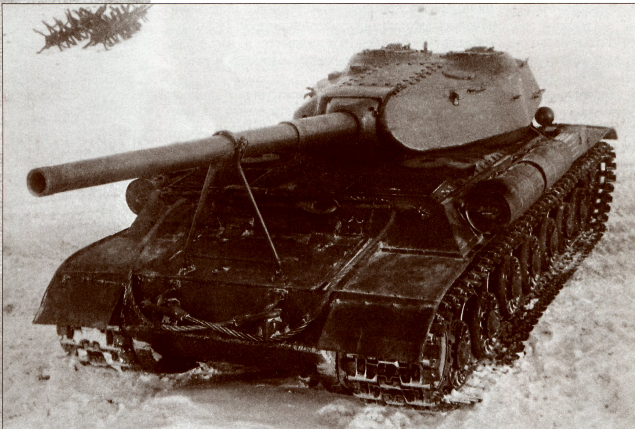
Танк «объект 701» № 5, вид сзади-справа. НИБТ полигон. Декабрь 1944 года. Башня в походном положении, хорошо виден упор для фиксации ствола орудия (ЦАМО)
