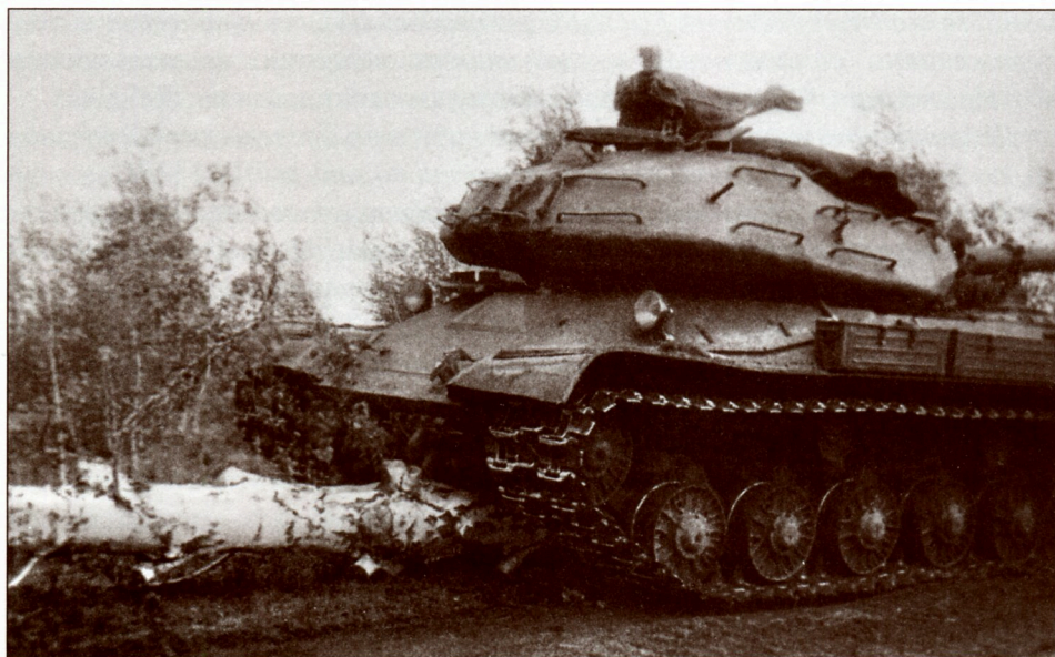
Серийный танк ИС-4 свалил березу диаметром 520 мм в ходе проведения министерских испытаний. Весна-лето 1947 года (РГАЭ)
