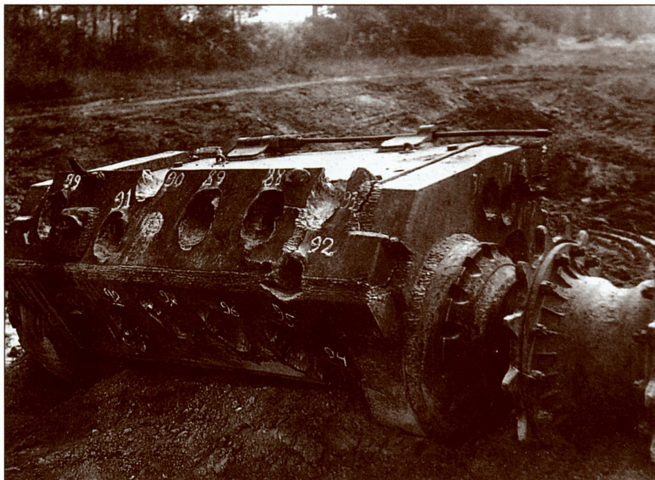
Неразрушенные соединения задних бортов с кормой и средней кормовой детали с нижней после сосредоточенного обстрела 75-мм и 88-мм бронебойными снарядами. Август 1944 года (ЦАМО)
