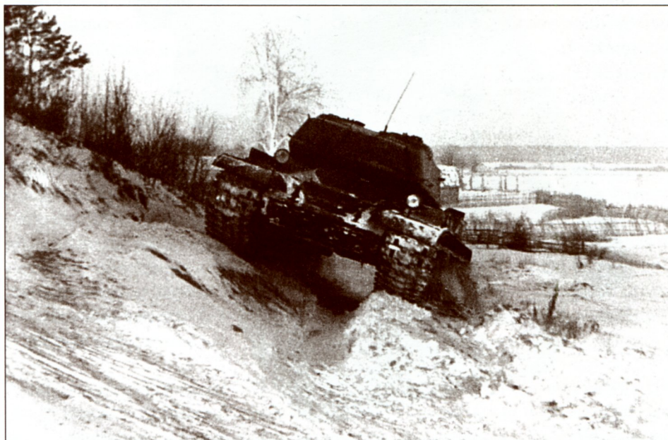
Танк «объект 701» № 5 преодолевают косо- крутизную в 17 градусов. НИИТ полигон. Зима 1944/45 года (ЦАМО)
