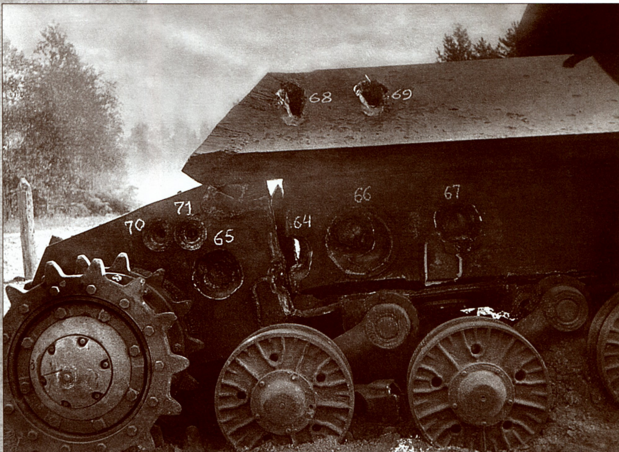
В результате обстрела кормовая часть корпуса отделилась по разрушенным стыковым швам бортов. Август 1944 года (ЦАМО)
