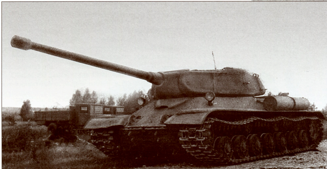
Общий вид танка «объект 701» № 2. Лето 1944 года. Машина вооружена 100-мм пушкой С-34-І (РГАЭ)
