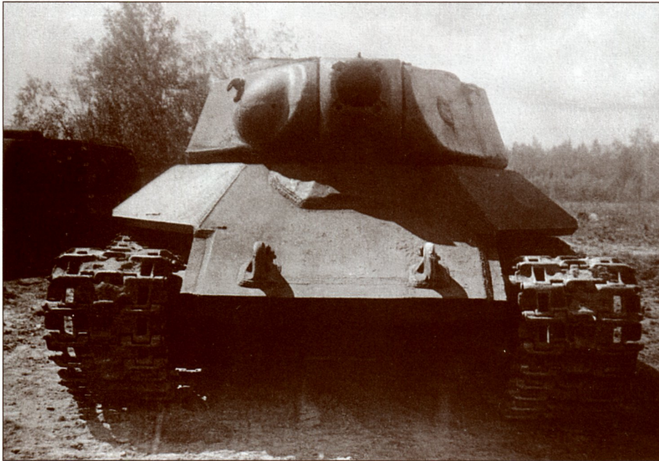
Бронекорпус с башней танка «объект 701» (вариант № 3) перед испытанием обстрелом, вид спереди. Август 1944 года (ЦАМО)
