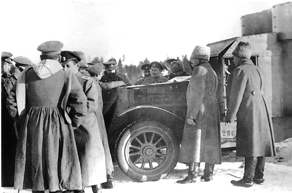
Русские офицеры осматривают броневомобиль «Остин» 2-й серии на полигоне Офицерской стрелковой школы. Осень 1915 года. Виден 4-цилиндровый двигатель мощностью 50 л.с., а также заводской номер 286, нанесенный на нижней части бронирования (ВИМАИВВС).
