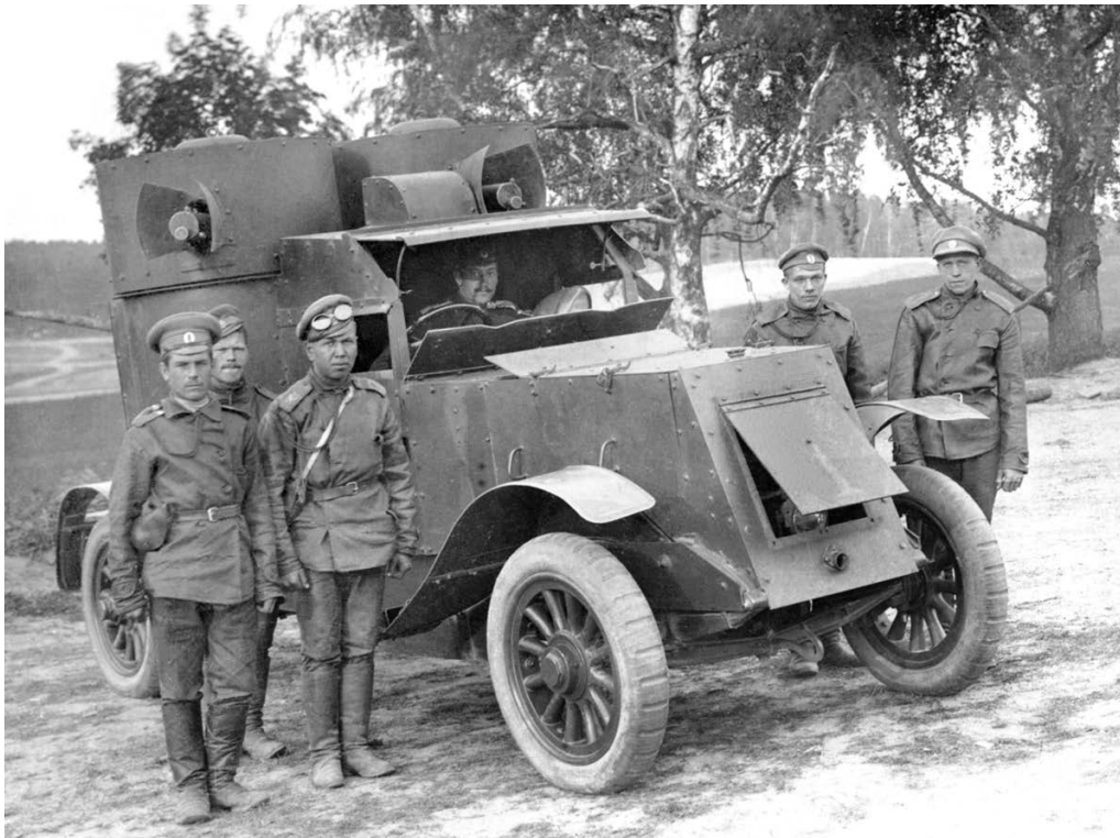
Бронеавтомобиль «Остин» 2-й серии («Кречет» или «Кондор») из состава 39-го автопулеметного взвода. Западный фронт, лето 1916 года. На бронелисте перед радиатором нанесена цифра 1, хорошо видны фары за приоткрытым листом перед радиатором и справа от водителя. Обратите внимание на крюк для буксировки машины, смонтированный на передней оси броневики (из архива Александра Ефремовича Савичева).
