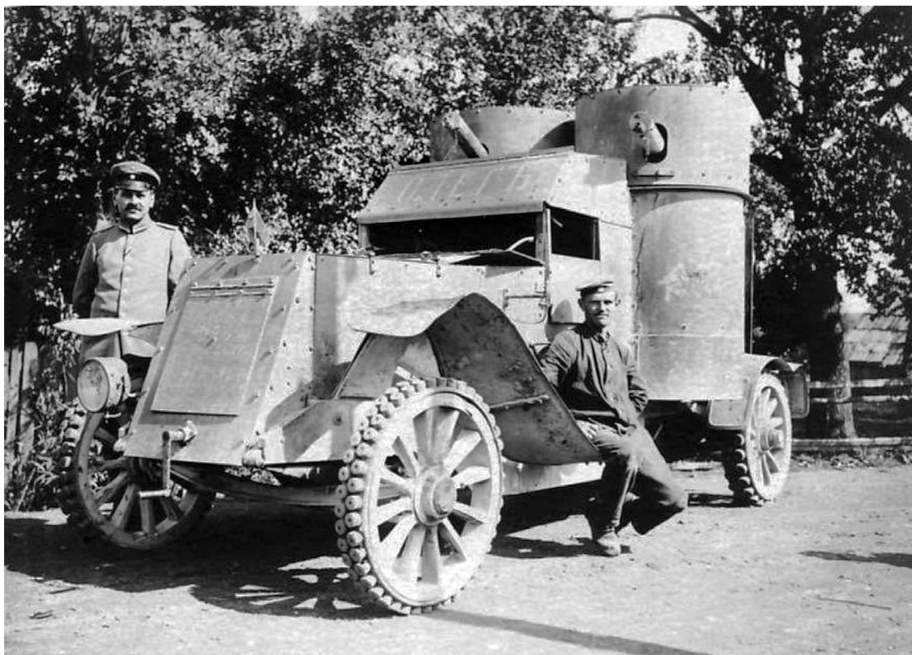
Бронеавтомобиль «Остин» 2-й серии «Олег», захваченный немцами. Лето 1917 года. Машина из состава 36-го автопулеметного отделения, бронезащита пулеметов отсутствует, установлены колеса с «пупырчатыми» шинами английской фирмы К. Т. (фото из архива С. Кирильца).
