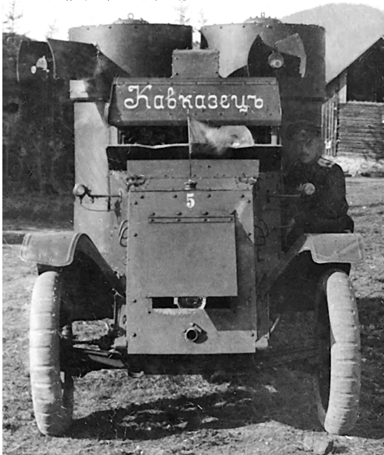
Бронеавтомобиль «Остин» 2-й серии «Кавказец» из состава 46-го автопулеметного отделения русской армии, вид спереди. Юго-Западный фронт, октябрь 1916 года. (РГАКФД).
