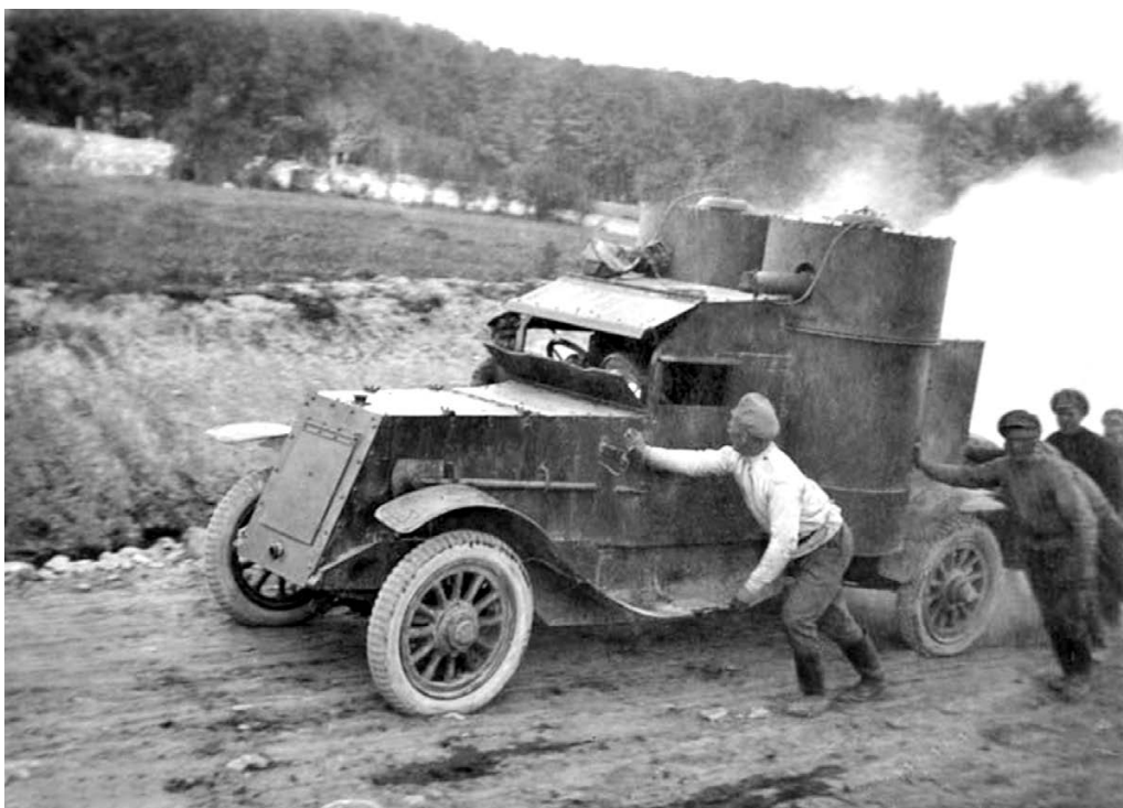
Солдаты помогают броневомобилю «Остин» 2-й серии «Олег» из состава 36-го автопулеметного взвода, подняться по крутой дороге. 1916 год. Броневая защита пулеметов отсутствует. На борту закреплена лопата, на башнях видны шланги дополнительных баков для охлаждения стволов пулеметов при стрельбе (из коллекции С. Кирильца).
