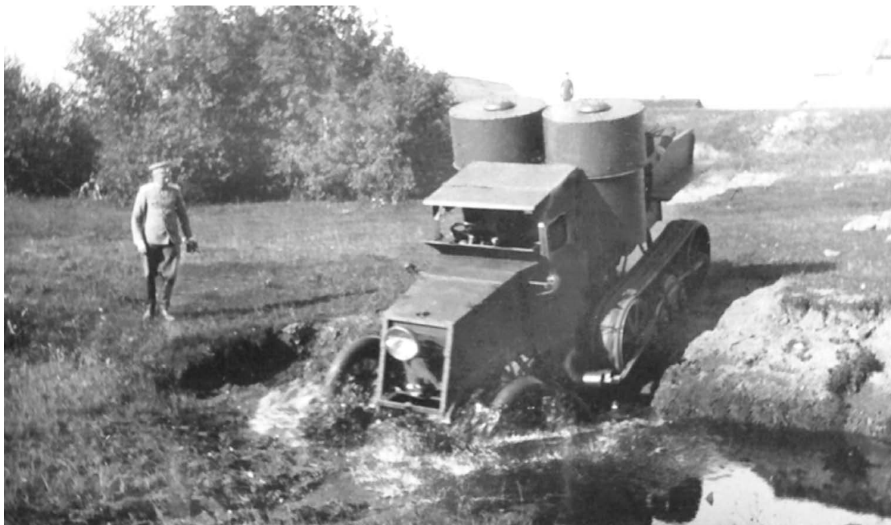
Демонстрация первого образца бронеавтомобиля «Остин» 2-й серии с приспособлением Кегресса Николаю II и великому князю Николаю Николаевичу в районе Могилева. Лето 1916 года. Броневик оснащен кузовом с сиденьями в кормовой части корпуса, конструкция двигателя отличается от устанавливаемых на серийных броневиках (ГАРФ).
