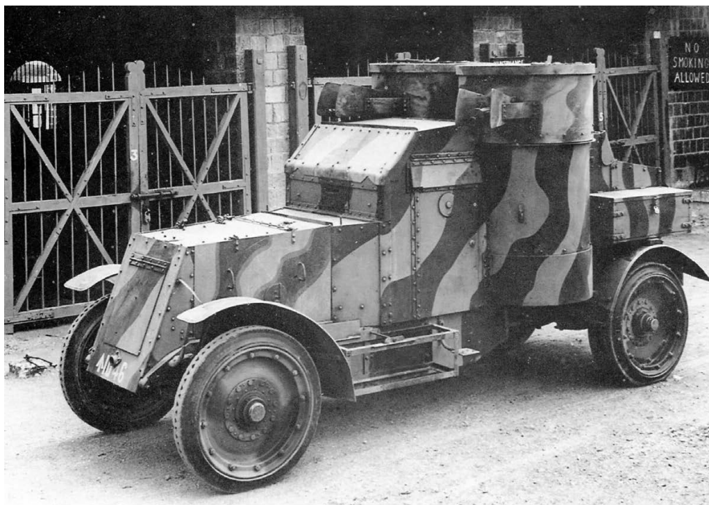
«Остин» 4-й серии из числа броневиков, направленных на службу в Индию. Предположительно 1921 год. Броневик оснащен новыми колесами с шинами из губчатой резины (RAS Tank museum).
