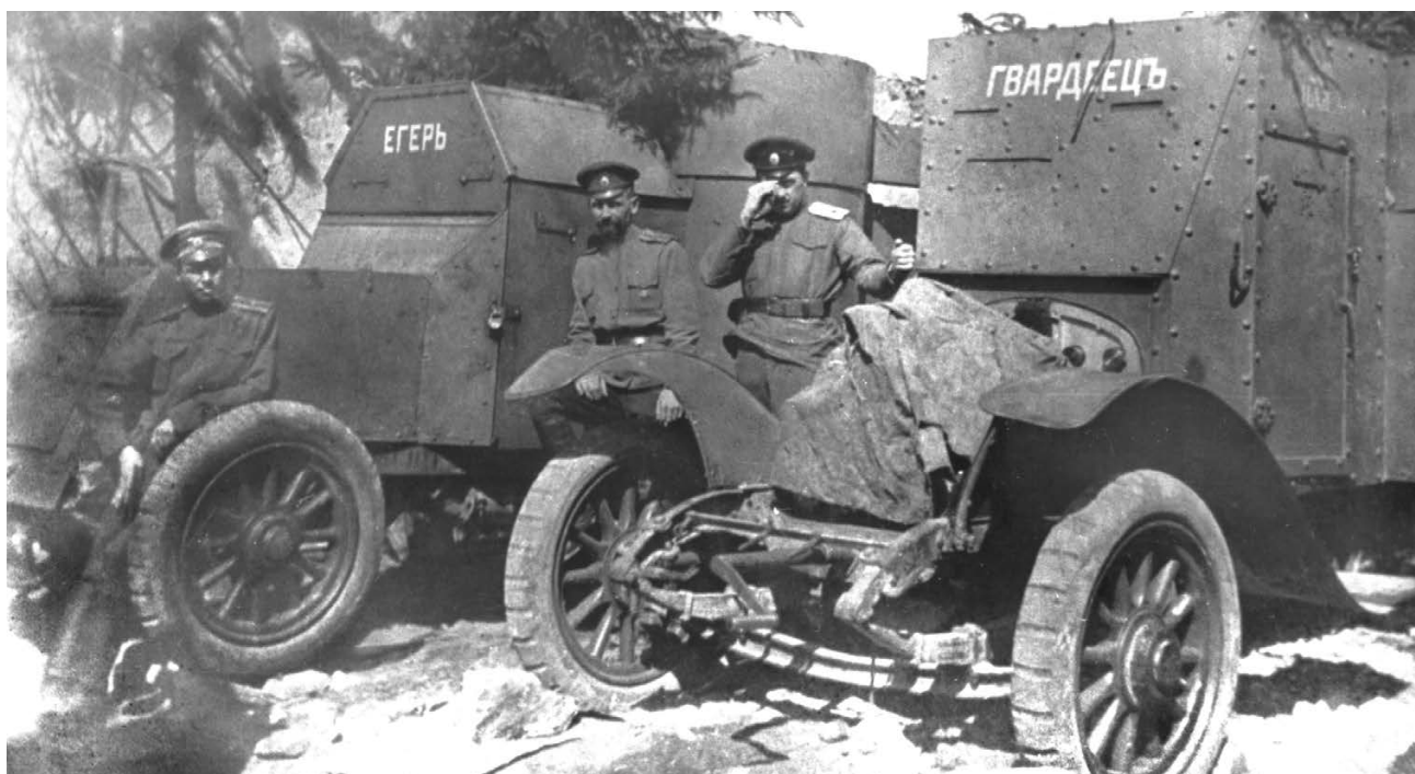
Бронеавтомобили «Остин» 1-й серии «Егерь» и «Гвардеец» 22-го автопулеметного взвода. 1916 год «Егерь» имеет измененную бронировку передней части корпуса и переделанную дверь для посадки экипажа, а на «Гвардейце» передняя часть бронекорпуса изменена полностью (АСКМ).
