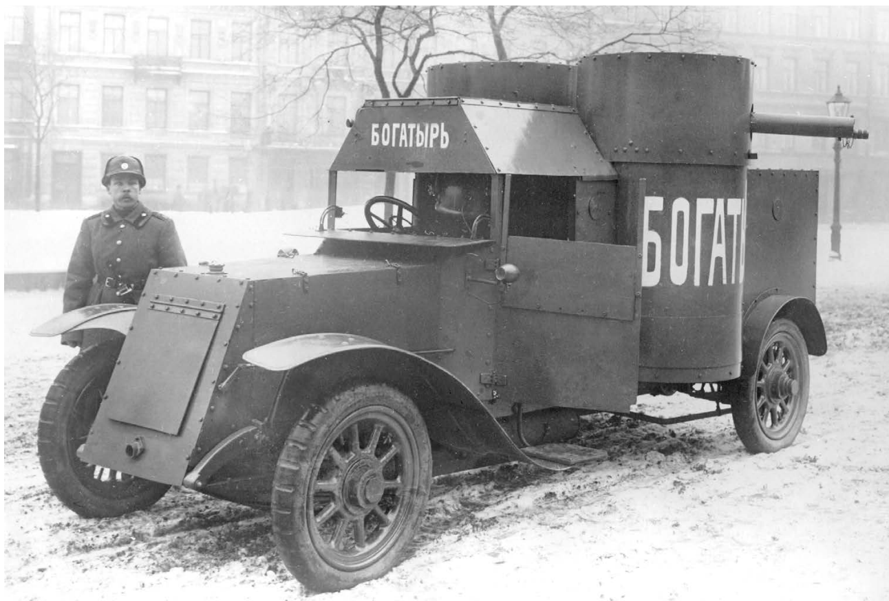
Броневик «Остин» 1-й серии «Богатырь» 6-го автопулеметного взвода на площади перед Михайловским манежем. Петроград, декабрь 1914 года. Через открытые задние дверцы видны ящики вдоль бортов для укладки коробок с лентами для пулемета Максим (ЦГАКФД СПБ).
