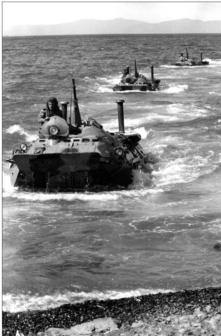
Бронетранспортеры морской пехоты. Тихоокеанский флот, октябрь 1995 года. Трубы воздухозаборника двигателя (левая) и воздухозаборника ФВУ (правая) выдвинуты в положение для работы на плаву
