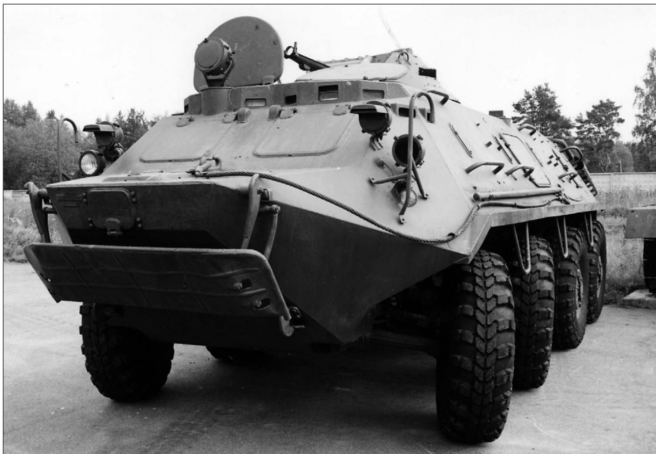
Опытный образец бронетранспортера БТР-60ПЗ. В положении по-походному волноотражательный щиток прижимался к нижнему лобовому листу корпуса. Над щитком — лючок для выдачи троса лебедки
