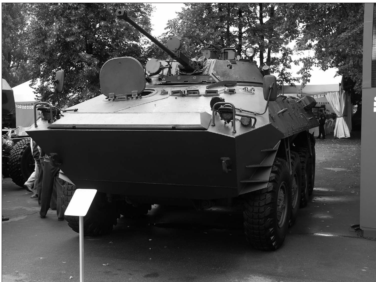
Последний вариант БТР-90. На машине установлена стандартная башня БМП-2. БТР оснащен дополнительной накладной броней. Москва, 2006 год
