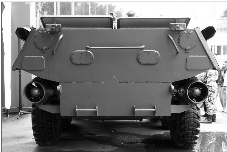
На последнем варианте БТР-90 установлены водометы нового типа
