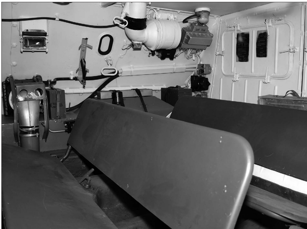
Десантное отделение. На стенке правого борта вверху - фильтровентиляционная установка
