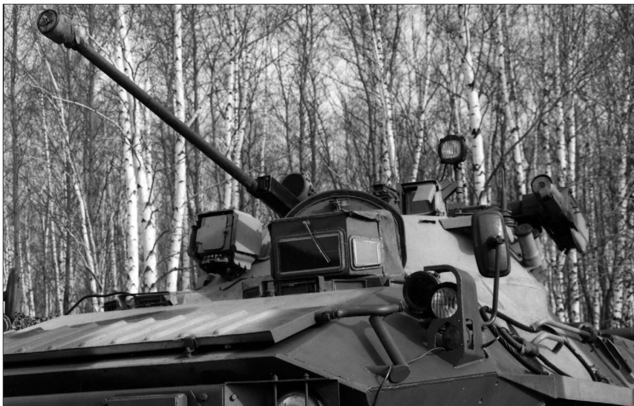
Над боевым отделением БТР-90 установлена башня, заимствованная у боевой машины пехоты БМП-2, с полным комплектом вооружения
