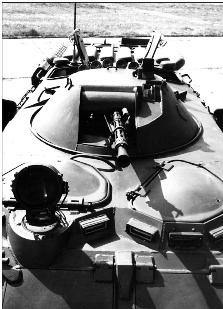
Вид спереди на башенную пулеметную установку БПУ-1. Справа от маск-установки пулеметов — амбразура прицела 1ПЗ-2 с откинутой вверх броневой крышкой. На переднем плане, перед люком командира, установлен прибор наблюдения ТКН-3 с осветителем ОУ-ЗГА2М
