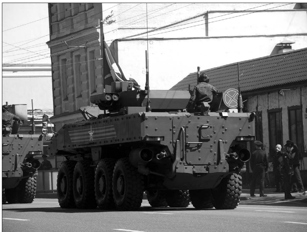
«Бумеранг» возвращается с Красной площади после репетиции. Хорошо видны дверь и откидная аппарель в кормовом листе корпуса
