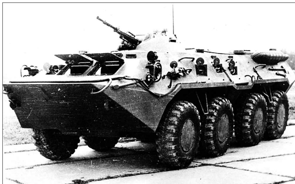
БТР-80 раннего выпуска. Волноотражательный щит — такой же, как у БТР-70. Ограждение фар на более поздних машинах было заменено
