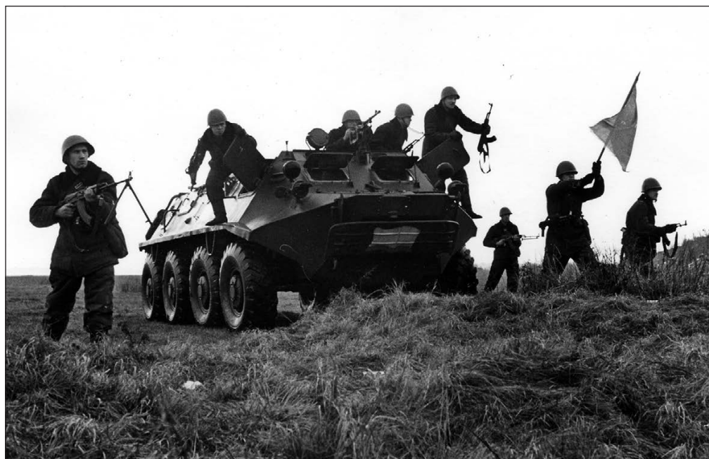
Бронетранспортер БТР-60П морской пехоты ВМФ СССР. Январь 1969 года. Десантное отделение машины закрыто брезентом. Штатный пулемет СГМБ установлен на носовом шкворне. На правом борту машины виден бортовой шкворень, еще один установлен на левом борту
