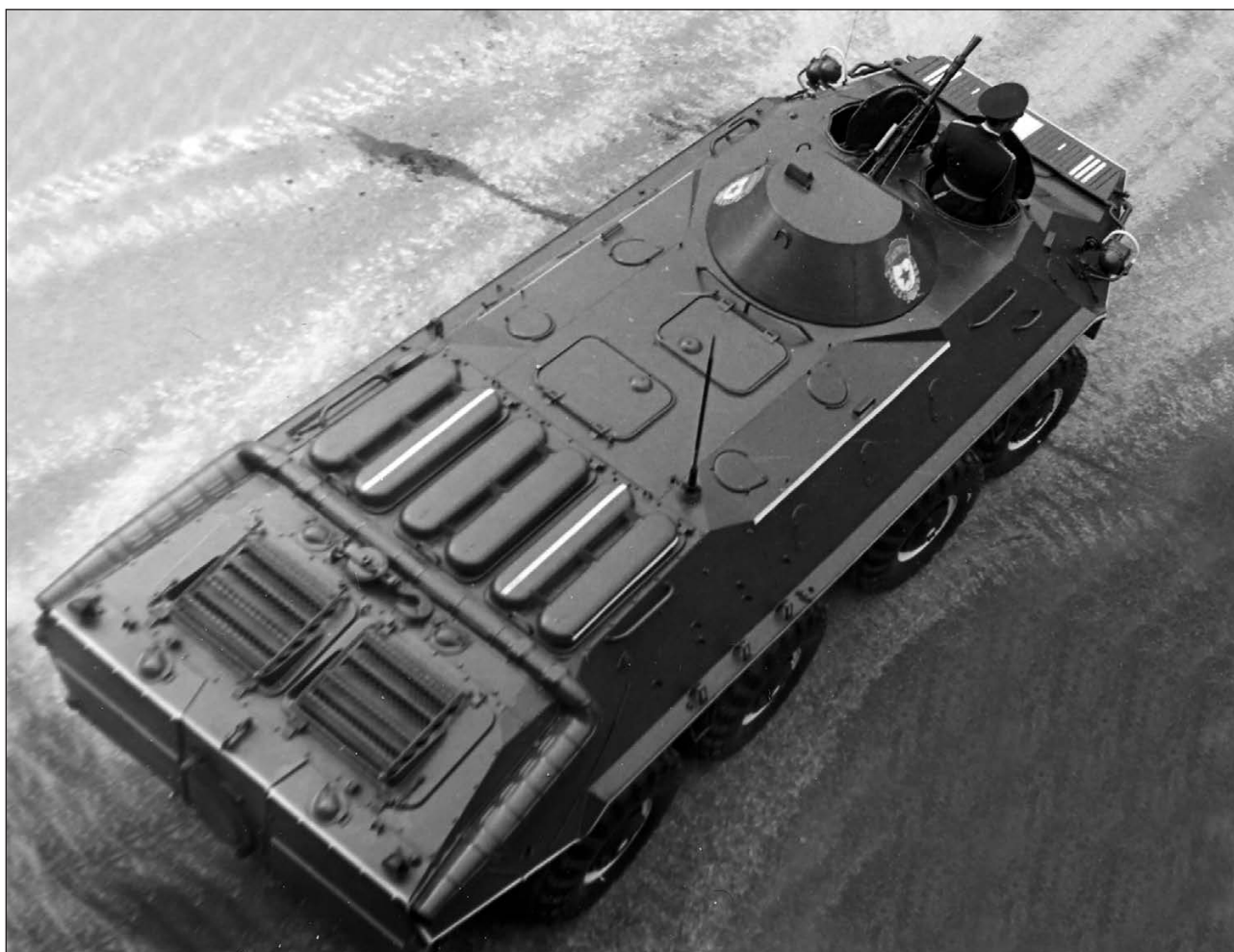
БТР-70, вид сверху. На снимке хорошо просматриваются основные отличия показанных 9 мая 1985 года боевых машин: двойные поручни в передней части корпуса, смотровой прибор ТНП-205 в боковой стенке башни и амбразуры для зенитной стрельбы в крыше корпуса
