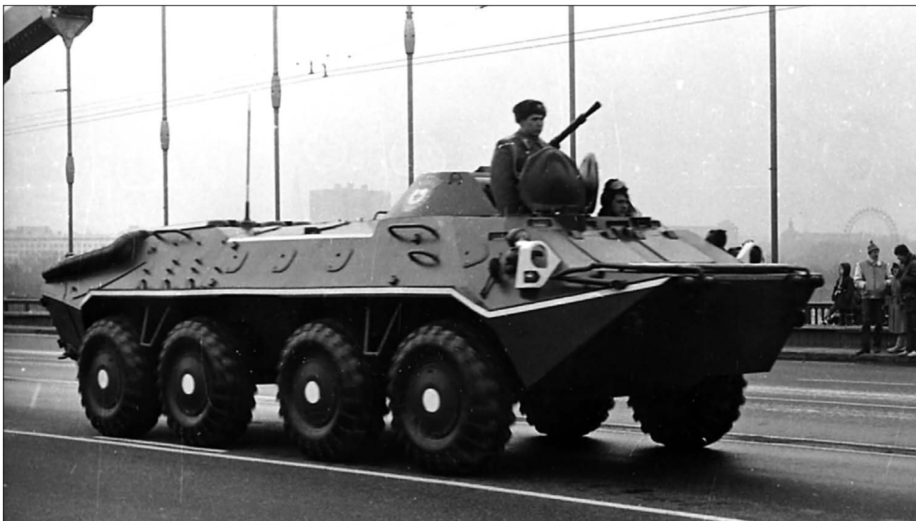
Отличительными особенностями бронетранспортеров — участников московского парада 7 ноября 1986 года стали: башенная пулеметная установка ПБУ-1; новый волноотражательный щиток и ограждения фар
