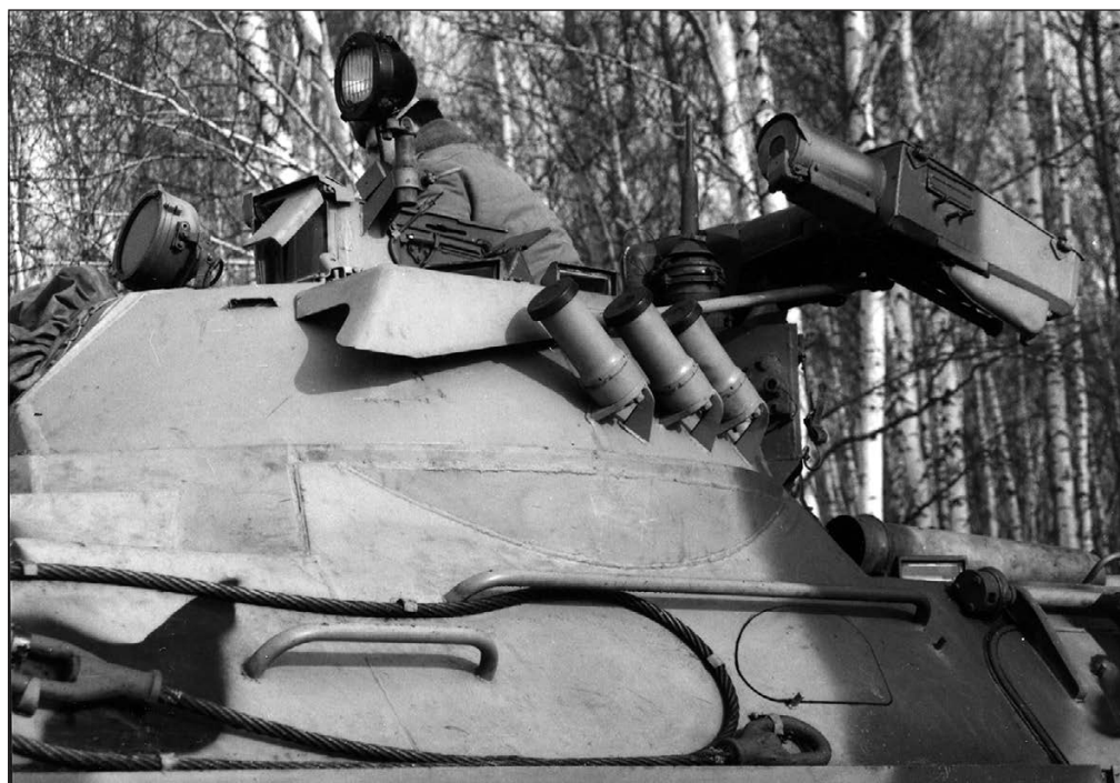
Над боевым отделением БТР-90 установлена башня, заимствованная у боевой машины пехоты БМП-2, с полным комплектом вооружения
