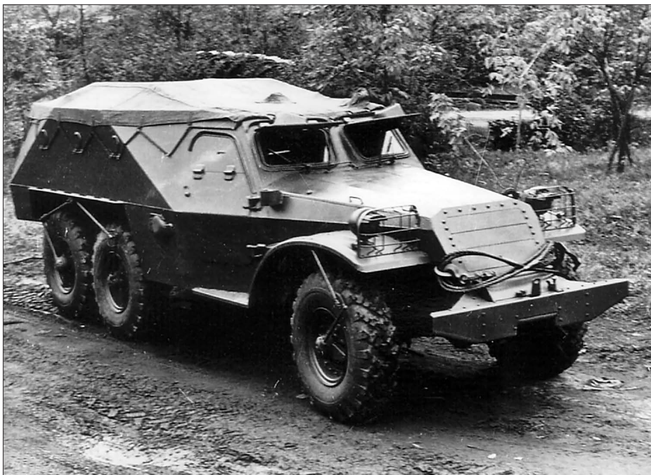
Бронетранспортер БТР-152В с центра- лизованной систе- мой регулирования давления воздуха в шинах с внешним подводом
