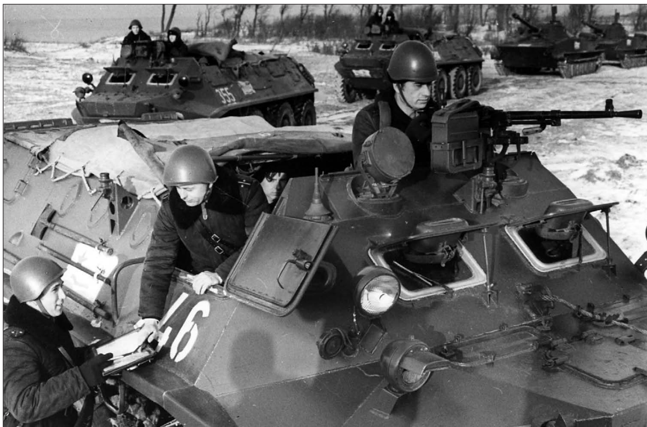
Бронетранспортер БТР-60П морской пехоты ВМФ СССР. Январь 1969 года. Десантное отделение машины закрыто брезентом. Штатный пулемет СГМБ установлен на носовом шкворне. На правом борту машины виден бортовой шкворень, еще один установлен на левом борту
