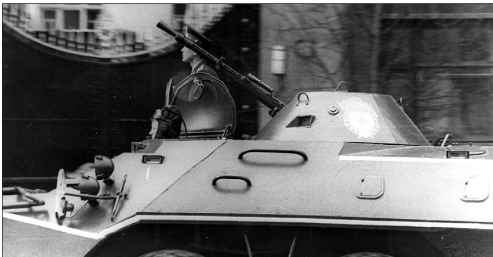
БТР-70 крупным планом. 9 мая 1985 года. Хорошо видны двойные поручни в передней части корпуса, смотровой прибор ТНП-205 в боковой стенке башни
