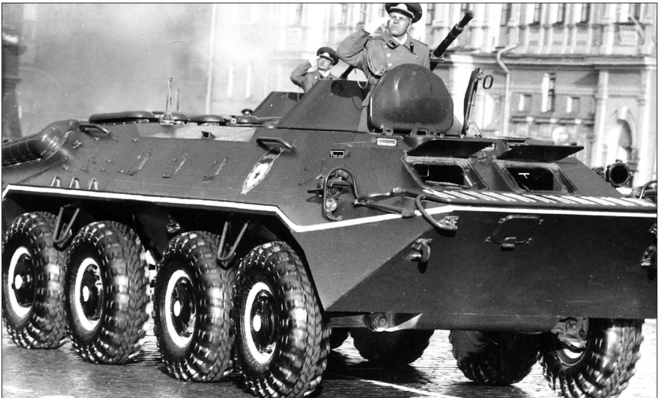
БТР-70 впервые участвовал в параде на Красной площади 7 ноября 1980 года. Это тоже машины сравнительно раннего выпуска, но приборы ТНПТ-1 на их башнях уже есть. На фото они, правда, не просматриваются, но зато хорошо видно отсутствие амбразур в крыше корпуса
