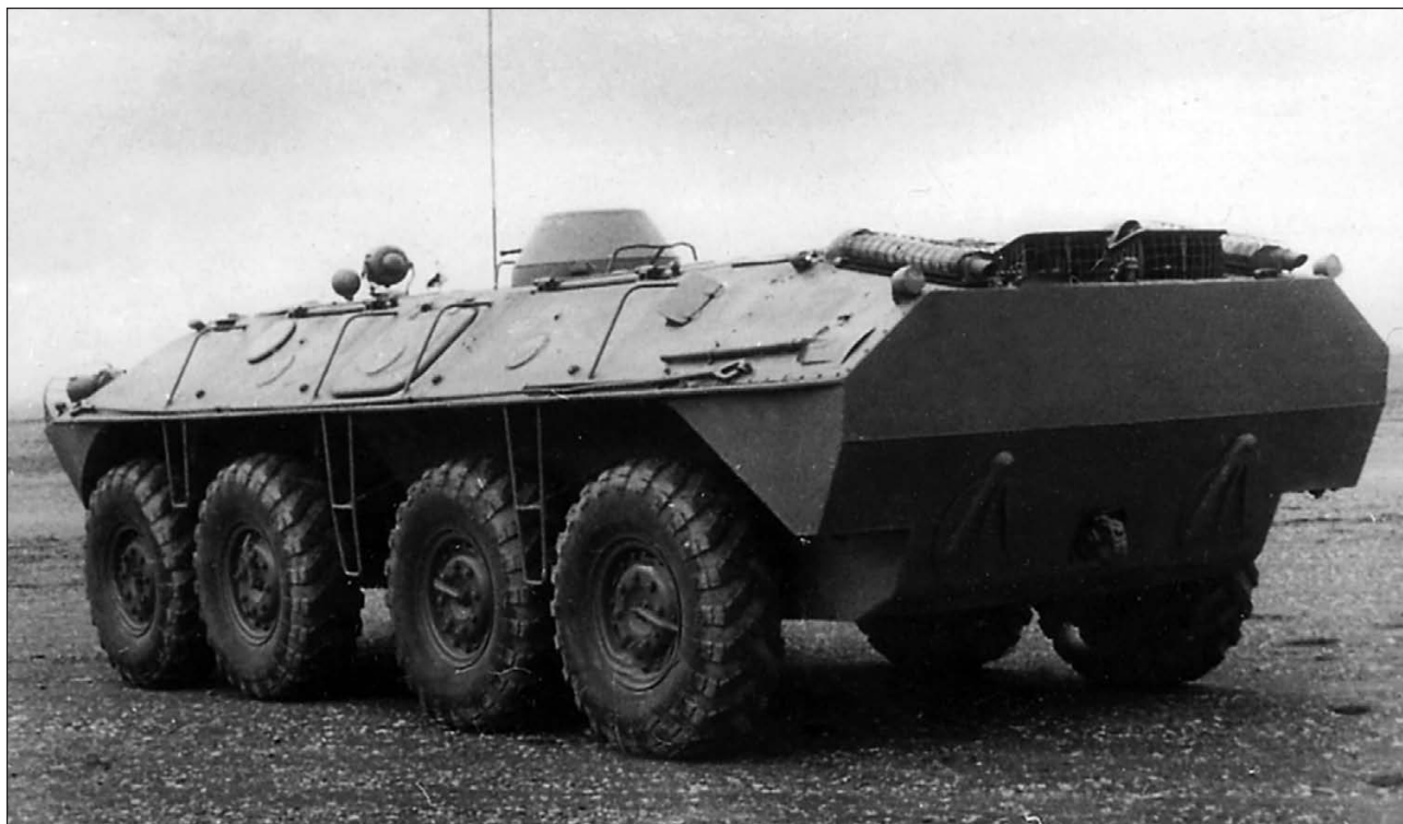
Бронетранспортер «1015-Б». Хорошо видны заслонки водометов на нижнем кормовом листе корпуса
