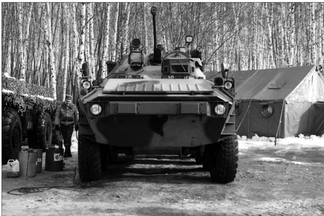
Доработанный вариант БТР-90 на выставке военной автомобильной техники в 21 НИИ МО РФ. Бронницы, 2001 год. Обращает на себя внимание бампер с фарами на нижнем лобовом листе корпуса машины
