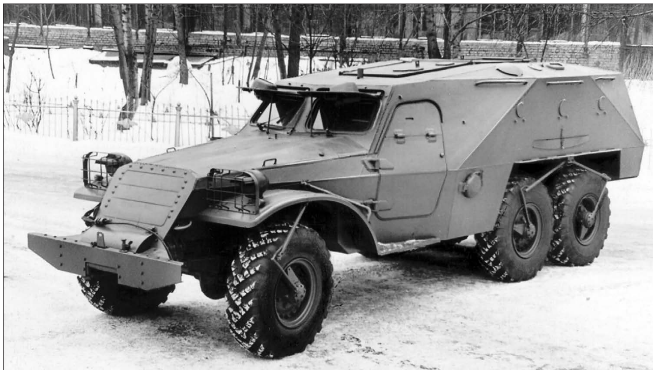
Прототип бронетранспортера БТР-152К. Судя по скобам на борту корпуса, предназначенным для крепления тента, эта машина просто переделана из серийного БТР-152В
