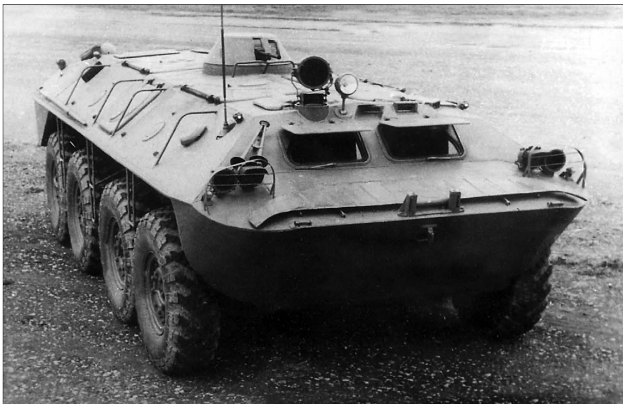
Опытный образец бронетранспортера «1015-Б» Кутаисского автозавода. Хорошо видна ложкообразная форма нижней носовой части корпуса
