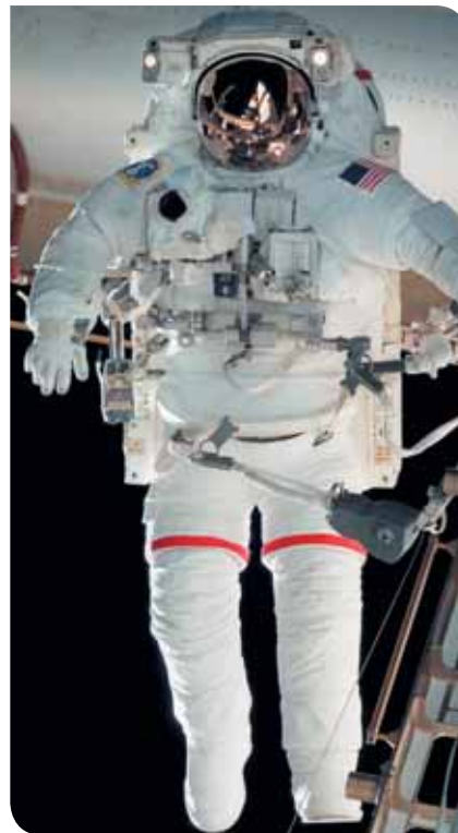
Скафандр для выхода в открытый космос, используемый на МКС.
