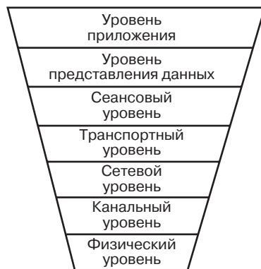
Рис. 2.1. Модель OSI – теоретическая основа для описания процесса передачи данных
