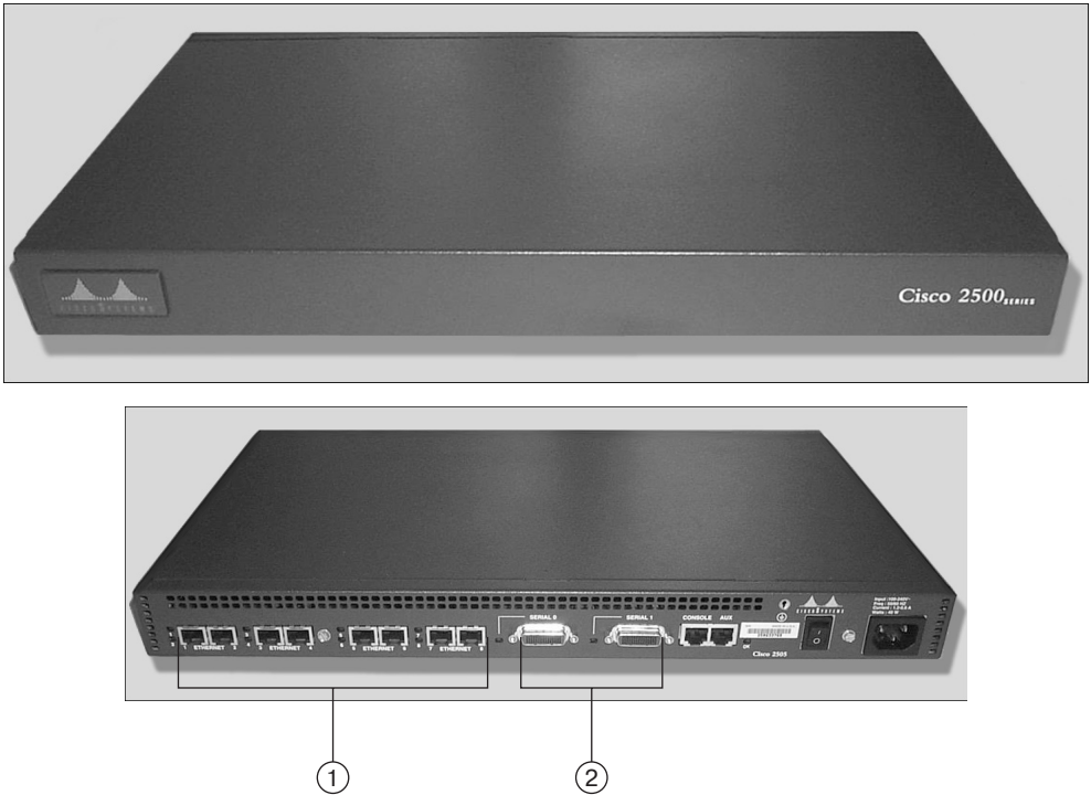
Рис. 7.1. Маршрутизатор Cisco 2505 связывает локальные сети через последовательный интерфейс: 1 – концентратор портов Ethernet; 2 – порты последовательного соединения
