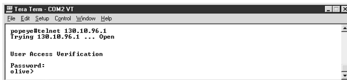
Рис. 11.16. Для подсоединения к другому маршрутизатору служит протокол Telnet
