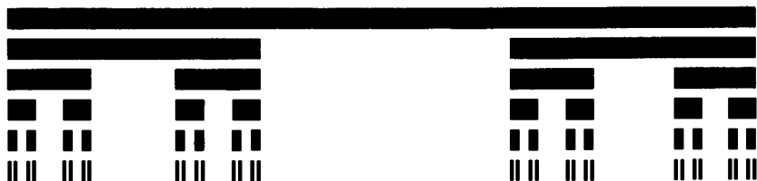
РИС. 5.1. Построение триадного канторовского множества. Затравка – единичный отрезок [0, 1] . Образующий элемент удаляет среднюю треть. На рисунке показаны первые пять поколений. D = \ln 2 / \ln 3 = 0,6309 .
