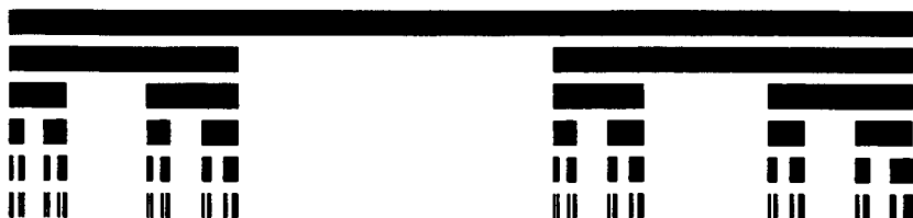
РИС. 5.3. Построение двухмасштабного канторовского стержня с l_1 = 1/4 и l_2 = 2/5 . Фрактальная размерность такого канторовского множества D = 0,6110 .
