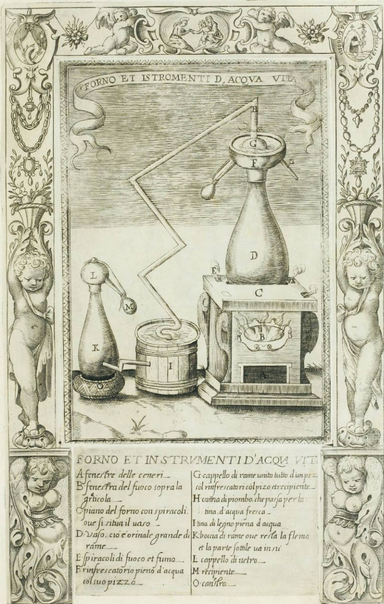
«Печь и оборудование для получения aqua vitae»
