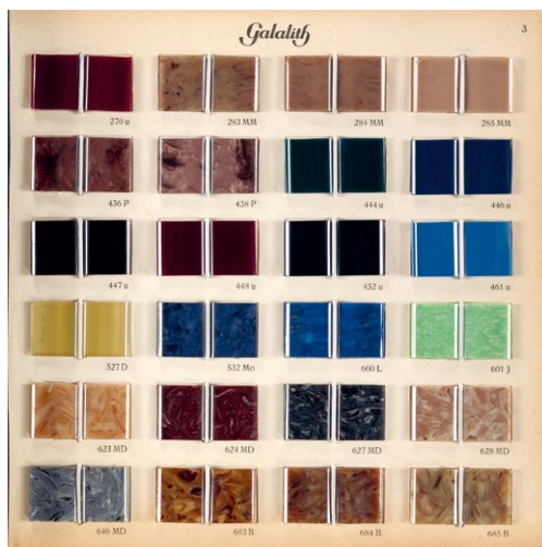
Каталог образцов галалита — прообраза пластмассы из казеина, формальдегида и красителей, Харбург-Вильгельмсбург, около 1920 года
